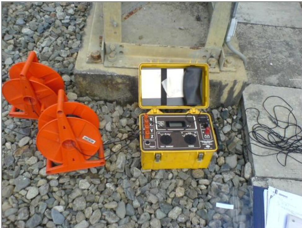
**Figura G4. Instrumento de medida AEMC 4500.**
