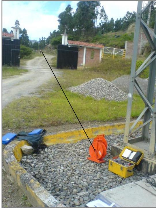
**Figura G5. Medición de la resistencia de puesta a tierra. (Método de la pendiente).**
