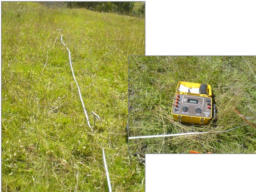
**Figura G6. Medición de la resistencia de puesta a tierra. (Método de intersección).**
