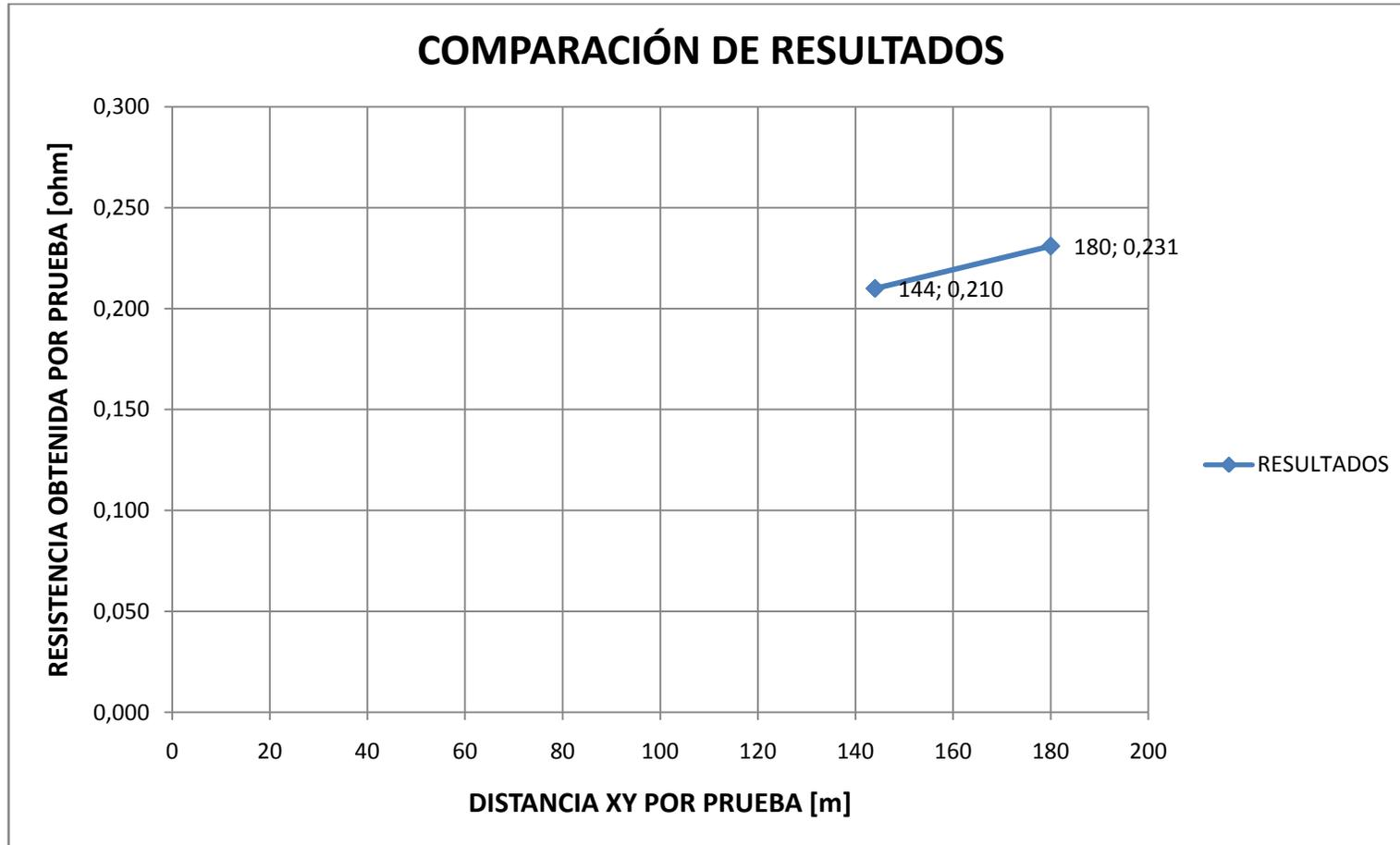
Figura 33. Resultado por prueba de la resistencia de puesta a tierra de la malla con el Método de la Pendiente. (Fuente: Autor).
