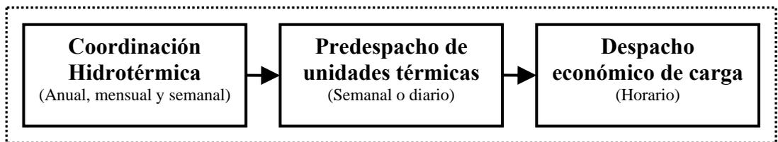
**Figura 2.1:** Descomposición jerárquica temporal de un sistema hidrotérmico.
