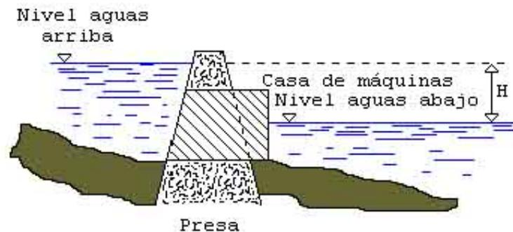
**Figura 2.8** Central hidroeléctrica de pasada
