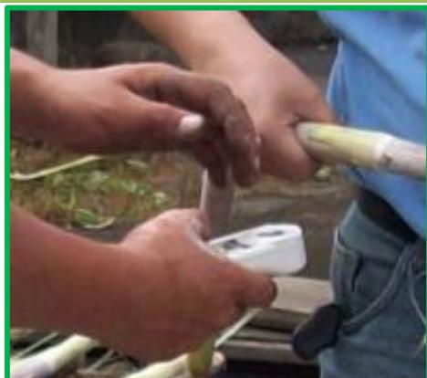
Ilustración #17. Determinación del Brix Inferior.
