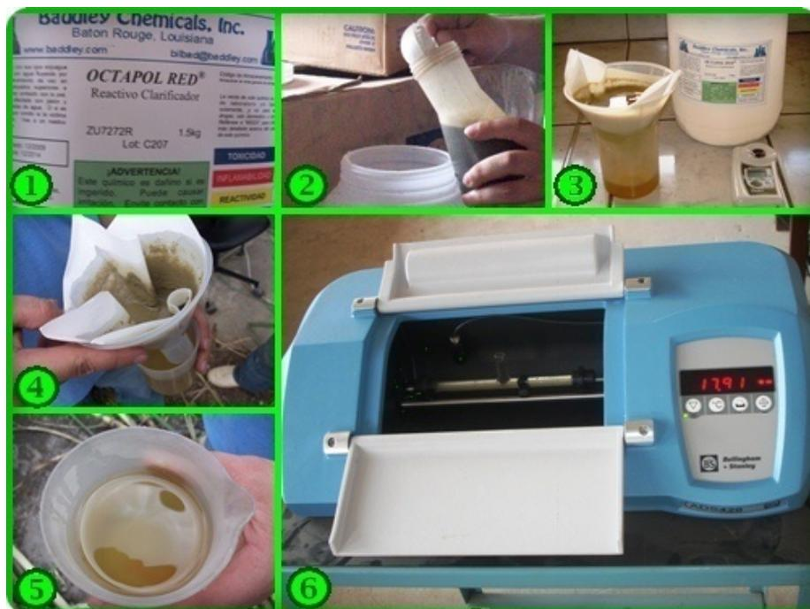
Fotografía 1.- Reactivo Químico. 2 y 3.- Clarificación del Jugo. 4.- Filtrado. 5.- Jugo clarificado. 6.- Determinación del Pol en el Polarímetro Sacarimétrico.
