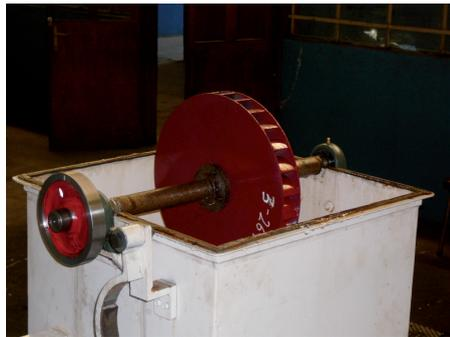
Figura. 6 a) (izq.) Banco de pruebas de ruedas hidráulicas
