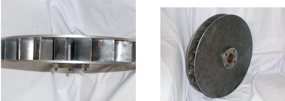
Figura. 5 Rueda Hidráulica Modelo (Diámetro 30 cm)
