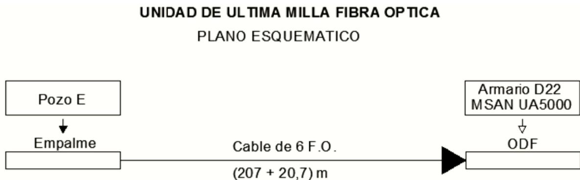
**Figura II-71. Tendido de Fibra Óptica Pozo E – Armario D22.**
