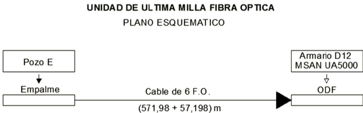
**Figura II-70. Tendido de Fibra Óptica Pozo E – Armario D12.**
