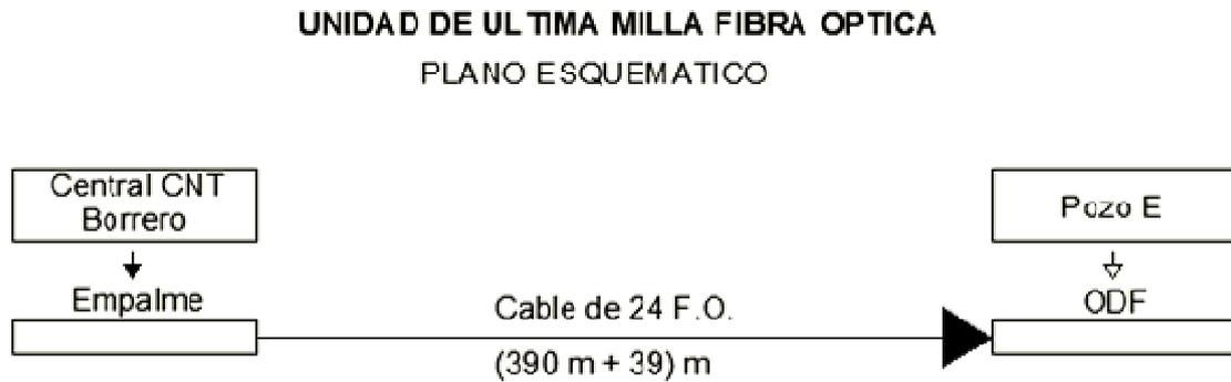
**Figura II-69. Tendido de Fibra Óptica Central Charasol - Pozo E.**
