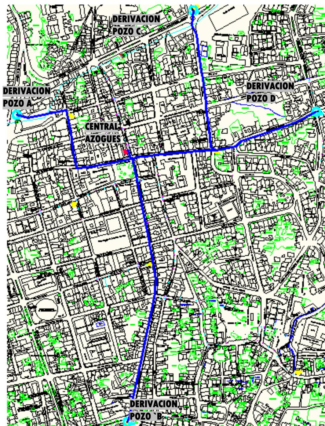
**Figura II-46. Tendido de Fibra Óptica Central Azogues – Pozos de Derivación.**
