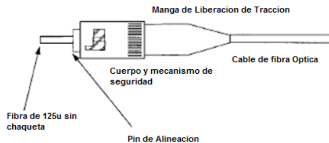
Figura [2.6] Descripción de un conector de fibra óptica
