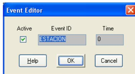
Con el fin de adicionar motores al grupo de arranque ya creado, en la opción de eventos se activa la acción adicionar, esta muestra el recuadro nombrado como “Action By Element”, en este se encuentra una opción desplegable en la cual se muestran los motores modelados para el proyecto, pudiendo seleccionar el motor que se quiere simular el arranque.
