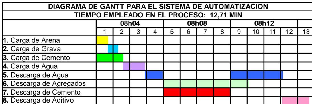
**Figura 3.8** Diagrama de Gantt para los tiempos de producción del sistema automática.
