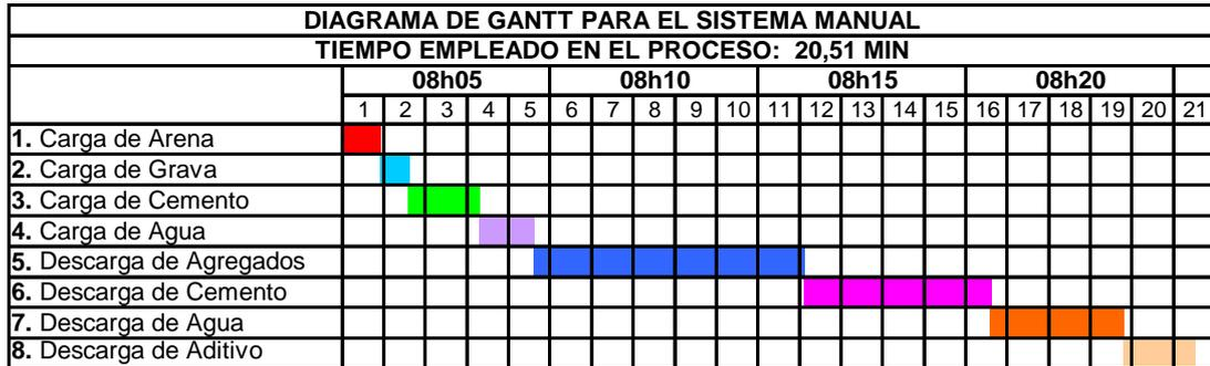
**Figura 3.7** Diagrama de Gantt para los tiempos de producción del sistema manual.
