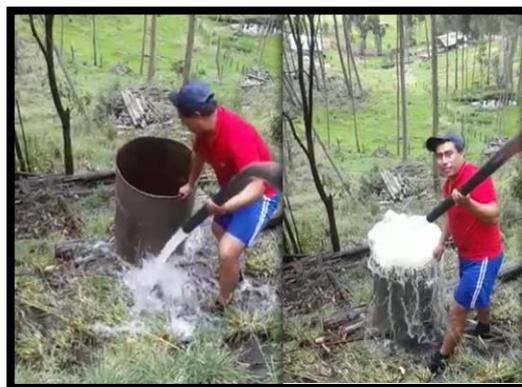
Figura 32: Medición del Caudal en la salida mediante el Método Volumétrico.
