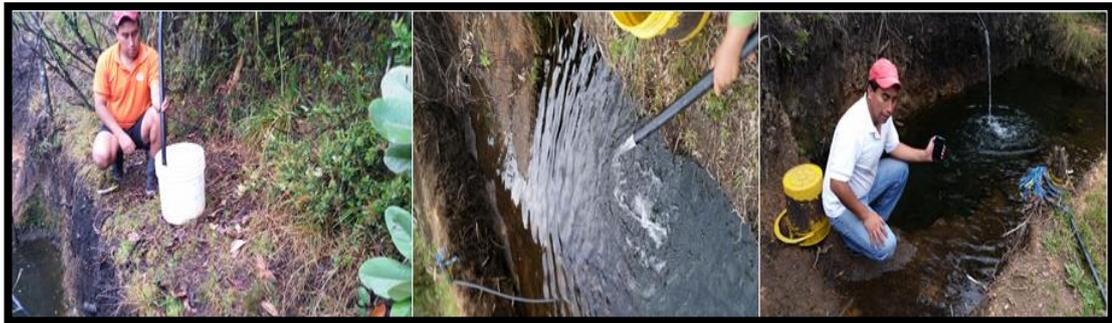
Figura 31: Medición de caudal de uno de los ingresos de agua mediante el Método del Recipiente.
