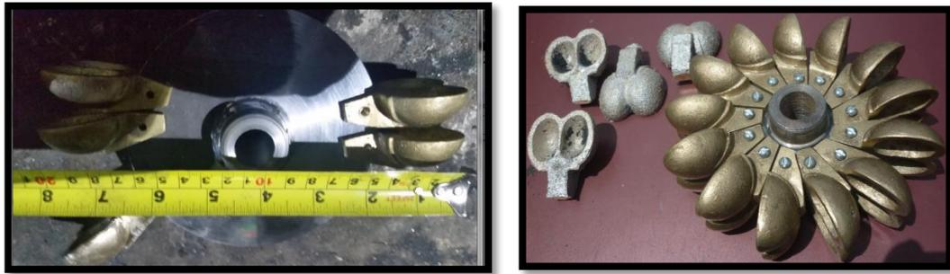
Figura 55: Ubicación del rodete, manzana, modificación por disposición y tamaño físico.
