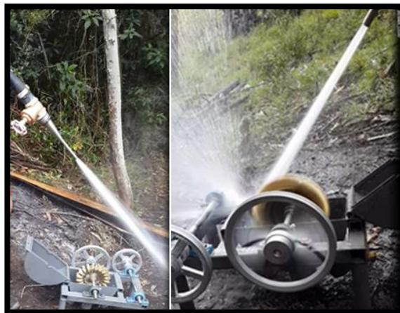
*Figura 60:* Pruebas y Medición de la velocidad en vacío de la turbina.
