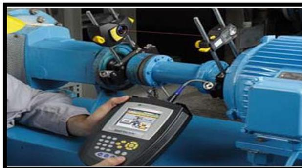
*Figura 84:* Medición de alineación y desbalancee del eje.
