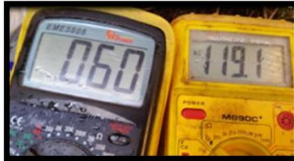
Figura 77: Medición de voltaje y frecuencia con la turbina funcionando.
