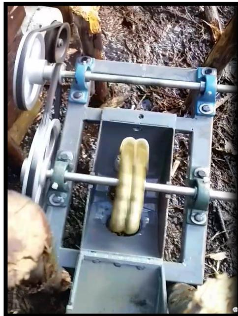
*Figura 59:* Montaje de turbina y generador para pruebas preliminares en el sitio del proyecto.
