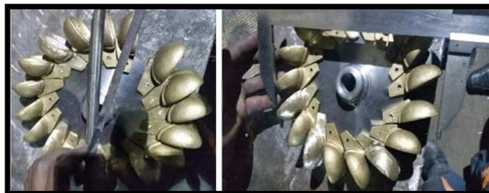
Figura 54: Disco acero inoxidable y disposición de cucharas previa su colocación.
