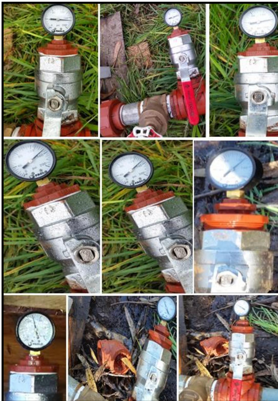
*Figura 91:* Medición de presión rango 80 a 120 PSI y 140 a 170 PSI en pruebas.
