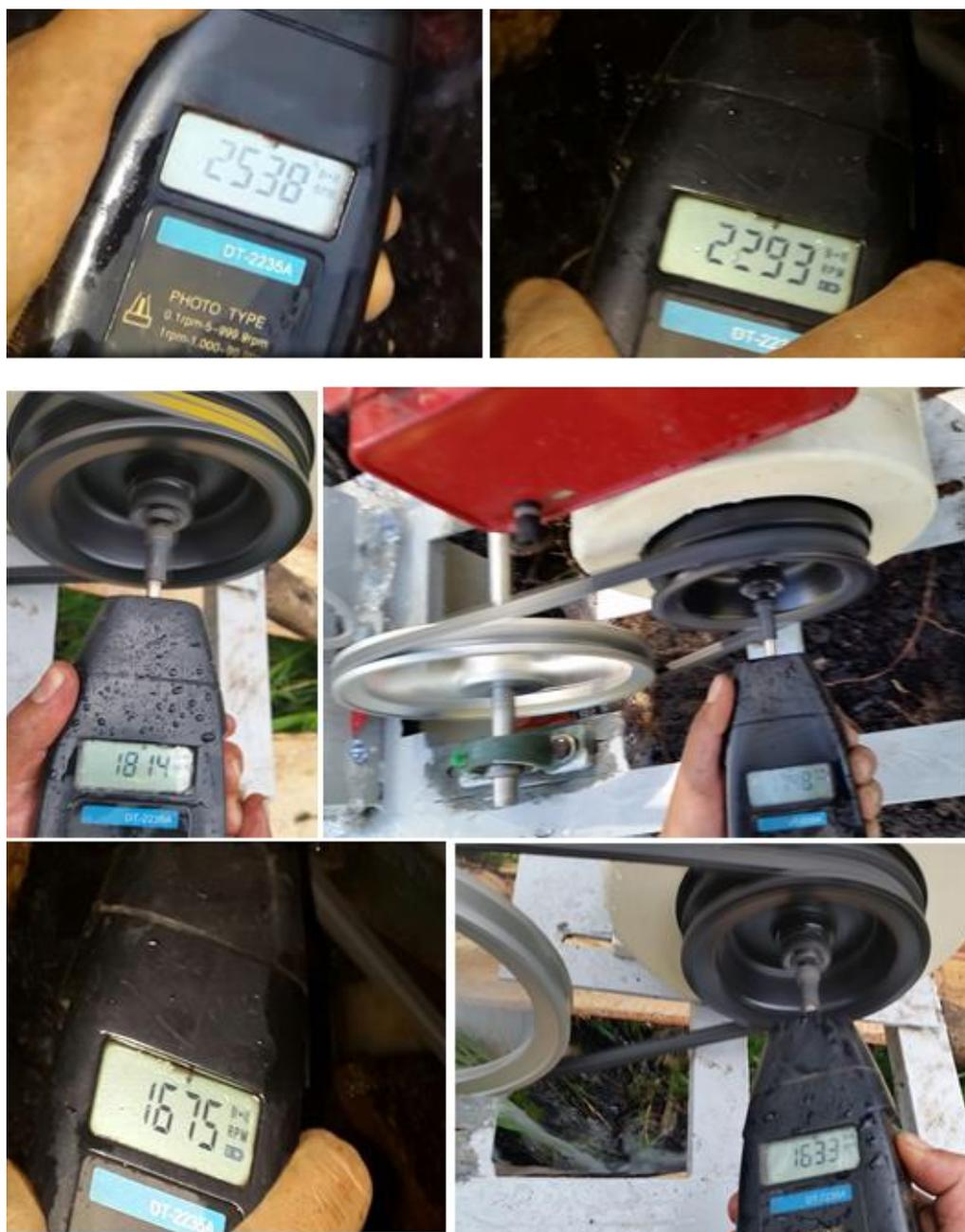
Figura 92: Verificación de velocidad en revoluciones por minuto con diversos caudales y diversas cargas conectadas en el proyecto.
