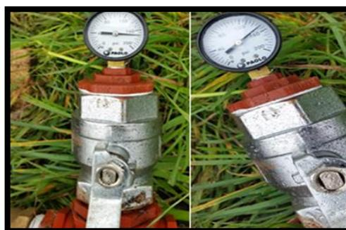
Figura 74: Medición de Presión de trabajo en el proyecto, manómetro 200 PSI.
