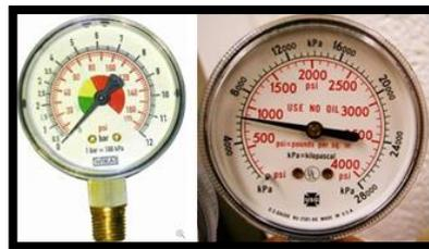
Figura 35: Manómetros de doble escala, primero PSI y Bar; segundo psi y KPa.
