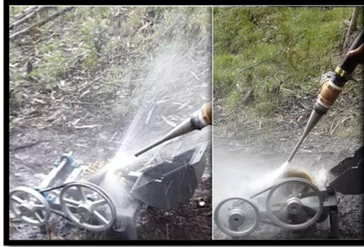
*Figura 61:* Pruebas y medición de velocidad con la carga del sistema de transmisión sin generador.
