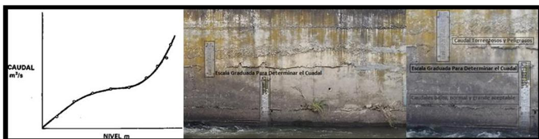
Figura 18: Curva calibrada de corriente de agua en estación de aforo y escala graduada para determinar el caudal del Río Tomebamba.
