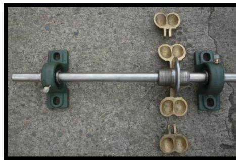
Figura 53: Eje de 3/4 acero inoxidable con sus chumaceras de 3/4 y disposición de las cucharas.
