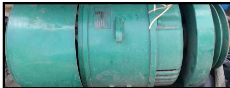
*Figura 68:* Sistema Regulator de Velocidad mediante volante de Inercia en generador de 9 KW.
