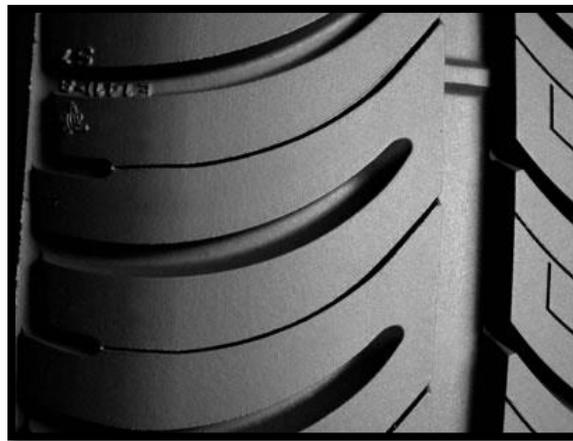
**Figura 1.2** Indicador de desgaste.
