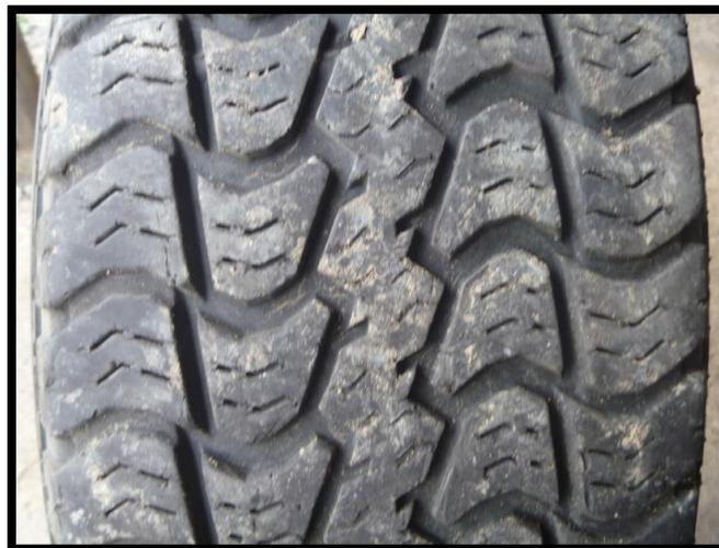
**Figura 4.24** Neumático en buen estado de la banda de rodadura.
