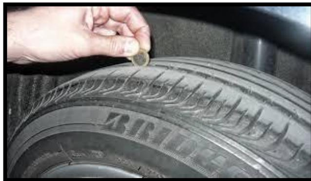
Figura 2.5 Uso de una moneda para medir la banda de rodadura.
