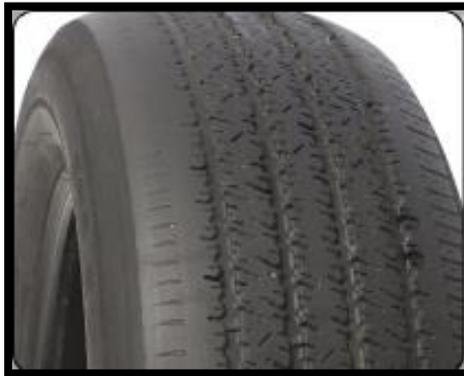
Figura 1.20 Desgaste del ángulo camber.
