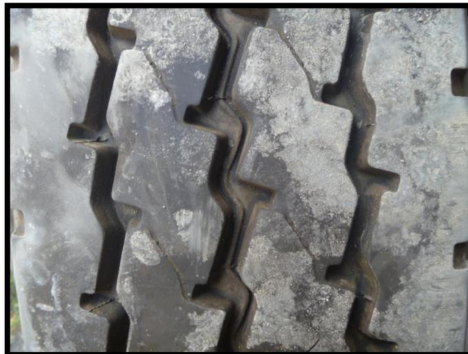
Figura 4.27 Neumático con la banda de rodadura en estado medio.
