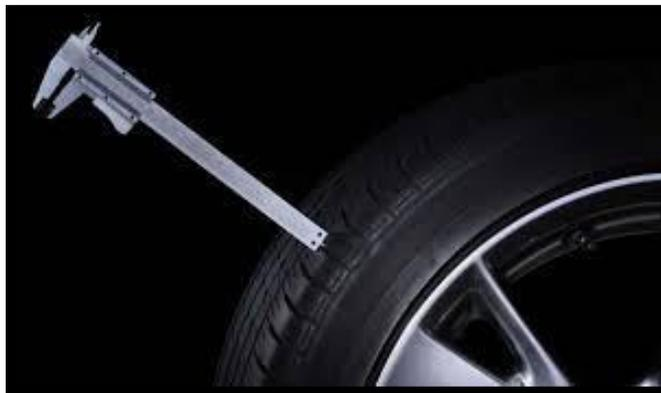
**Figura 2.1** Medición con calibrador.
