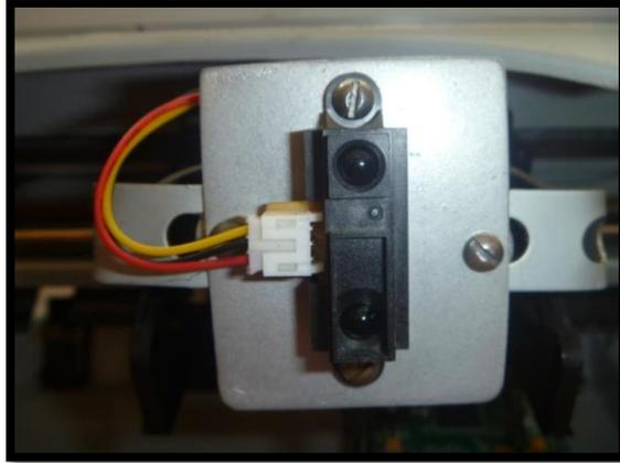
**Figura 3.12 Fijación del sensor infrarrojo.**
