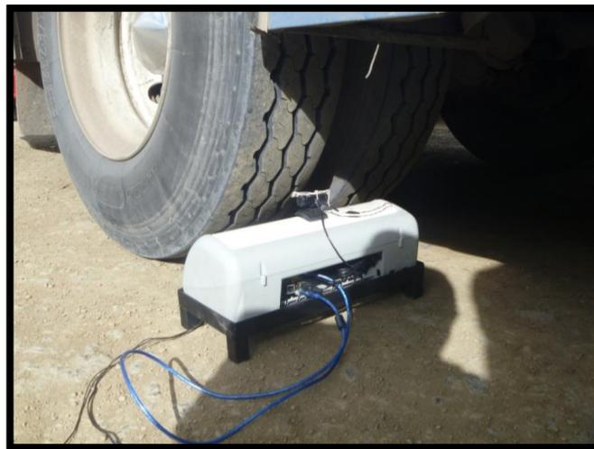
Figura 4.46 Medición de los neumáticos posteriores externos.
