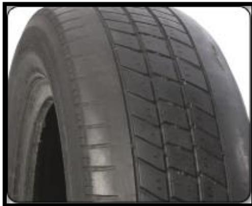
**Figura 1.19 Desgaste en un lado de la banda.**
