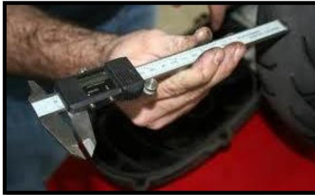
Figura 2.4 Uso del Calibrador para medir la banda de rodadura.
