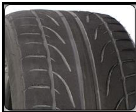
Figura 1.21 Desgaste en forma de escamas.
