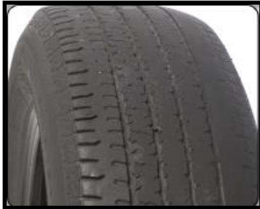
Figura 1.22 Desgaste por convergencia y divergencia.
