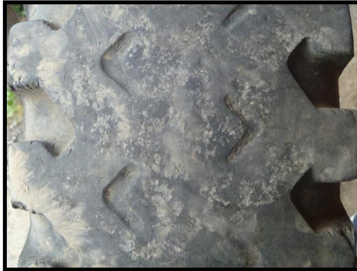
**Figura 4.30** Neumático con la banda de rodadura en mal estado.
