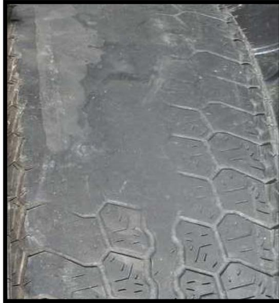
**Figura 1.3 Desgaste de la banda de rodadura.**
