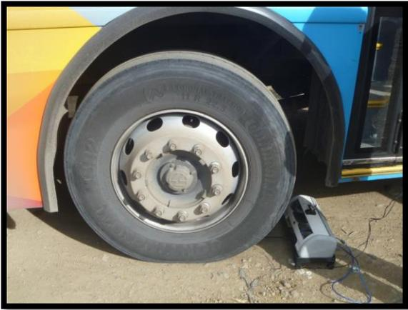
Figura 4.40 Medición de los neumáticos delanteros.
