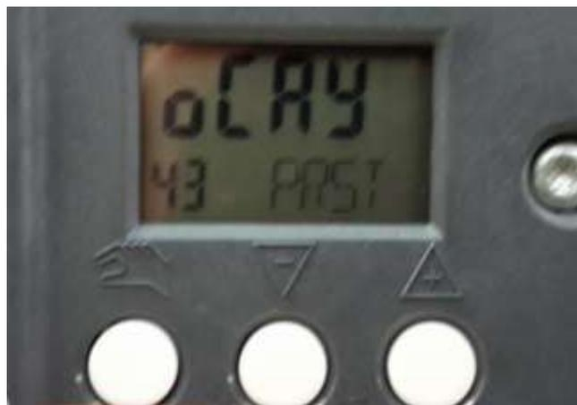
Figura 5. Visualización “oCAY” luego del reseteo del equipo.
