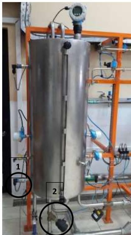
Figura 2. Ubicación del medidor de nivel y válvula de desfogue.
