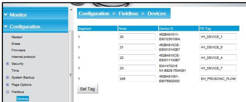
**Figura 3. 10** Dispositivos montados sobre el bus de campo Foundation Fieldbus [fuente: los autores].
