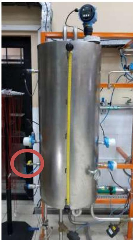
Figura 8. Localización de la válvula manual para ingreso de perturbaciones.
