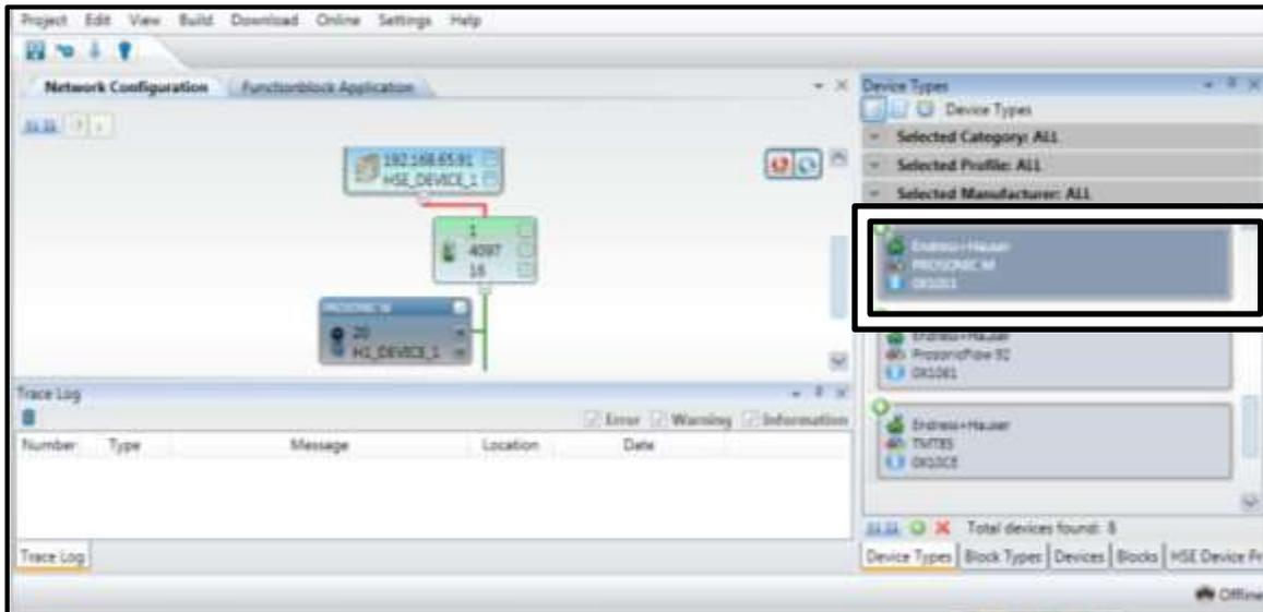
Figura 14. Adición de dispositivo de medición.
