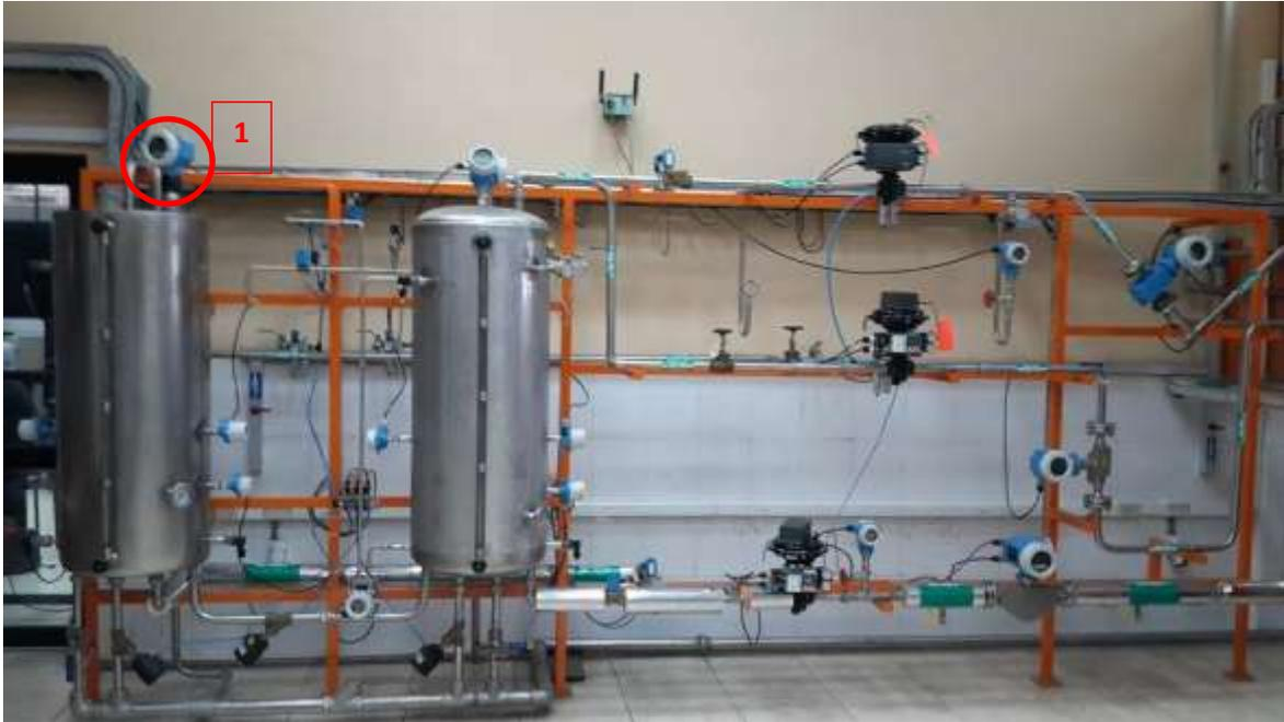
Figura 1. Ubicación del transductor Cerabar T PMC131.
