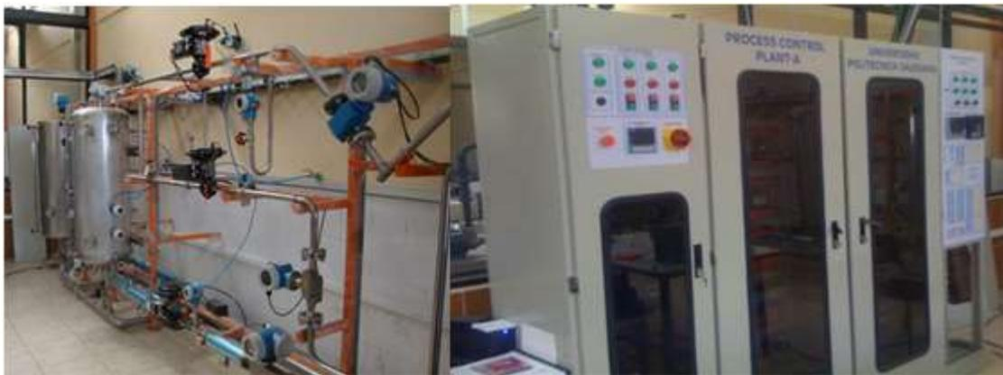
**Figura 1.1** Plata de control de procesos “A”: Tuberías, sensores y contenedores (izquierda), tablero de control (derecha) [fuente: los autores]
