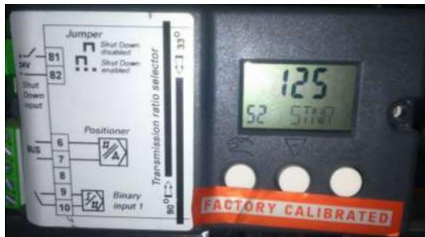
**Figura 3. 1** Parámetro 52 (Dirección Profibus del dispositivo) [fuente: los autores].
