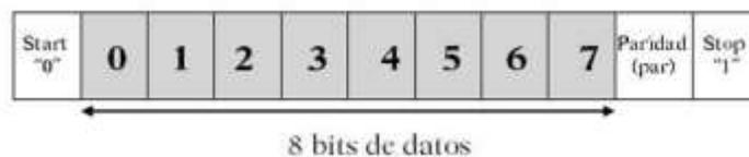
**Figura 2. 4** Estructura de un carácter generado por una UART [22].
