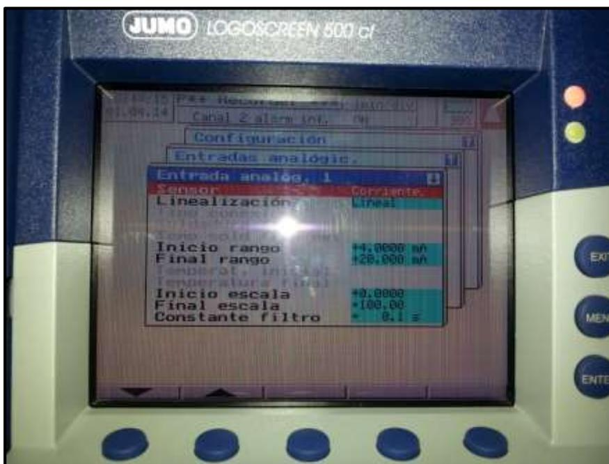
Figura 9. Configuración de entrada analógica 1.
