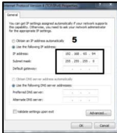
**Figura 3. 4** Configuración de la dirección IP para la red Ethernet [fuente: los autores].
