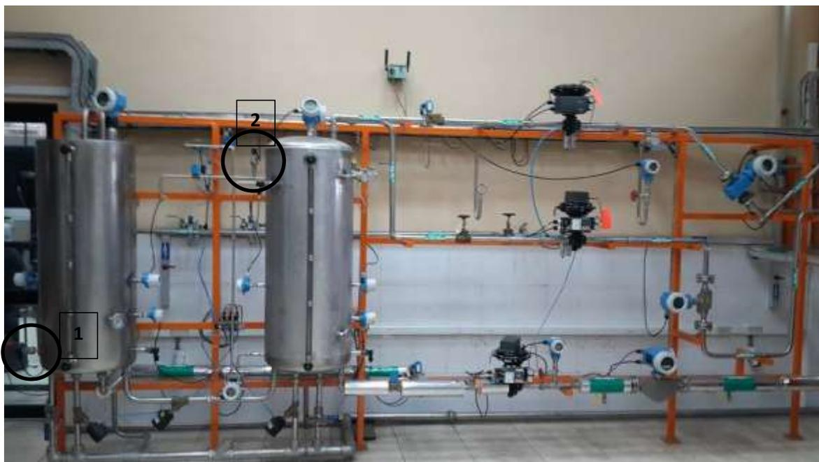
Figura 2. Ubicación del medidor de nivel y presión.
