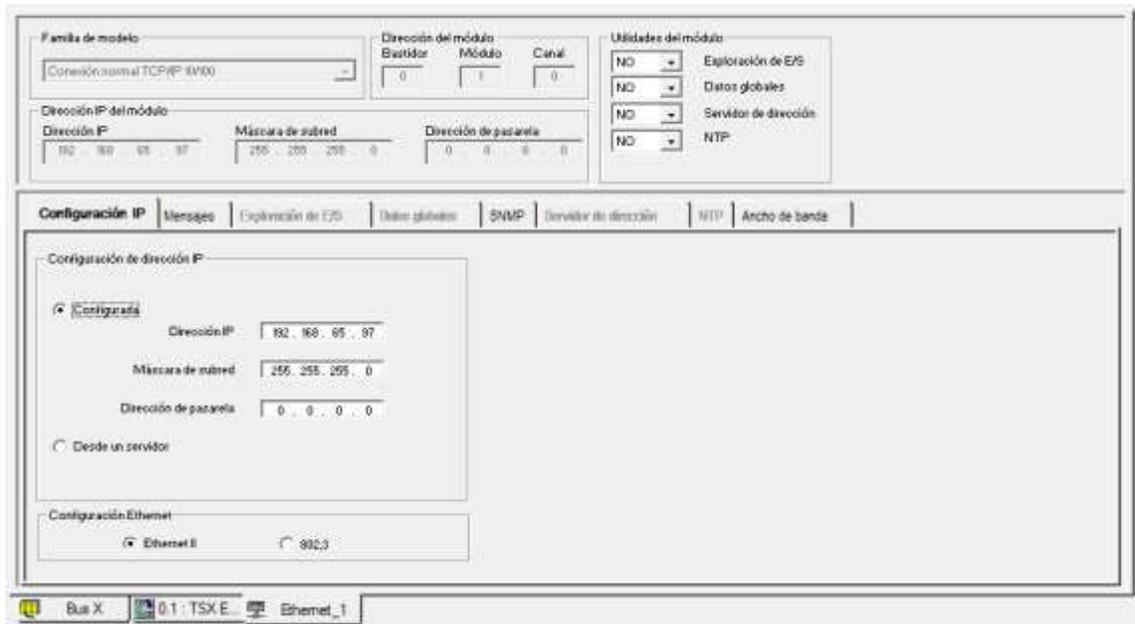
**Figura 3. 18** Configuración de la máscara y dirección IP del autómata.
