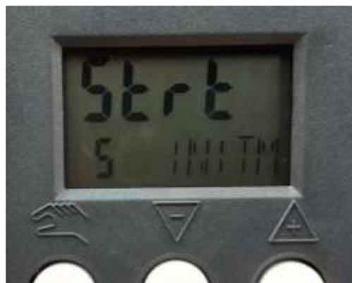
Figura 9. Mensaje “Strt” para dar inicio a la configuración.
