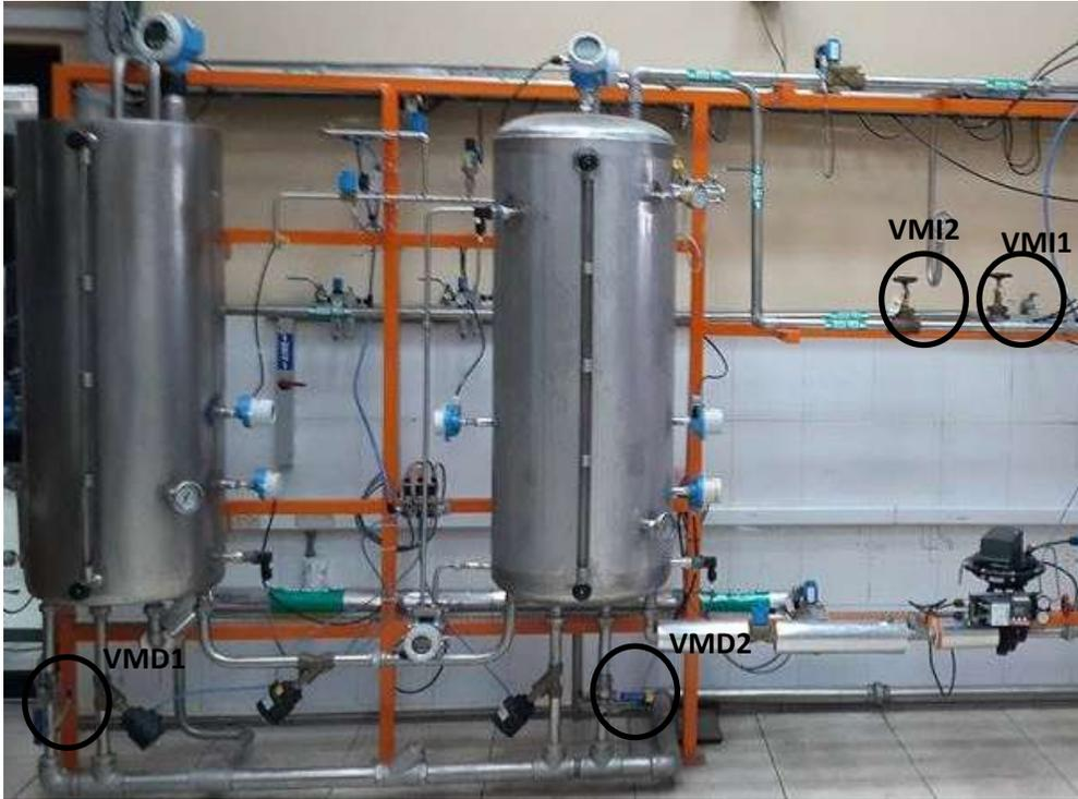
Figura 2. Ubicación de las válvulas manuales de ingreso y desfogue.
