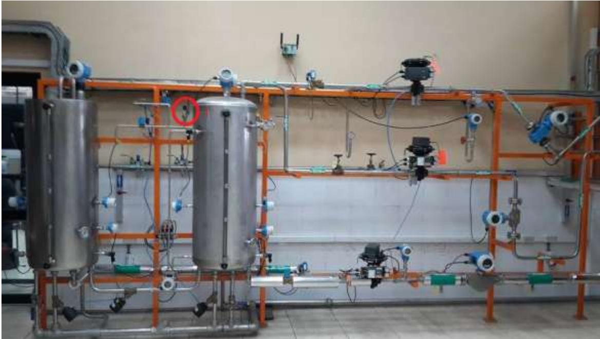
Figura 1. Ubicación del transductor Cerabar T PMC131.
