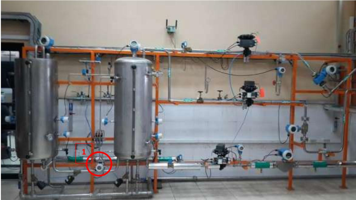
Figura 1. Ubicación del transductor Deltabar M PMD55.
