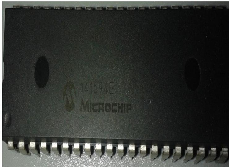
Figura 4 Microcontrolador PIC 16F877A
