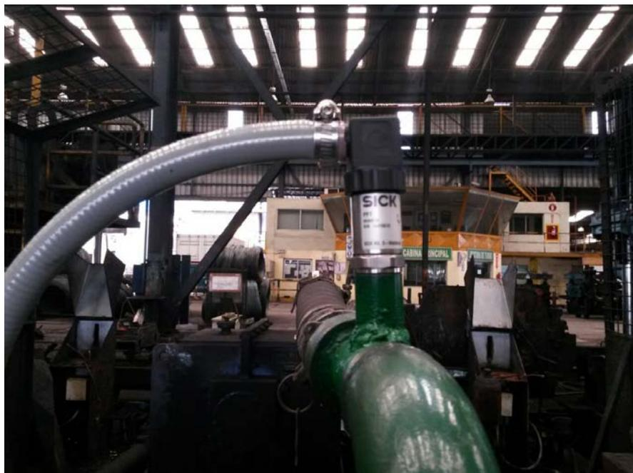
**Figura 3.16:** Sensor de presión Sick PFT colocado en la tubería
