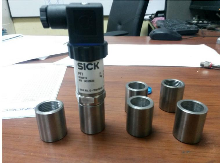
**Figura 3.15:** Soporte para los sensores de presión
