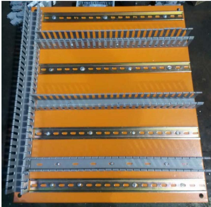
**Figura 3.2:** Distribución de canaletas y riel din
