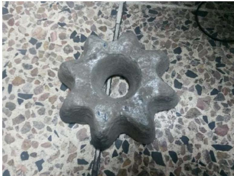
**Figura 3.12:** Estrella de aluminio, material usado como soporte de los Pt100
