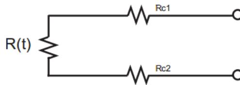
**Figura 2.45** Conexión dos hilos
