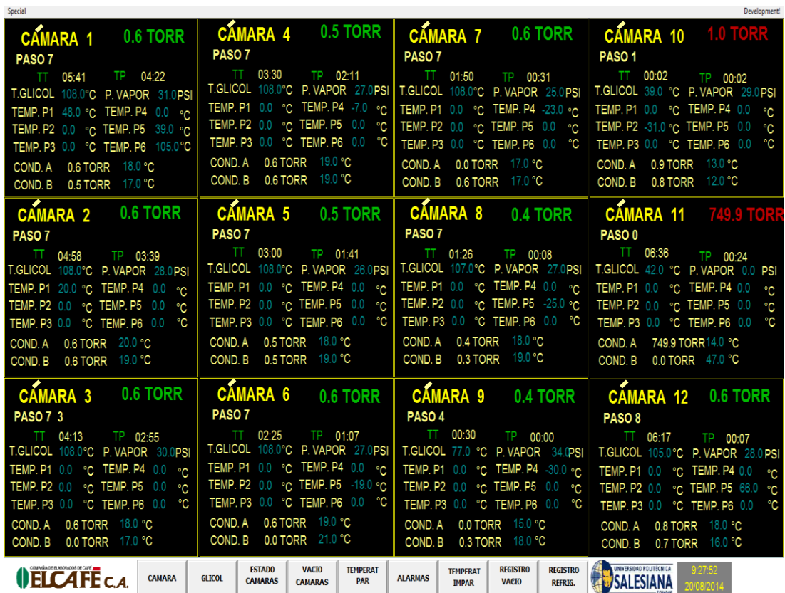
Figura 4.19. Ventana estado de camaras. Se visualiza las doce cámara en proceso y sus variables de control.
