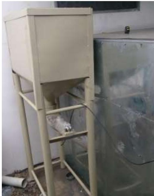
Figura N°3.9 Vista lateral de la tolva de alimentación. Tolva de alimentación utilizada en el proyecto y el pistón neumático para dosificación de alimento conectada al cubículo.
