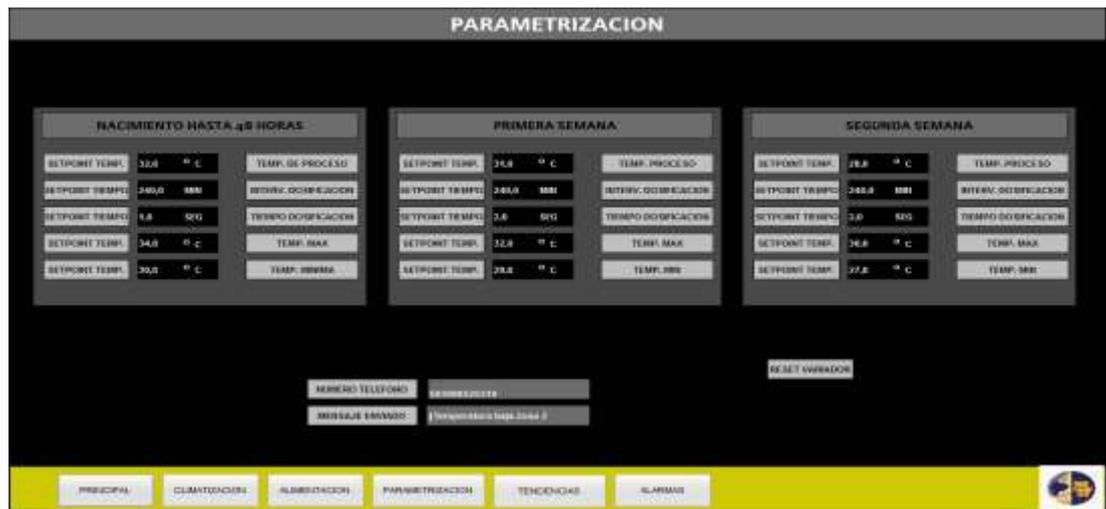
Figura N°4.10 Pantalla de Parametrización. Se ingresa y visualiza el set point y el valor actual (Tiempo de ciclo de dosificación, tiempo de dosificación, temperatura en el interior del cubículo). Así mismo se encuentran los botones de vínculos para acceder a otras pantallas.
