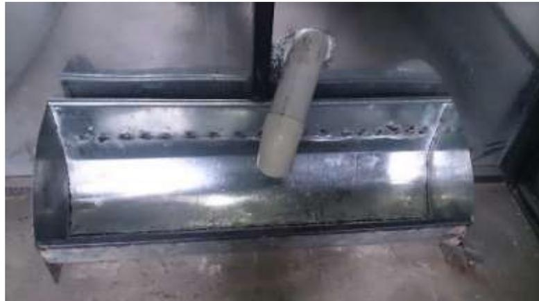
Figura N°3.12 Reservorio de alimento. Reservorio donde se deposita el alimento dispensado de la tolva de alimentación.
