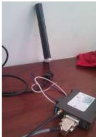
Figura N°4.33 SINAUT MD 720-3. Foto del equipo Sinaut MD 720-3 utilizado en el proyecto.
