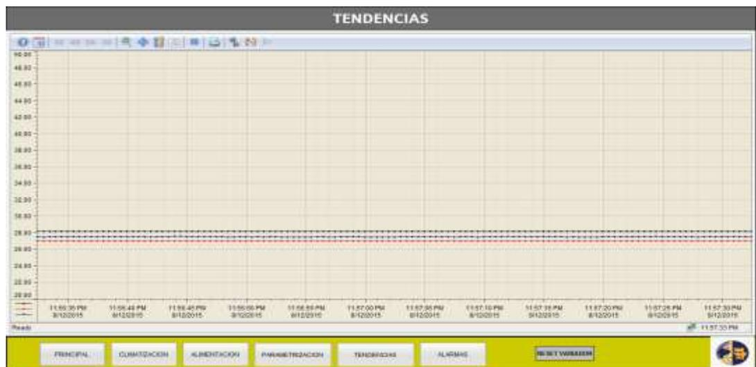
Figura N°4.11 Pantalla de Tendencia. Se visualiza la tendencia en tiempo real de la temperatura en el interior del cubículo. Así mismo se encuentran los botones de vínculos para acceder a otras pantallas.
