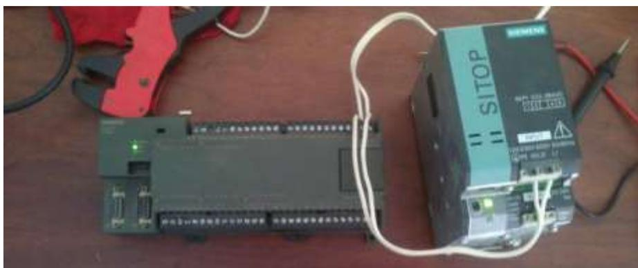
Figura N°3.1 PLC S7200 CPU 226. PLC seleccionado para utilizarse en el proyecto.
