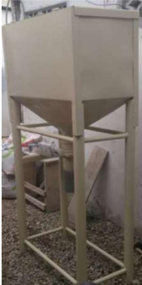
Figura N°3.8 Vista frontal de la tolva de alimentación. Tolva de alimentación utilizada en el proyecto y el pistón neumático para dosificación de alimento.
