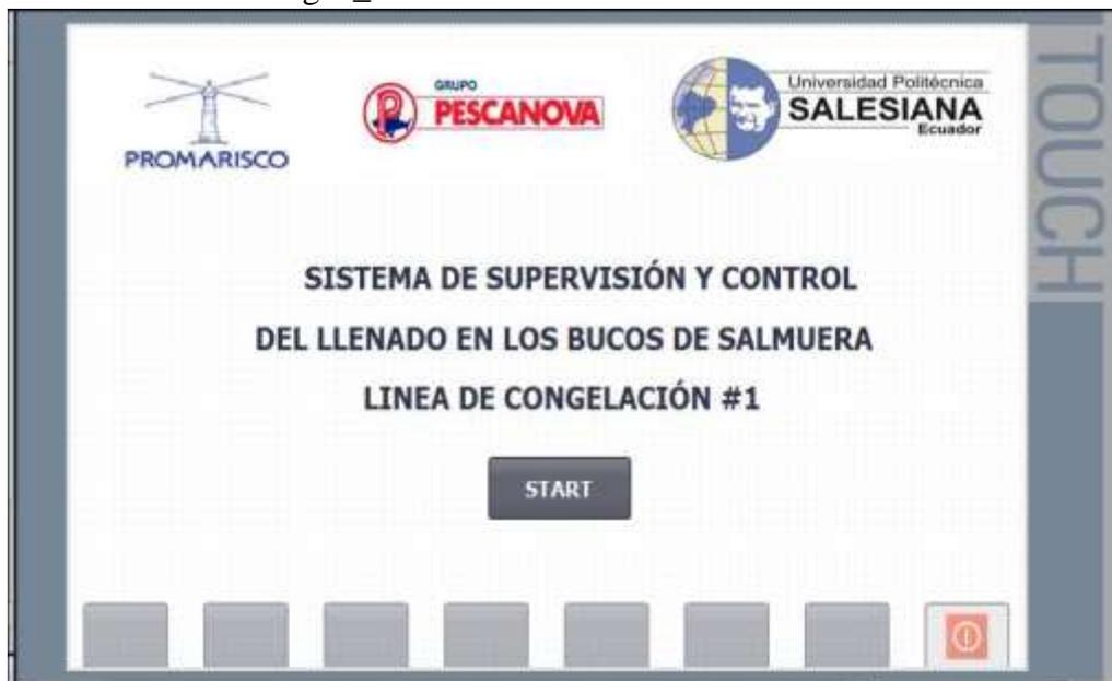
**Figura 3.34: Pantalla principal HMI.** Imagen principal del HMI del sistema, al presionar el botón START en la pantalla principal continúa a la segunda presentación donde se puede controlar el proceso de forma automática.
