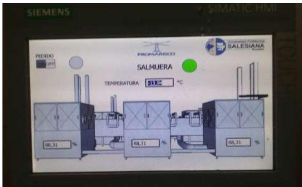
**Figura 3.60: Lecturas de nivel y temperatura de los bucos.** Visualización de las lecturas de los transmisores de presión y temperatura en el touch panel.
