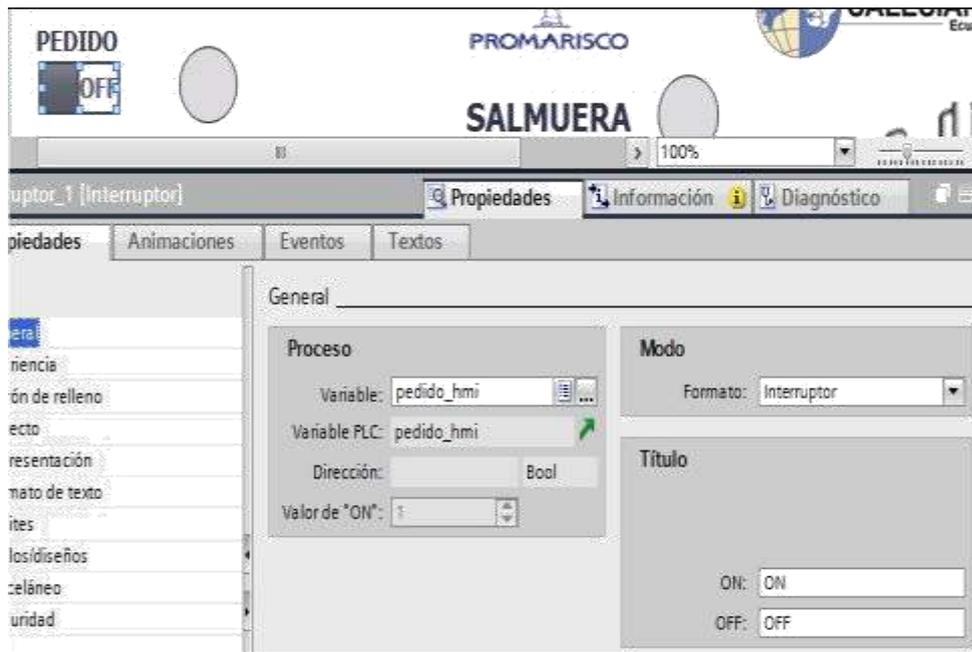
**Figura 3.38 Asignación de variable interruptor PEDIDO.** Asignación de la variable del PLC pedido\_hmi al interruptor del HMI PEDIDO.
