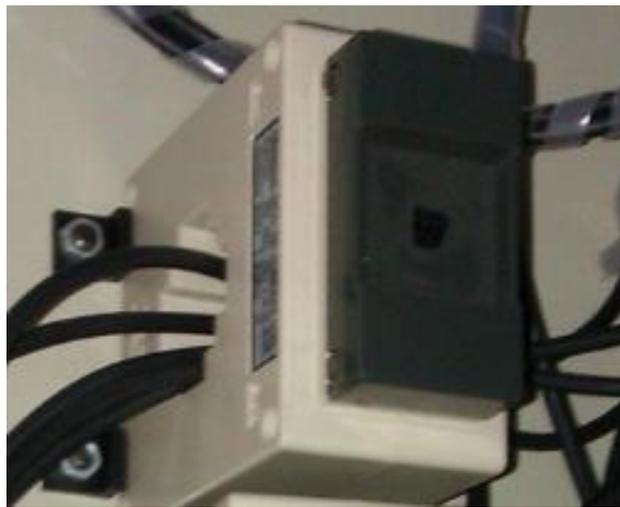
**Figura 26:** Sensor de corriente efecto Hal. (Entreprise.Co, 2011),
