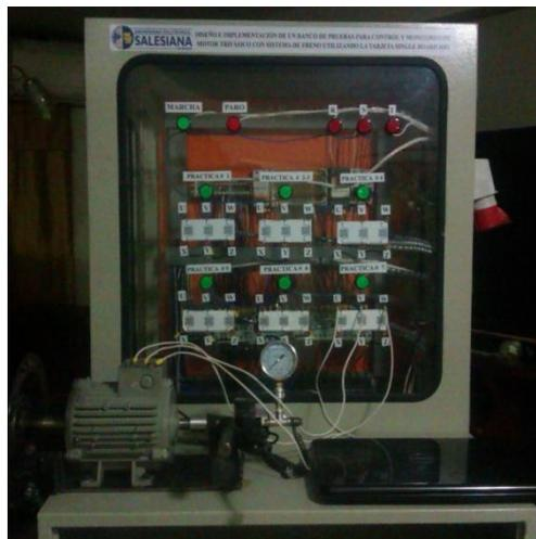
**Figura 40:** Terminales de prueba del banco.
