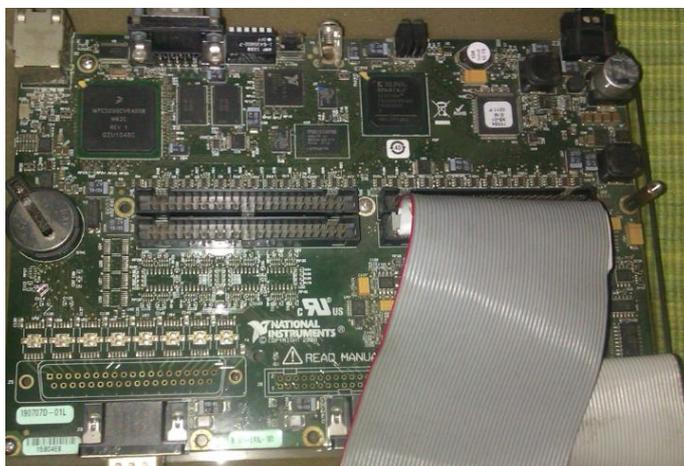
**Figura 28:** Tarjeta Adquisición SBRIO 9631.
