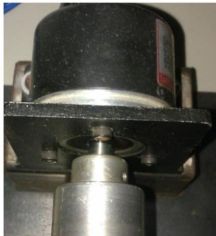
**Figura 6:** Encoder incremental. Encoder utilizado para obtener rpm del motor.
