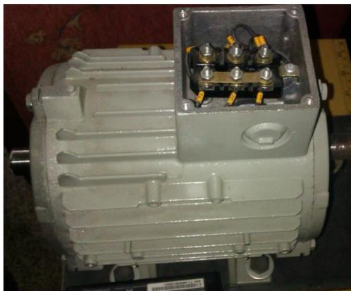
**Figura 2 :** Motor trifásico de inducción. Motor trifásico utilizado para prácticas.
