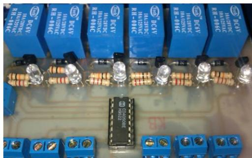
**Figura 45:** Circuito control luces piloto. Control luces piloto para visualización de prácticas.
