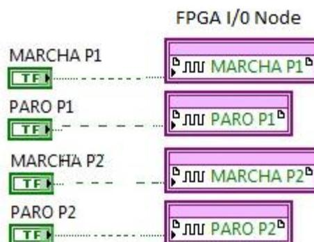
**Figura 54:** Conexión control Booleano con FPGA I/o Node.
