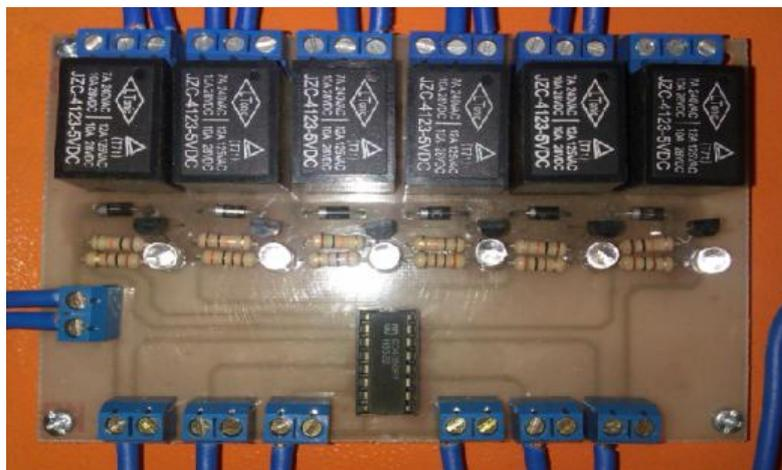
**Figura 36:** Montaje Tarjeta de Control.
