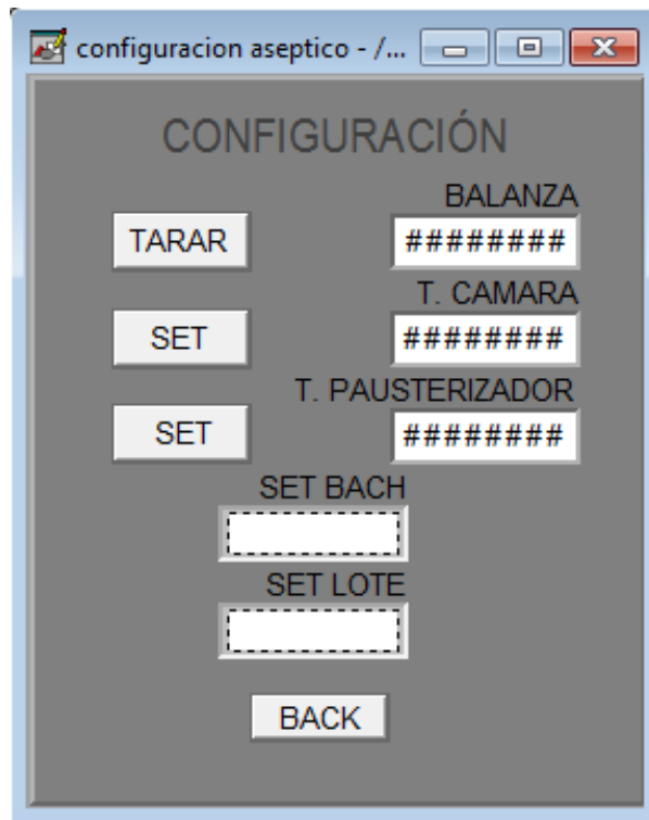
Figura 68: Config. Llenadora. Se activan sub rutinas establecidas en el PLC y, se visualizan los valores de los indicadores. Diseñado con el programa FactoryTalk View Studio 7.0 de RockWell Automation. 2014-2015.
