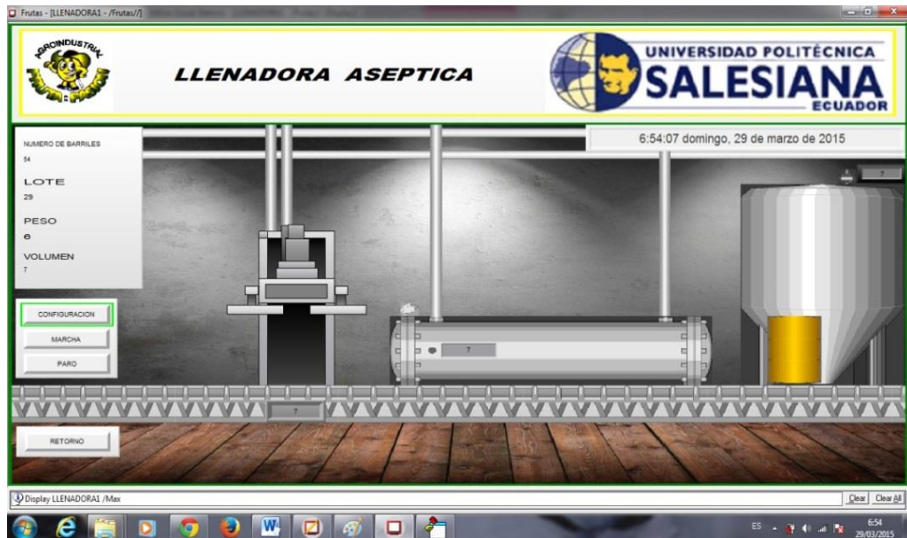
Figura 80: Puesta en marcha llenado. Se muestra como en el SCADA como se va desarrollando el proceso de llenado. Ubicado en la AGRO INDUSTRIAL FRUTAS DE LA PASIÓN C. LTDA.
