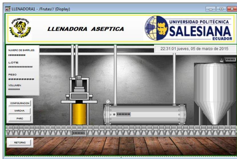
Figura 67: Llenadora Aséptica. Se muestra la gráfica que representa el proceso de llenado y, se visualizan los valores de los indicadores. Diseñado con el programa FactoryTalk View Studio 7.0 de RockWell Automation.
