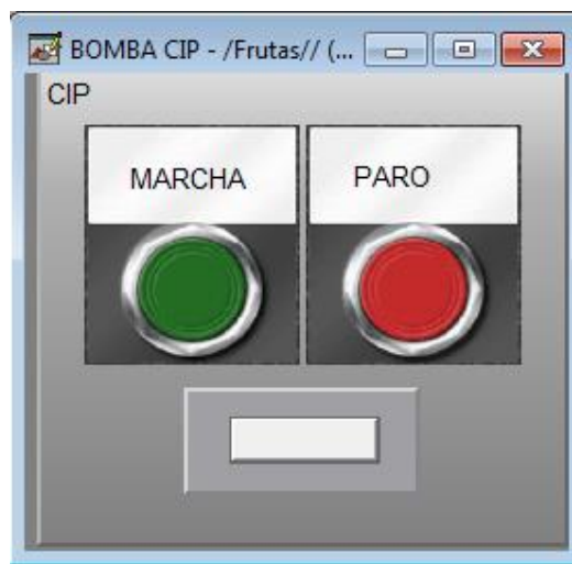
Figura 70: Bomba CIP. Se controla en encendido y apagado del CIP de forma manual. Diseñado con el programa FactoryTalk View Studio 7.0 de RockWell Automation.
