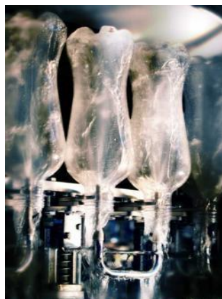
Figura 2: Llenado aséptico. Es parte del proceso de llenado aséptico, se están esterilizando las botellas, previo al llenado. Recuperado de http://www.geape.com.ar/nar/cmsdoc.nsf/webdoc/webb7p6qpc
