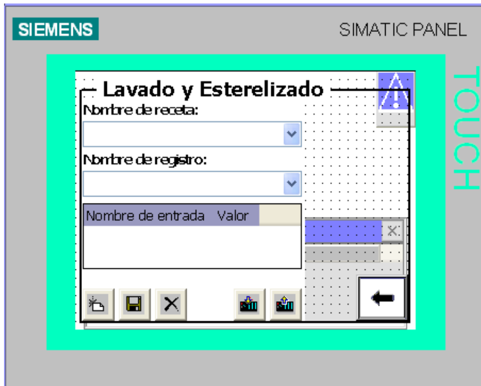
Figura 35: Lavado y Esterilizado Registro. Es la pantalla donde se los tiempos que duran los procesos de lavado y esterilizado del sistema de llenado aséptico. Diseñada en WinCC Flex. Ubicado en la Agro Industria FRUTAS DE LA PASIÓN C. LTDA.
