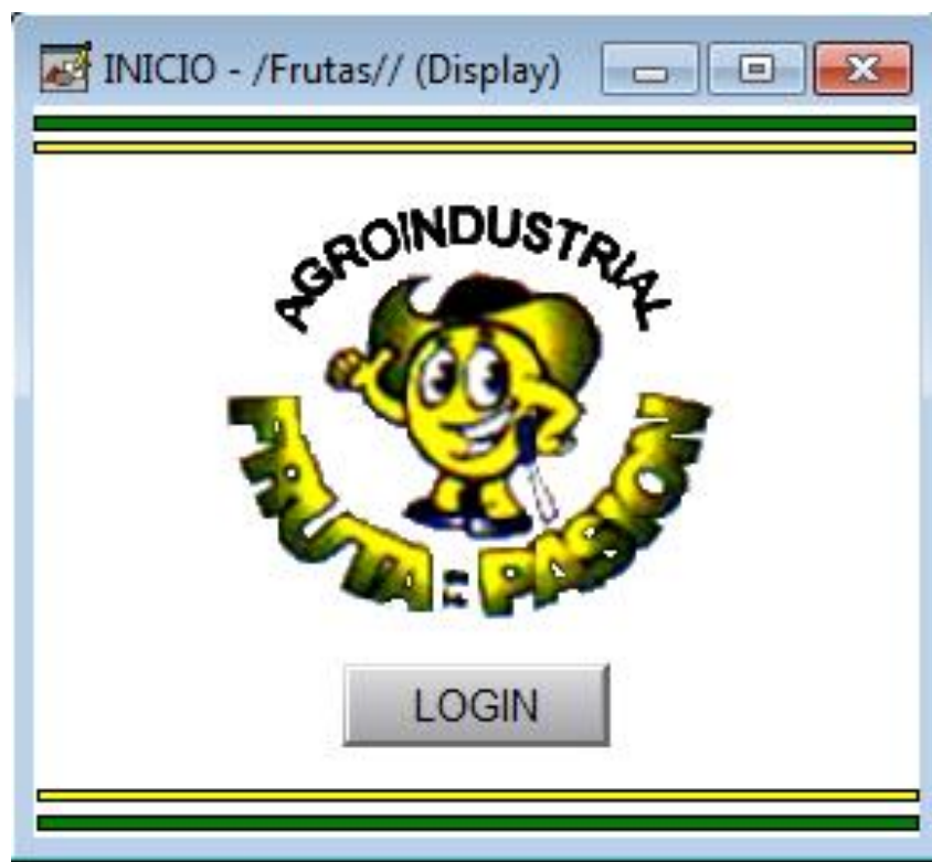
Figura 65: Logeo. Controla el ingreso de los usuarios en el SCADA. Diseñado con el programa FACTORYTALK VIEW STUDIO 7.0 de Rockwell Automation.
