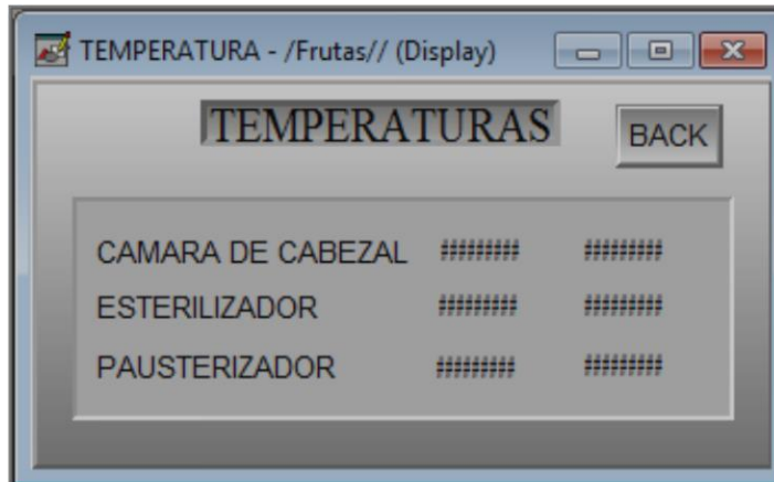
Figura 71: Ventana de temperaturas. Se puede visualizar con indicadores numéricos las diferentes temperaturas de las Pt-100. Diseñado con el programa FactoryTalk View Studio 7.0.
