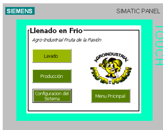
Figura 40: Menú Llenadora Frio. En esta pantalla se encuentra las opciones del sistema de llenado en frio. Diseñada en WinCC Flex. Ubicado en la Agro Industria FRUTAS DE LA PASIÓN C. LTDA.
