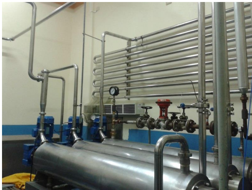
Figura 76: Intercambiadores. Se puede visualizar parte del sistema de llenado aséptico, la válvula porcentual para regular cantidad de flujo de vapor y los intercambiadores de temperatura. Ubicado en la AGRO INDUSTRIAL FRUTAS DE LA PASIÓN C. LTDA.
