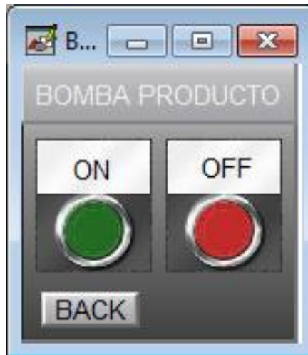
Figura 69: Bomba Producto. Se controla en encendido y apagado de la bomba de producto de forma manual. Diseñado con el programa FactoryTalk View Studio 7.0 de RockWell Automation.
