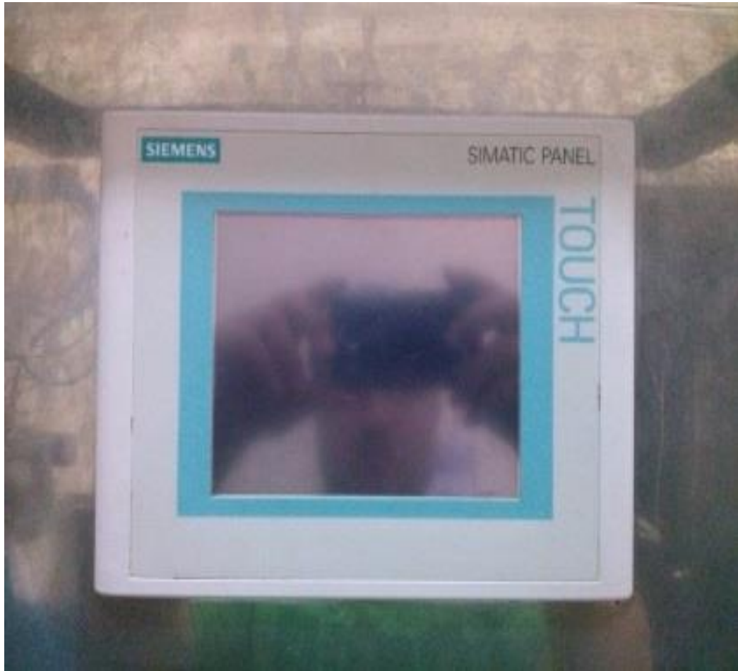
Figura 5: HMI. Es una pantalla, sistema de interface del ser humano con la máquina o el sistema de control, PLC. Por SIEMENS. Que se encuentra en la AGRO-INDUSTRIAL FRUTAS DE LA PASIÓN C. LTDA.
