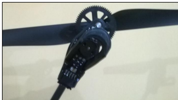
Figura 10: Hélices con variador de velocidad y motor; el material de las hélices es plástico común solo la base es de fibra de carbono.
