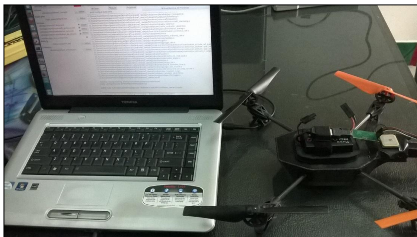
Figura 5: Imagen de comunicación pc-drone mediante Wi-fi. La comunicación entre estos dos equipos es con un dispositivo extra conectado al drone como se muestra
