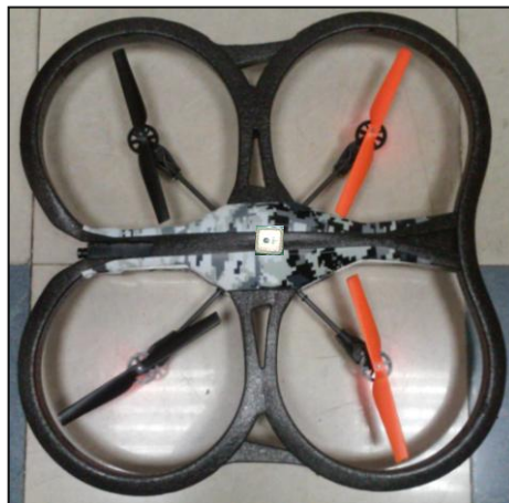
Figura 35. El Ardrone2.0 con nuevo protector. Para proteger las hélices.
