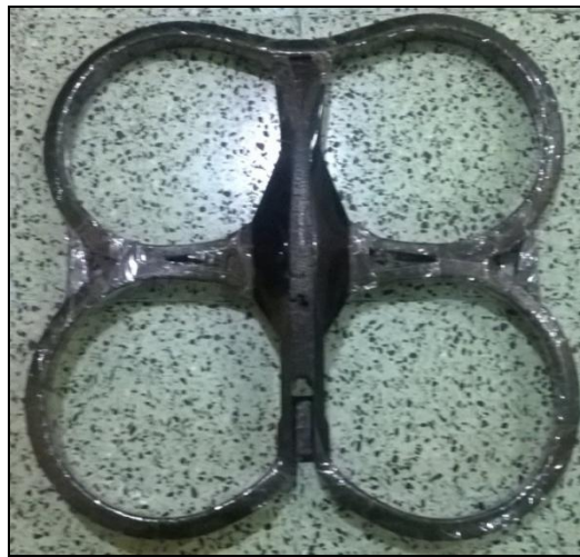
Figura 9: Protectores de hélices, cubierta de espuma que evita el golpe directo con algún obstáculo dentro del plan de vuelo.
