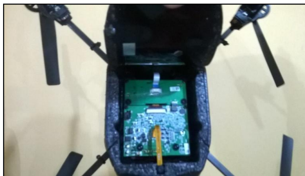
Figura 8: Placa Air drone, esta imagen muestra lo compacto de la placa con sus componentes recubiertos con un protector de espuma.
