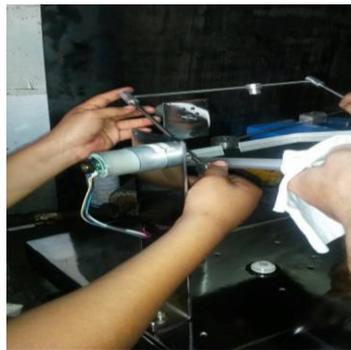
**Figura 3.12 Colocación de motores DC.** Ajustando plataforma de 2-GDL con eje de motor DC.
