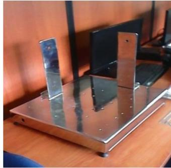
**Figura 3.11 Bases de la plataforma y bases de motores.** Bases de los motores sujeta y ajustada a la base de la plataforma donde internamente se encuentran también conectadas las tarjetas y componentes de la plataforma de 2-GDL.
