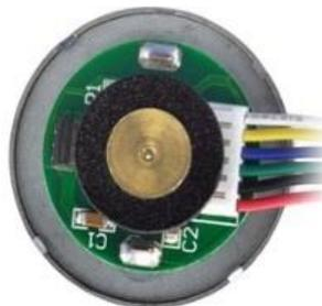
**Figura 3.20 Encoder de cuadratura de 3-20VDC.** Vista posterior del encoder implementado desde la caja de engranajes que conecta al motor reductor de 12VDC. Recuperado de: (*Robotis & Electronics Pololu, 2015*)
