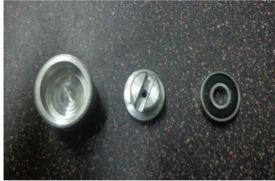
**Figura 3.2 Ajustador, Sujetador, Ruliman.** Tres Piezas Fundamentales para sostener la plancha de aluminio.
