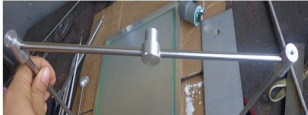
**Figura 3.9 Visualización de soporte lateral.** Unión de varillas de acero inoxidable y acoples para motores.
