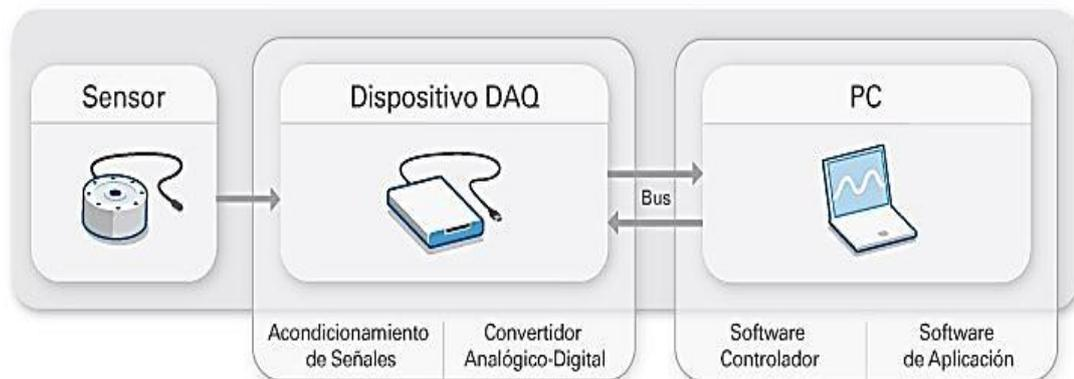
**Figura 2.14 Como funciona una DAQ.** Procesos que contiene una tarjeta de adquisición de datos. (National Instrumens, 2015)
