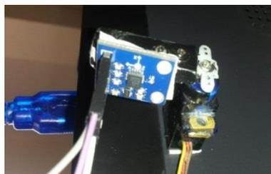
**Figura 4.8 Acoplamiento entre servomotor y acelerómetro AXDL-335.** Se toma como referencia el movimiento del servomotor para encontrar los ángulos del acelerómetro.
