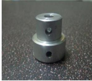
**Figura 3.5 Acople para motores.** Sostiene las varillas laterales para acoplarse con el movimiento que proporcione los motores.
