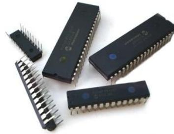
**Figura 2.11 Tipos de Microcontroladores.** Variedad de microcontroladores muy óptimos para diferentes tipos de programas que el operario desee. Recuperado de: (Microchip, 2014).
