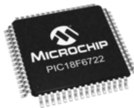
**Figura 3.23 Estructura física del microcontrolador PIC18F6722.** Recuperado de: (Microchip, 2014)
