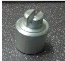
**Figura 3.3 Ajustador, Sujetador, Ruliman (en conjunto).** Unión de las 3 Piezas formando un solo cuerpo.
