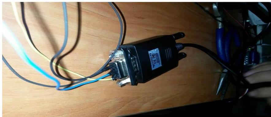
**Figura 4.34 Comunicación Serial a USB.** Se realiza la conexión RS232 para enlazar el panel resistivo con la PC.
