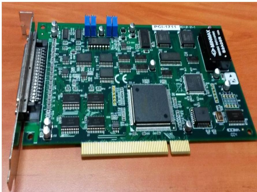
**Figura 3.25 Tarjeta de Adquisición de Datos PCI-1711.** Cuenta con 16 canales para entradas digitales, 16 canales para salidas digitales, 16 canales para entradas analógicas, 2 canales para salida analógica.
