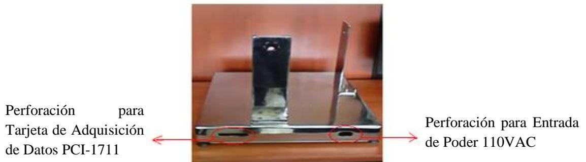
**Figura 3.16 Perforaciones laterales de la base de la plataforma.** Perforaciones para la tarjeta de adquisición de datos PCI-1711 y entrada de poder 110VAC.
