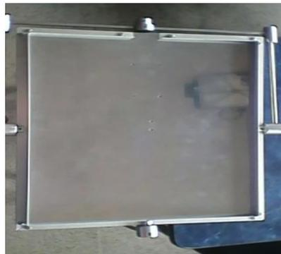
**Figura 3.18 Vista superior de la plataforma.** Se observa la ubicación los ángulos al contorno de la plataforma para sostener al panel táctico.
