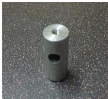
**Figura 3.4 Soporte Lateral.** Pieza para ajustar y sostener las varillas laterales del sistema.
