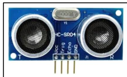
Figura 2. 8 Sensor de distancia de ultrasonido HC-SR04
