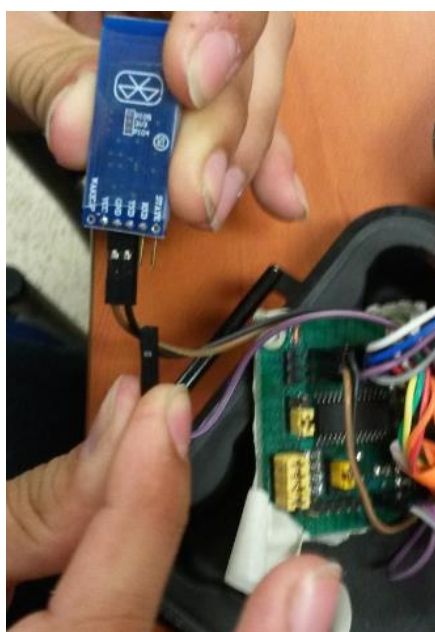
Figura 3. 12 Conexión del módulo bluetooth a la placa esclavo
