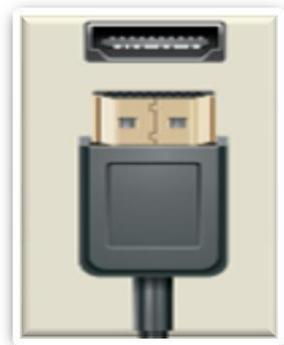
**Figura 2.29:** Entrada HDMI, *Nota:* Sirve para conectar equipos de entretenimiento, estos puertos incluye audio y video, recuperado de **Fuente:** (Revista del Consumidor, 2013).
