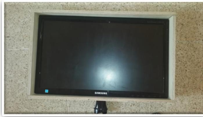
**Figura 3.19:** Resultado final de soporte con monitor, **Nota:** Muestra de cómo quedó acoplado ya el monitor con su respectivo soporte, listo para adaptarlo al sistema de semaforización.
