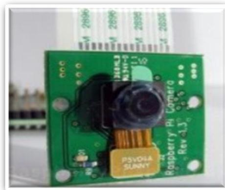
**Figura 2.8:** Cámara con Interfaz serial, **Nota:** Cámara y Flex que se conecta a la tarjeta Raspberry Pi que cumple la función de captura de video, recuperado de **Fuente:** (Perles, 2014).
