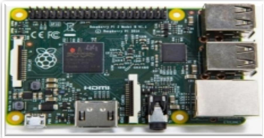
**Figura 2.3:** Nuevo modelo de Tarjeta Raspberry Pi B+, **Nota:** Esta imagen describe las variantes que va teniendo la tarjeta embebida Raspberry Pi, el aumento de puertos USB y su capacidad de soporte y almacenamiento, recuperado de **Fuente:** (Raspberry Pi Foundation, 2011).
