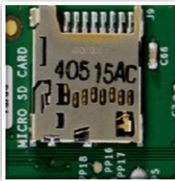
**Figura 2.6:** Tarjeta Micro SD, **Nota:** Esta imagen muestra el puerto de ubicación de la tarjeta SD que usa la tarjeta Raspberry Pi y dependiendo de eso que tipo tarjeta Micro SD se debe instalar, recuperado de **Fuente:** (Ada, 2014)
