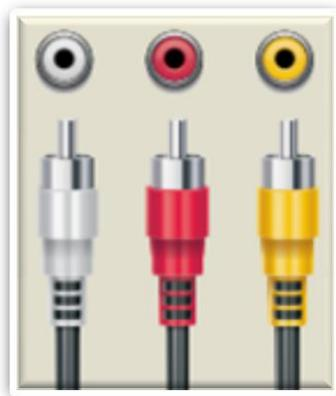
**Figura 2.27:** Entrada RCA, **Nota:** Consta de 3 entrada, el amarillo de video compuesto y blanco y rojo son para audio y video, recuperado de **Fuente:** (Revista del Consumidor, 2013).
