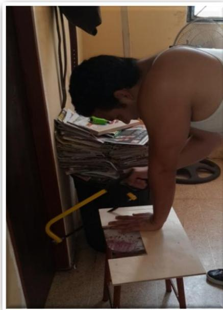
**Figura 3.14:** Construcción de los Marcos para las Pantallas, *Nota:* Proceso de cortado, para la parte posterior de la pantalla de 19".
