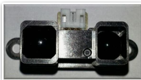
**Figura 3.2:** Sensor infrarrojo GP2Y0A02, *Nota:* Vista frontal del sensor en el cual vemos la combinación de PSD (detector sensible a la posición), IRED (emisor de infrarrojos diodo).
