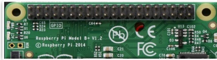
**Figura 2.12:** Imagen de los puertos GPIO de la tarjeta, **Nota:** Vista superior de los Pines GPIO, de los cuales son configurados como entradas y salidas, recuperado de **Fuente:** (Ada, 2014)
