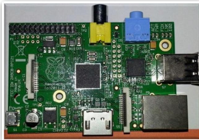
**Figura 3.4:** Raspberry Pi Modelo B, *Nota:* Vista superior de la tarjeta, en la cual vemos todos los componentes de la misma.
