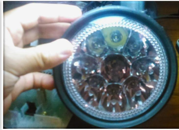
**Figura 3.11:** Luces LED, *Nota:* Observamos las luces led, estas se encuentran protegidos por una tapa rosca, para ambientes y climas hostiles.
