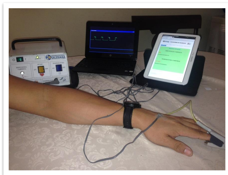
Figura 4.25 Prueba de monitoreo. Se realiza medida con paciente de frecuencia cardíaca y temperatura corporal.
