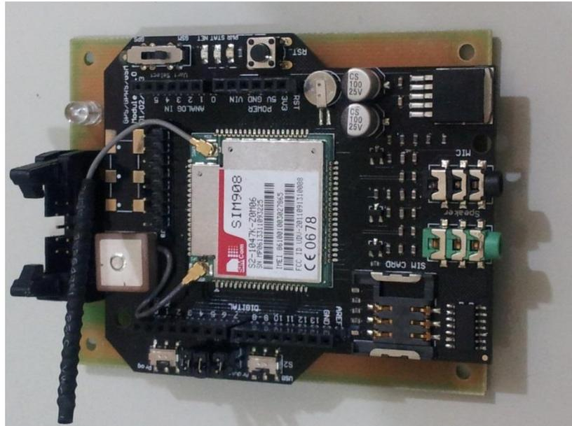
**Figura 87:** Tarjeta PCB e instalación de elementos, módulo GSM/GPRS/GPS
