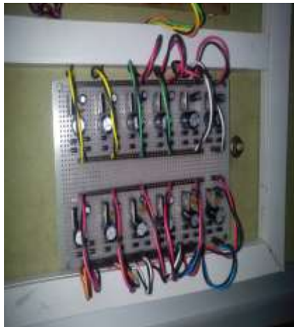
Foto 4.13. Circuito fuente de poder de 12V DC 600mA. Fuente: (Autores)
