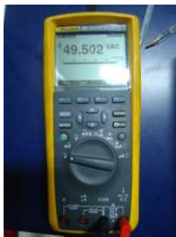
Foto 4.3. Valor de voltaje de línea V_{LN} . Lectura medida del voltaje RMS de LN desde multímetro. Fuente: (Autores)
