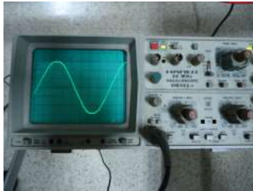
Foto 4.4. Forma de onda del voltaje línea-línea V_{RS} . Medición tomada del voltaje LL desde el osciloscopio. Fuente: (Autores)
