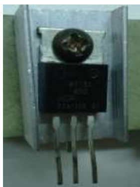
Foto 2.6. Dispositivo semiconductor SCR. Elemento SCR BT151, utilizado en el módulo. Fuente: (Autores)
