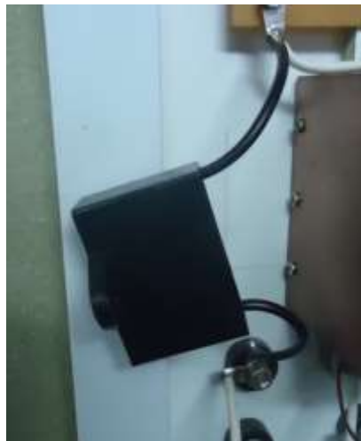
Foto 2.2. Carga capacitiva instalada en el módulo. Elemento capacitivo de 8 \mu\text{f} a 60V. Fuente: (Autores)
