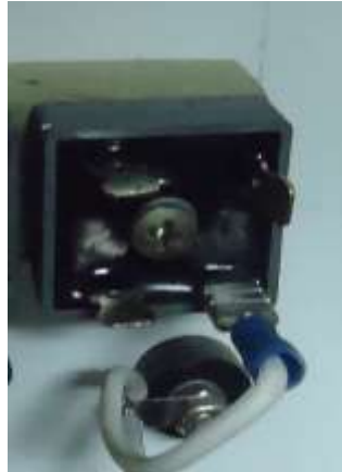
Foto 2.5. Puente de diodos. Encapsulado de un puente de diodos de potencia utilizado en el proyecto. Fuente: (Autores)
