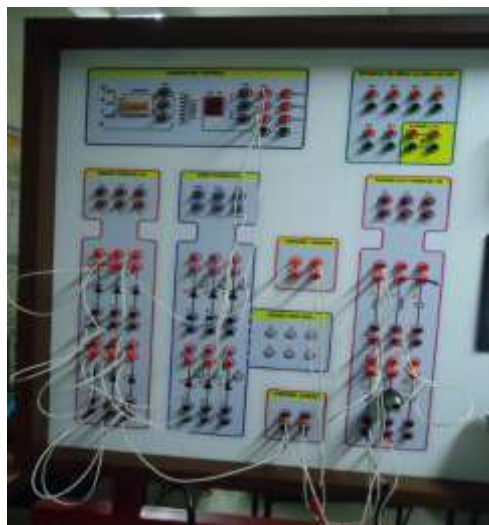
Foto 4.9. Conexión de rectificador con diodos. Vista de panel frontal del rectificador trifásico de onda completa con diodos. Fuente: (Autores)
