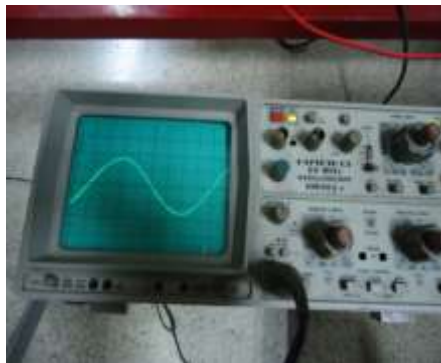
Foto 4.2. Forma de onda de voltaje de línea V_{RN} . Medición tomada del voltaje LN desde el osciloscopio.
