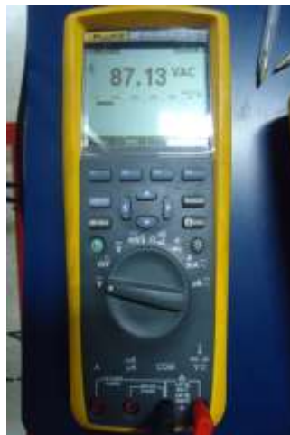
Foto 4.5. Valor de voltaje línea-línea V_{RS} . Lectura medida del voltaje RMS de LL desde multímetro. Fuente: (Autores)
