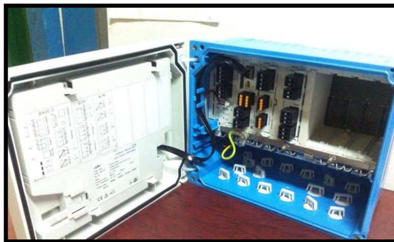
Figura 2.9: Liquiline CM444. Vista interior del transmisor de señales. Por Endress Hauser, (2015)
