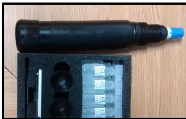
Figura 2.15: Sensor de oxígeno Oxymax COS51D. Dispositivo de medición del oxígeno disuelto de la planta de tratamiento de aguas residuales CARTOPEL S.A.I. Por Endress Hauser, (2015)
