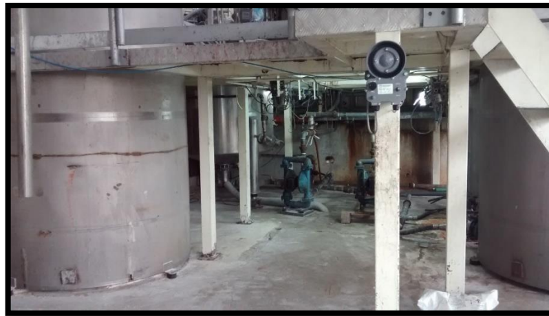
Figura 3.2 Sistema del lavado de goma. Sistema de dosificado y preparación de goma por medio de almidón. CARTOPEL S.A.I., (2015)
