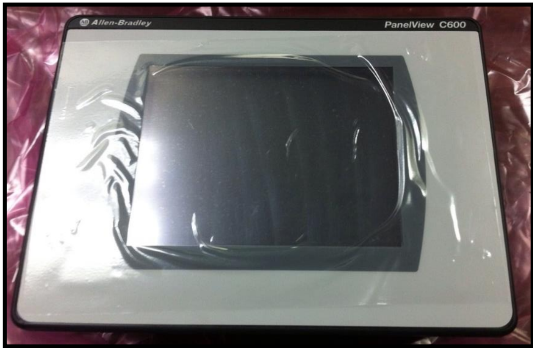
Figura 2.6: Panel View Component C600. Dispositivo HMI para monitoreo de las variable del proceso. Por Allen Bradley, (2015)
