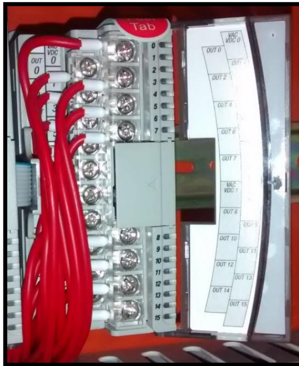
Figura 2.3: Módulo 1762 OW16. Dispositivo de expansión de 16 salidas digitales tipo relé. Por Allen Bradley, (2015)
