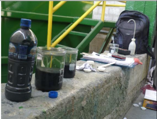
Fotografía 12.- Pruebas piloto para determinar la dosis optima
