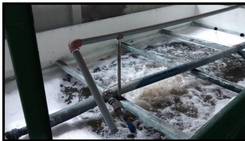
Figura 3.11 Tanque de aireación. Vista superior de la aireación del agua para la activación de las bacterias. CARTOPEL S.A.I., (2015)
