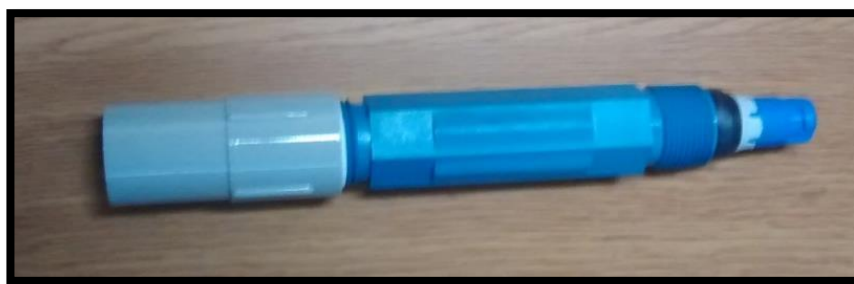
Figura 2.11: Sensor de pH Orbipac CPF81D. Dispositivo de medición de PH del tratamiento de aguas residuales CARTOPEL S.A.I. Por Endress Hauser, (2015)
