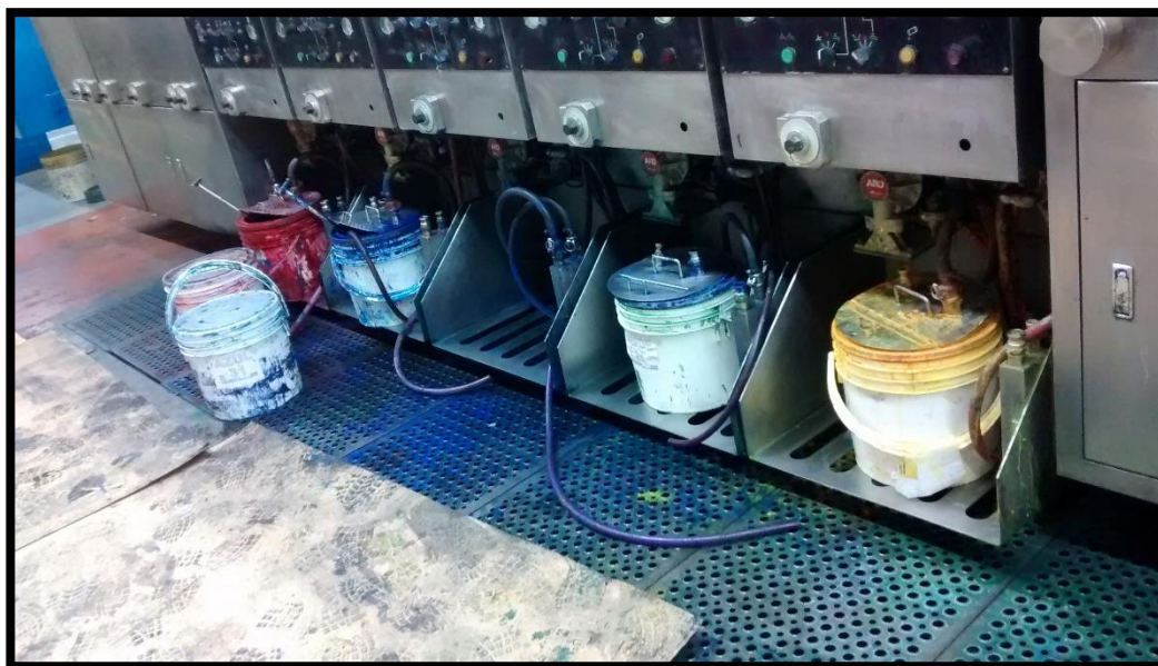
Figura 3.4 Lavado del sistema de Impresión. Lavado de los Cuerpos de impresoras de imprentas flexográficas de la empresa. CARTOPEL S.A.I., (2015)
