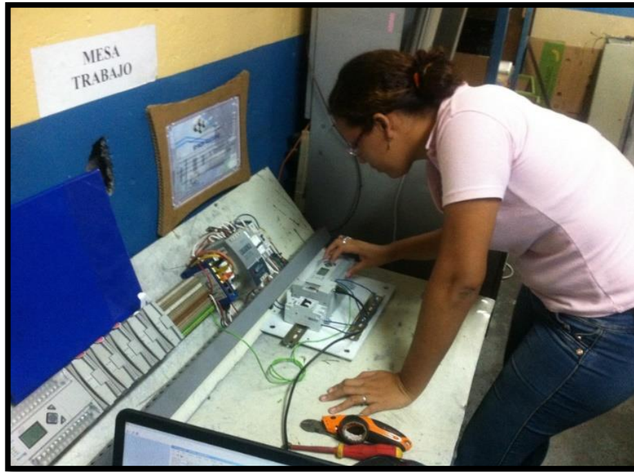
Figura 5.2 Configuración de PLC. Direccionamiento IP para comunicación.
