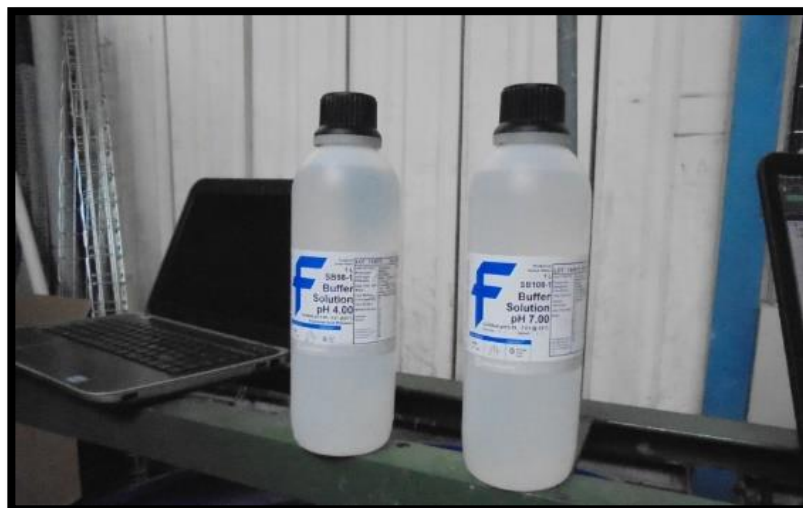
Figura 4.11 Buffers de pH. Muestras para calibrar el sensor de pH. Fisher Scientific. (2015).
