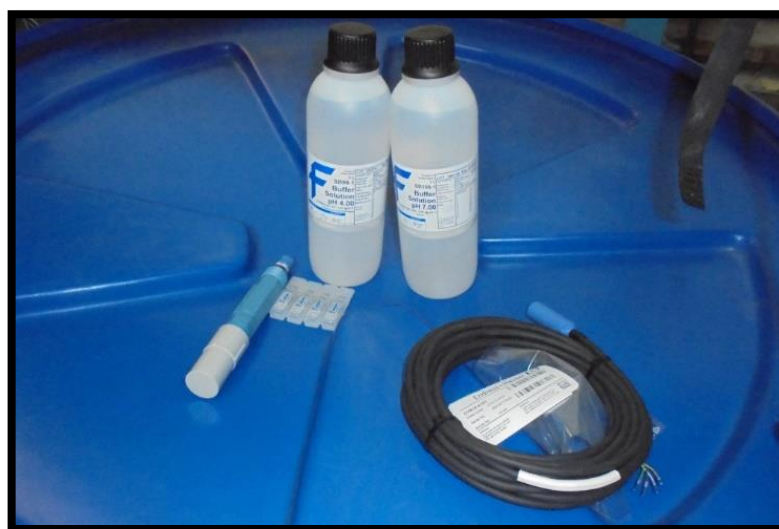
Figura 4.12 Elementos de calibración. Sensor de pH, Cable Memosens, Buffers.
