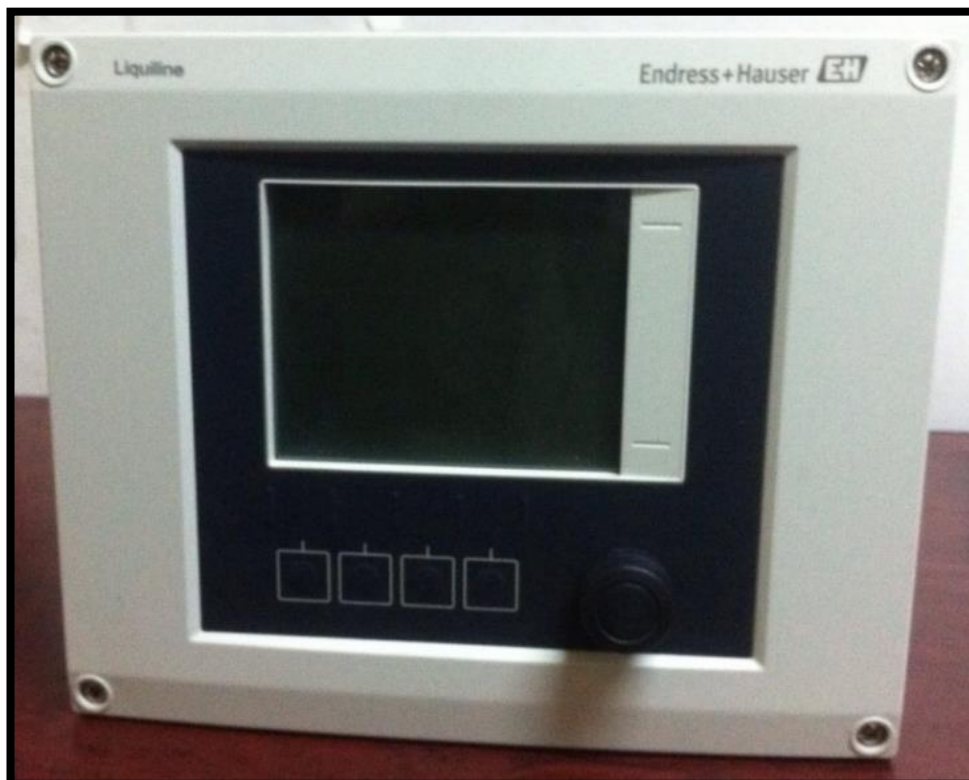
Figura 2.8: Liquiline CM444. Vista frontal exterior del transmisor digital de señales analógicas. Por Endress Hauser, (2015)
