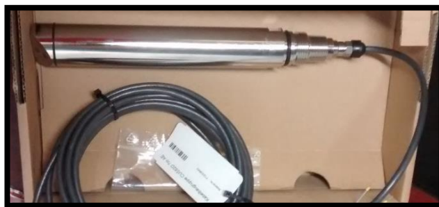
Figura 2.13: Sensor de turbidez Turbimax CUS52D. Dispositivo de medición de turbidez del tratamiento de aguas residuales CARTOPEL S.A.I. Por Endress Hauser, (2015)
