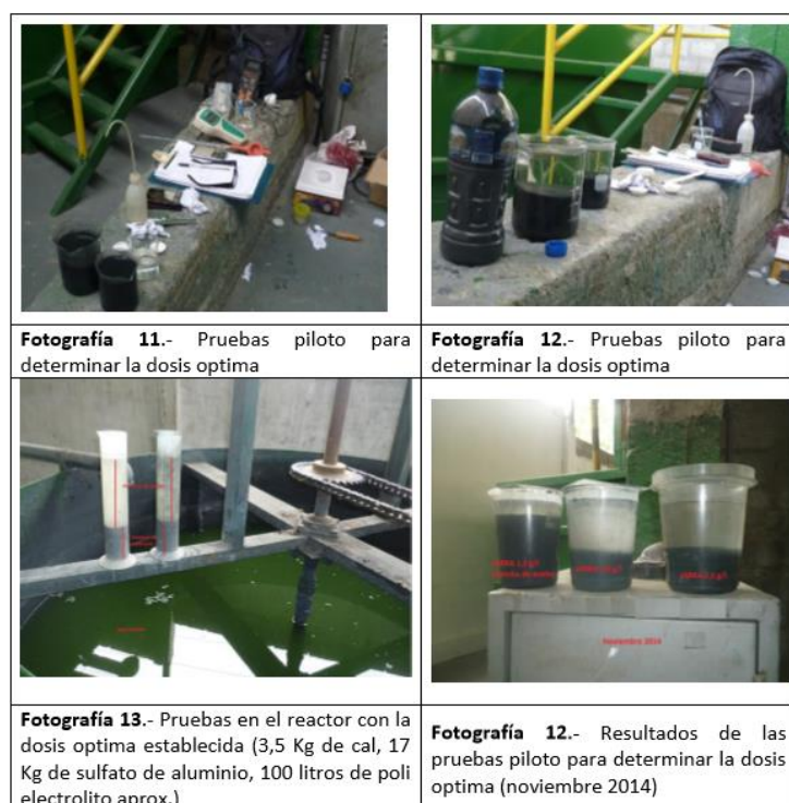
Figura 3.19 Pruebas en campo para determinar la dosis óptima. Muestras de mediciones de la sedimentación del agua tratada con la aplicación de diferentes cantidades de los químicos que interactúan en el proceso.
