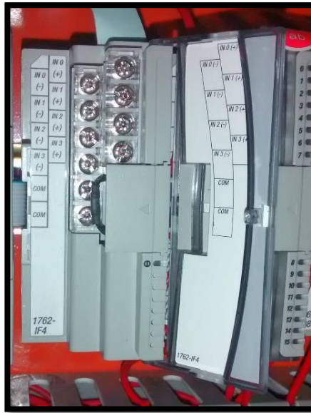
Figura 2.5: Módulo 1762 IF4. Dispositivo de expansión de 4 entradas analógicas.
