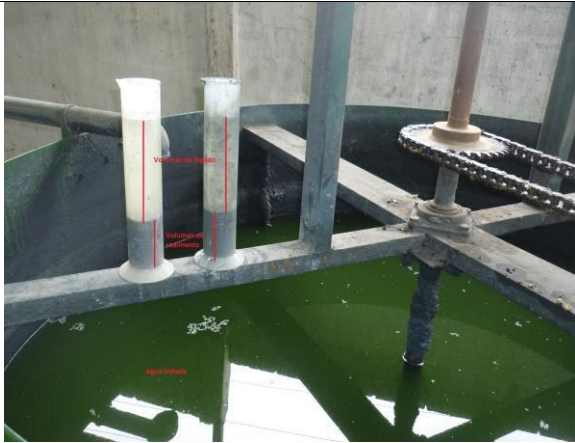
Fotografía 11.- Pruebas piloto para determinar la dosis optima
