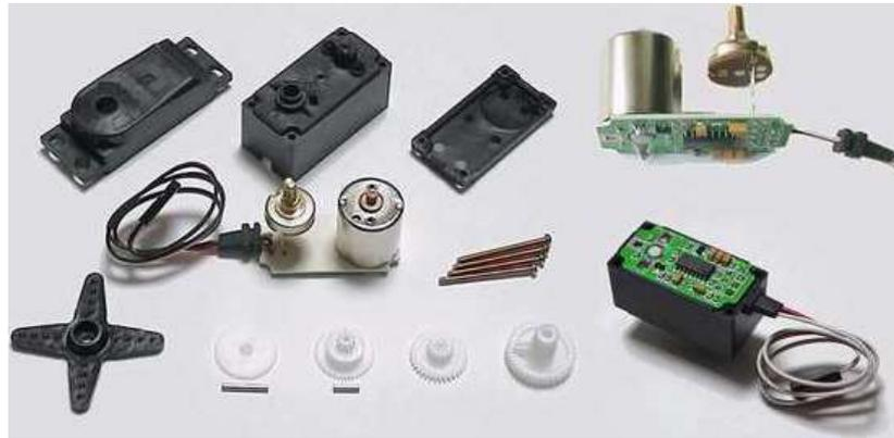
**Figura 2.13:** Piezas que conforman a un servo
