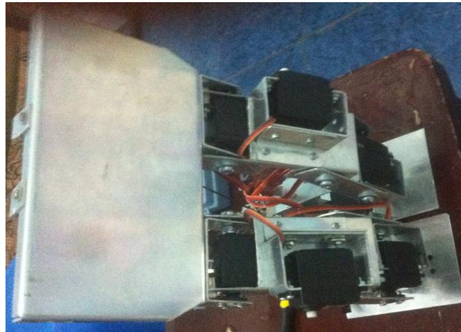
**Figura 3.84:** Piernas del robot ensambladas con la estructura principal para pruebas
