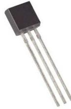
**Figura 2.48:** Sensor de temperatura LM35
