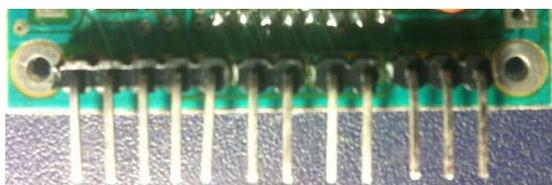
**Figura 3.44:** Pines de comunicación entre microcontrolador secundario, sensores y microcontrolador principal
