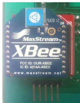
**Figura 3.22:** Módulo de transmisión inalámbrica XBEE sobre la tarjeta de control remoto
