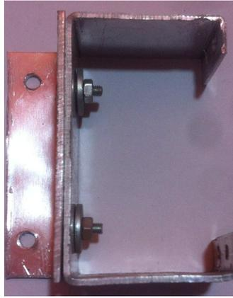
**Figura 3.74:** Aspecto físico de la pieza para acople de servomotor y rueda
