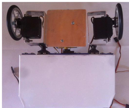
**Figura 3.54:** Piezas para giro de ruedas montadas sobre estructura principal
