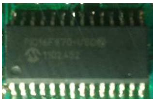
**Figura 3.42:** Microcontrolador secundario PIC16F870
