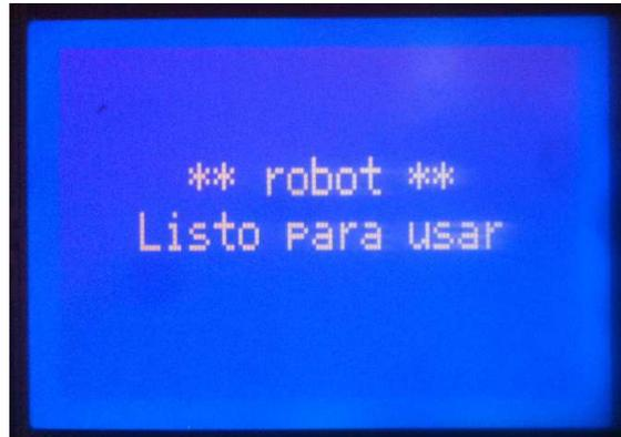
**Figura 3.31:** Mensaje indicando que existe comunicación entre el control remoto y el robot
