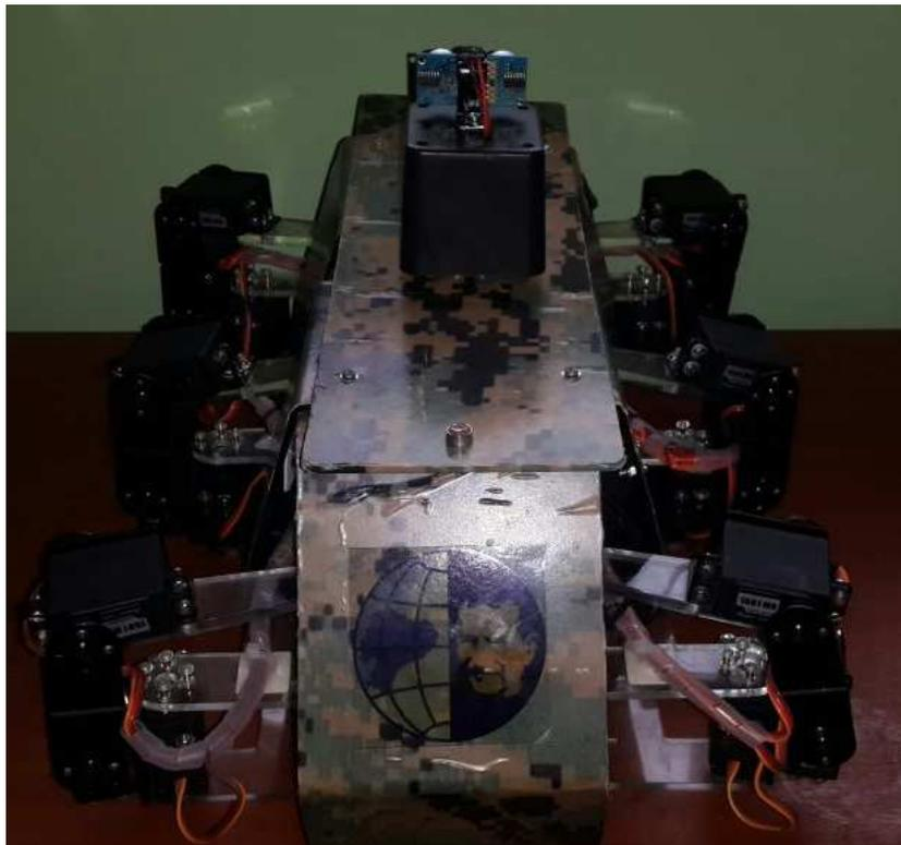
**Figura 3.97:** Robot transformer hexápodo – auto listo para ser usado
