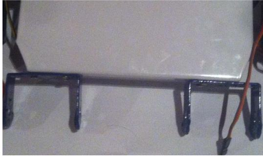
**Figura 3.68:** Ensamble de la cadera sobre la estructura principal del robot
