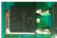
**Figura 3.43:** Regulador de voltaje LM7805-SMD en la tarjeta de control de sensores
