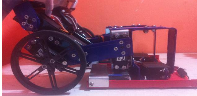
**Figura 3.85:** Ensamble de cadera, rodilla, tobillo y pie en prototipo final
