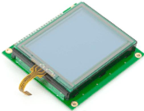
**Figura 2.28:** Panel táctil resistivo montado sobre una pantalla GLCD
