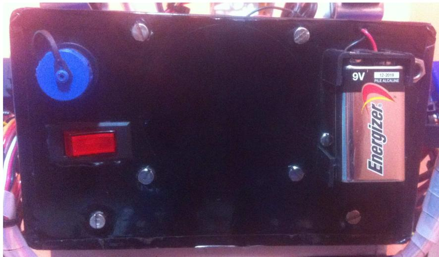
**Figura 3.64:** Vista exterior de la pieza de soporte para la electrónica de control
