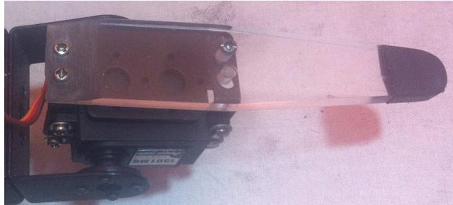
**Figura 3.91:** Pata del robot montada sobre el servomotor
