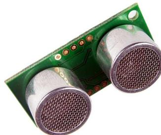
**Figura 2.43:** Aspecto físico sensor SRF05
