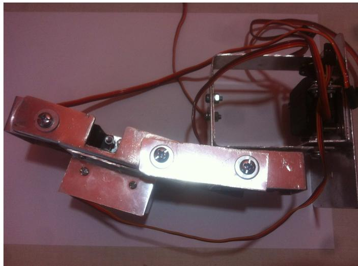
**Figura 3.66:** Aspecto físico de la pierna del robot
