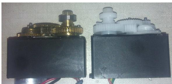
**Figura 2.15:** Caja reductora metálica y plástica
