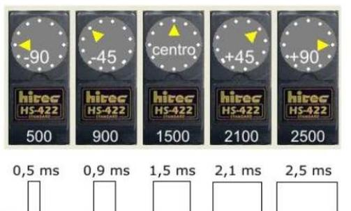
**Figura 2.16:** Posición angular del servo según su pulso de control
