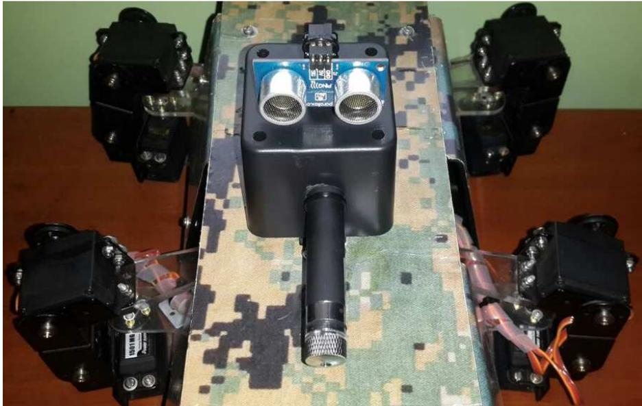
**Figura 3.95:** Aspecto físico de la tapa superior del robot hexápodo con el domo instalado sobre ella
