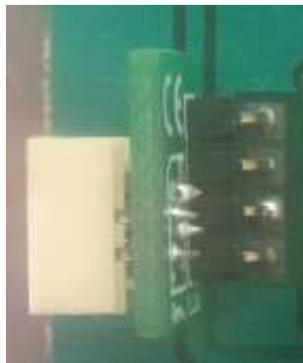
**Figura 3.24:** Conector para panel táctil resistivo
