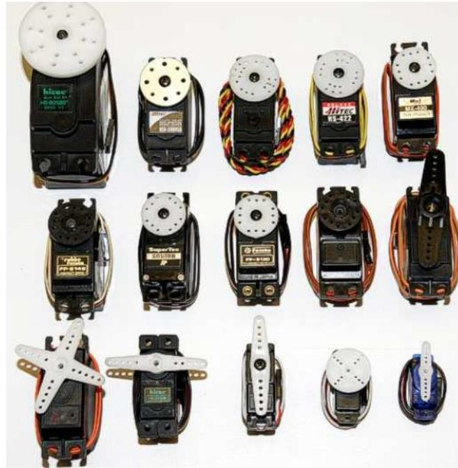
**Figura 2.11:** Diferentes modelos de servos analógicos y digitales
