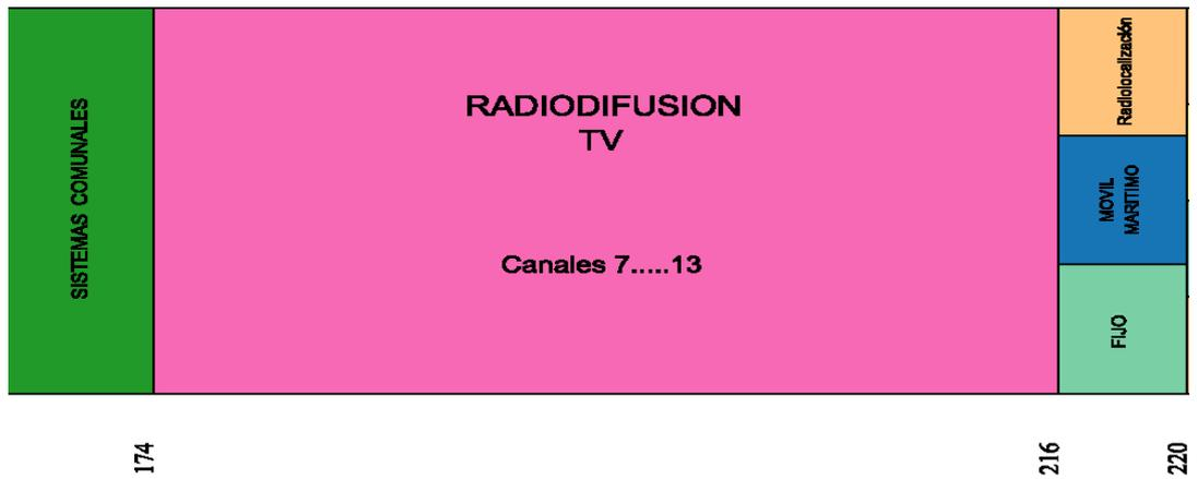
Figura 6: Banda de frecuencias para TV, frecuencia en Mhz
