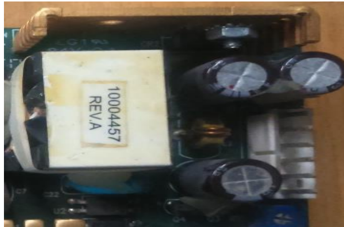
Figura 43: Vista superficial Circuito regulador de 10 VDC
