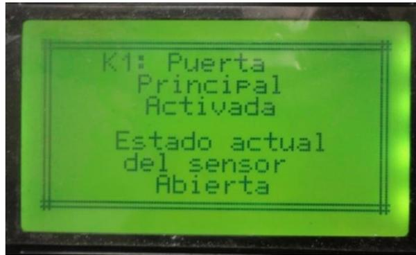
**Figura 3.43** Pantalla 4. Muestra identificación, ubicación y estado de los contactos magnéticos.
