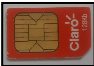
**Figura 2.16** Tarjeta SIM. Elemento que nos dará un número de identificación personal. Recuperado de <http://www.claro.com.ec/>
