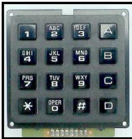
**Figura 2.10** Teclado matricial de 16 teclas. Con el teclado se tendrá la facilidad de navegar en el menú de la central de alarma. Por Reyes (2008).
