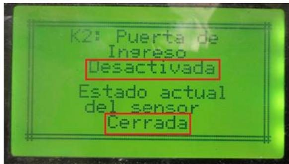
**Figura 3.44** Pantalla 5. Muestra opción a un armado parcial del sistema con los contactos magnéticos.
