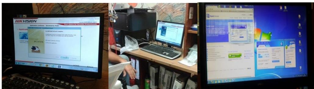
**Figura 3.35** Instalación de programas hikvision y del teamviewer. Se utilizó el programa SADP y IVMS-400 para detección automática de IP y visualización de las cámaras respectivamente, además Team Viewer para la visualización remota.
