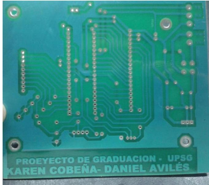
**Figura. 3.21** Diseño de placa esclavo impresa en fibra de vidrio doble lado. Placa esclavo impresa en fibra de vidrio de 12.3cm x 10.8 cm.
