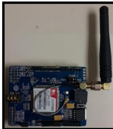
**Figura 2.18** Modem GSM, Modem instalado en la central de alarma.
