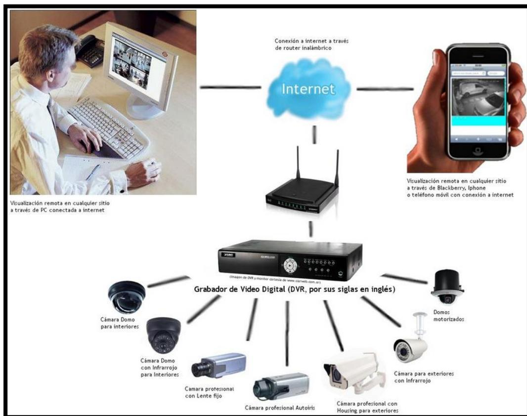
**Figura 2.2** Esquema de un circuito cerrado de televisión. Con la instalación de este esquema se podrá monitorear las áreas necesarias. Por Chang (2010). Recuperado de <https://techhard.wordpress.com/productos/circuito-cerrado-de-tv/>
