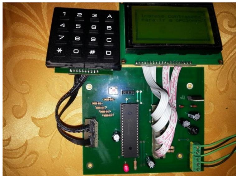
**Figura. 3.22** PCB Placa esclavo. Placa esclavo ensamblada con sus respectivos componentes.
