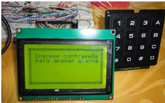
**Figura 3.6** Prueba de GLCD y teclado en protoboard. Prueba de adquisición de datos con la GLCD y teclado.
