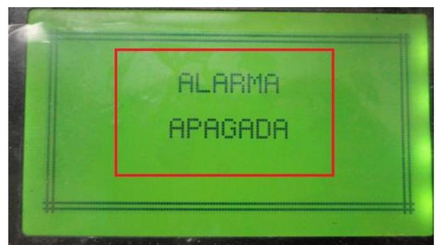
**Figura 3.58** Pantalla de apagado manual. Muestra la opción de apagar la alarma desde la central de alarma.
