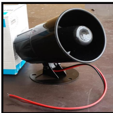
**Figura 2.14** Alarma sonora. La alarma sonora será una de las encargada de dar un aviso instantáneo al momento de activarse algún equipo.
