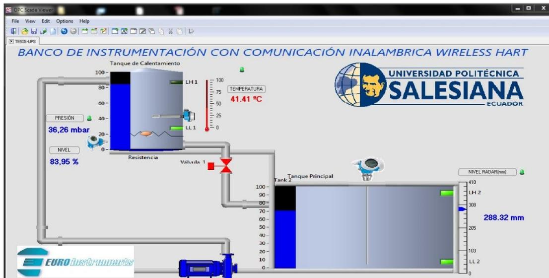
**FIG 3. 46 VISUALIZACIÓN DE VALORES EN OPC SCADA WIEVER**
