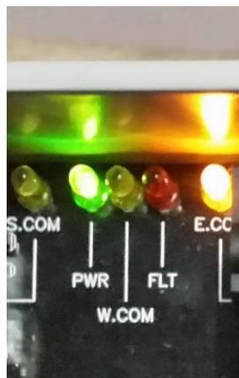
**FIG 3. 30 FIELDGATE SWG70 ENCENDIDO**
