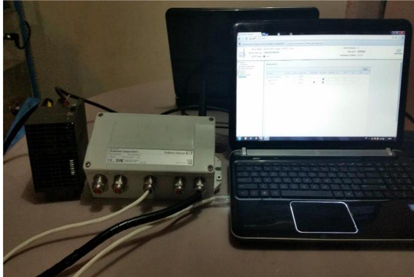
**FIG 3. 21 UBICACIÓN DE LOS FIELDGATE WIRELESSHART EN BANCO DE PRUEBA.**
