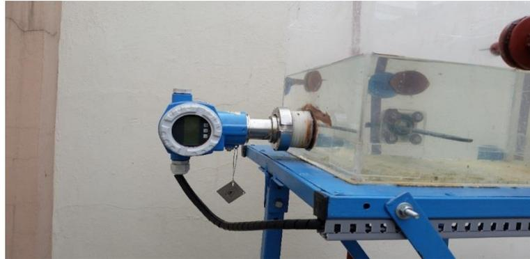
**FIG 3. 14 UBICACIÓN DE TRANSMISOR DE PRESIÓN EN TANQUE DE CALENTAMIENTO DE AGUA**
