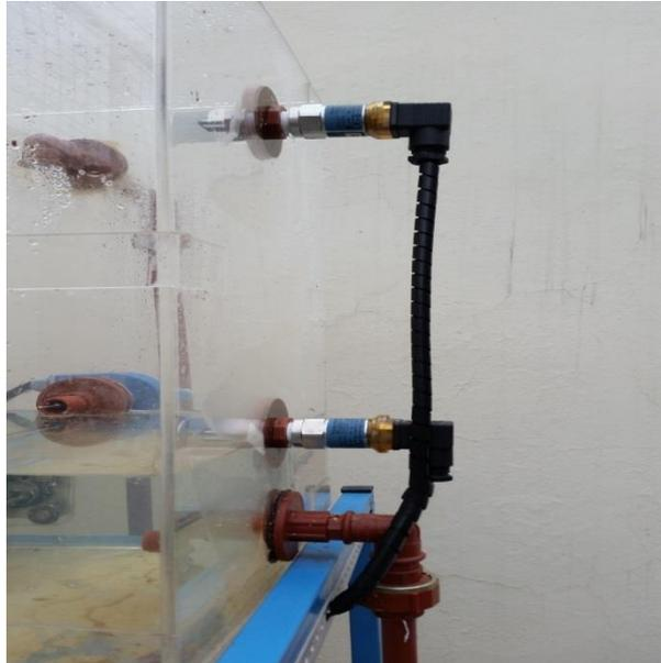
**FIG 3. 18 UBICACIÓN DE SWITCH DE NIVEL TIPO VIBRATORIO EN TANQUE DE CALENTAMIENTO DE AGUA**
