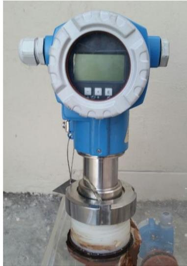
**FIG 3. 4 TRANSMISOR DE PRESIÓN HIDROSTÁTICO**
