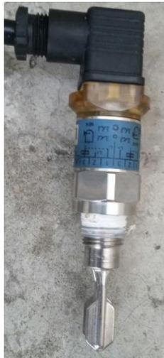
**FIG 3. 5 SWITCH DE NIVEL PUNTUAL**
