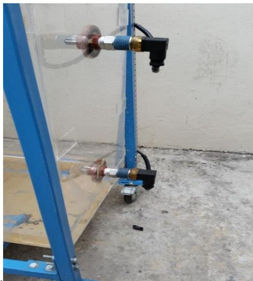
**FIG 3. 17 UBICACIÓN DE SWITCH DE NIVEL TIPO VIBRATORIO EN TANQUE I**
