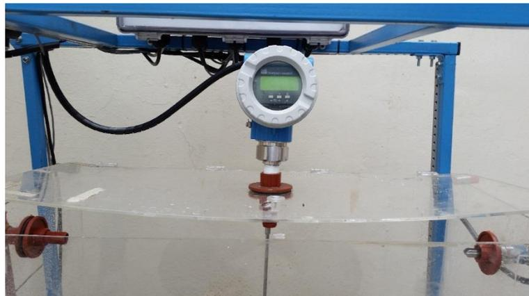
**FIG 3. 13 UBICACIÓN DE TRANSMISOR DE NIVEL TIPO RADAR EN TANQUE DE ALMACENAMIENTO DE AGUA**
