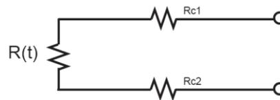
**FIG 2. 6 CONEXIÓN A 2 HILOS**
