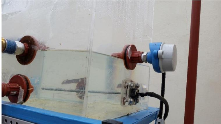
**FIG 3. 16 UBICACIÓN DE SENSOR DE TEMPERATURA II EN TANQUE DE CALENTAMIENTO DE AGUA**
