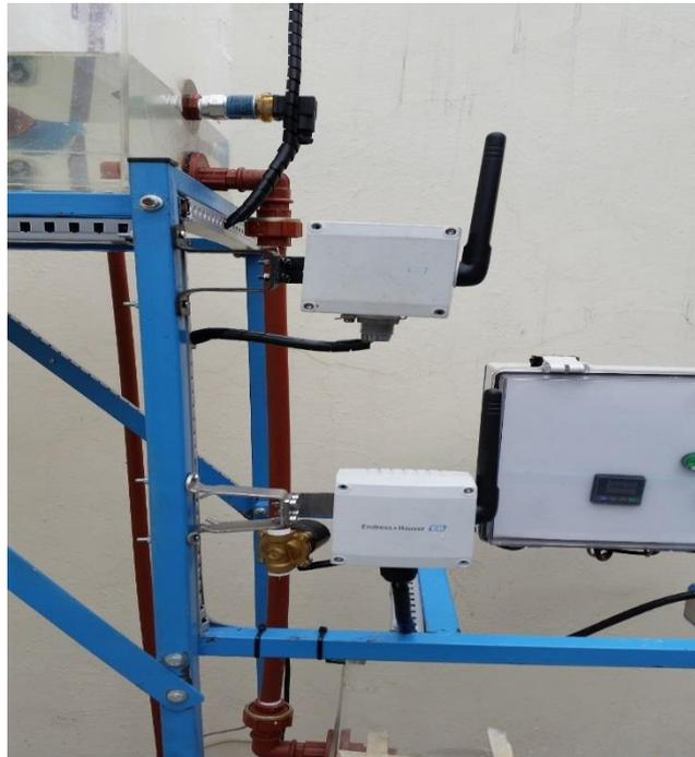
**FIG 3. 20 UBICACIÓN DE LOS ADAPTADORES WIRELESSHART EN BANCO DE PRUEBA.**
