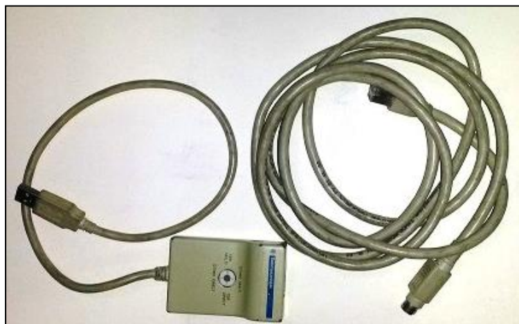
Figura 15. Convertidor RS485-USB. Utilizado para las descargas de programas y monitoreo de las variables. (Schneider Electric, 2011)
