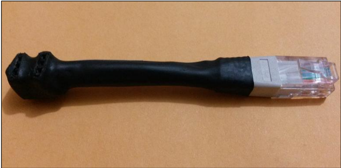
Figura 19. Adaptador RJ-45/Bornera. Solo se utilizan tres hijos, D1, D0 y GND. Se colocó termoencogible para protección.
