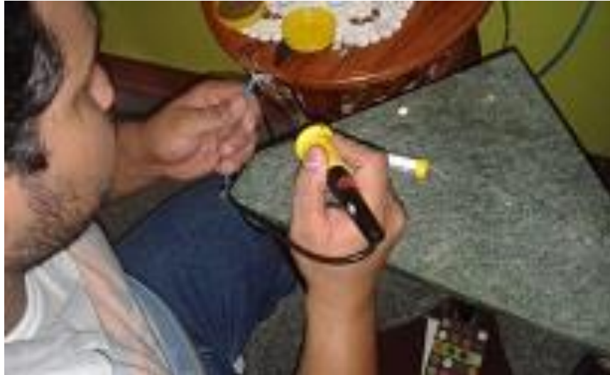
Anexo 7: Soldadura de Conectores USB macho Fuente: Los Autores
