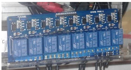
Figura 3.2.3.1: Módulo de Relé de 8 Canales
