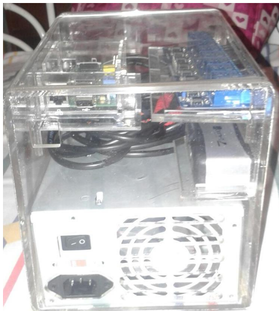
Figura 3.2.3.1: Fuente de Poder de 800 w
