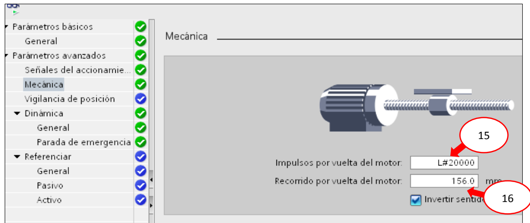
Figura 3. 28 Ajustes de los valores de mecánica del eje del rodillo de arrastre inferior. (El Autor)
