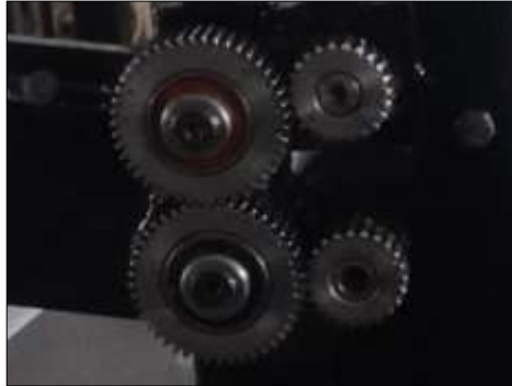
Figura 3. 7 Relación de transmisión 1:1 de piñones. (El Autor)
