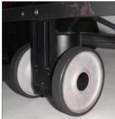
Figura 3. 14 Encoder incremental tipo rueda. (Hangyoung nux, 2013)
