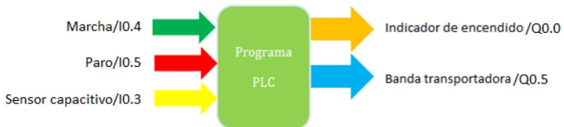
Figura 4 Entradas y salidas práctica 1. Se describe las entradas y salidas utilizadas.
