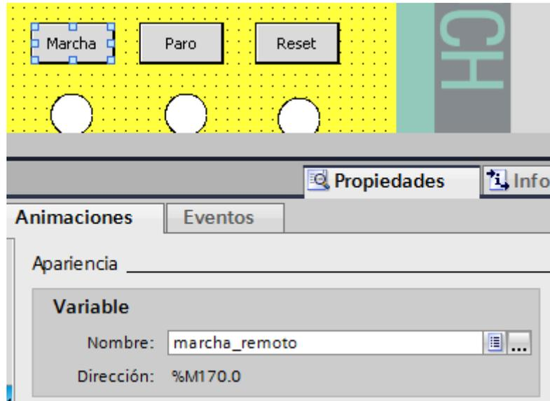
Figura 4. 46 Configurar elementos. En las propiedades de elementos vamos asociar a las variables del PLC.
