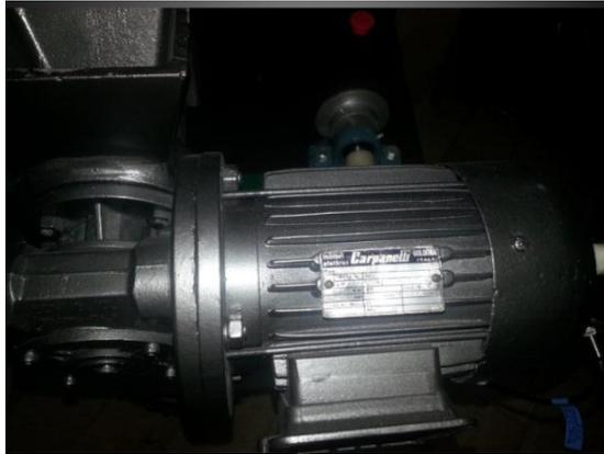
Figura 3. 33 Motor para la dosificación. Este motor se encuentra acoplado a un motor reductor para disminuir la velocidad del tornillo sin fin.
