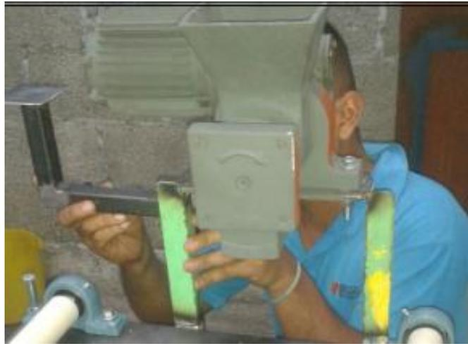
Figura 3. 20 Base para el codificador rotatorio. Se colocan las bases para el codificador rotatorio que va acoplado al motor.
