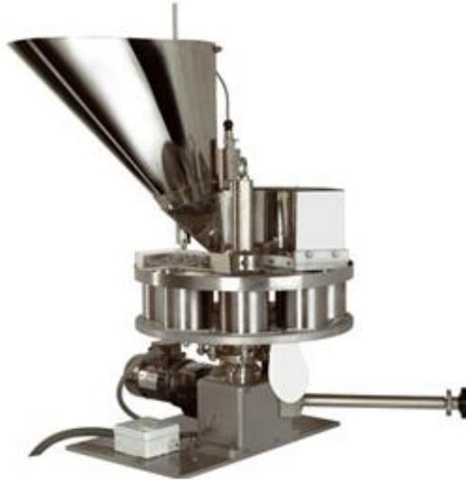
Figura 2. 1 Dosificador volumétrico. Equipo especialmente diseñado para envasar productos de granulometría uniforme. Mecalux, (2013). Recuperado de <http://www.logismarket.com.mx/equipenvas/dosificador-volumetrico/3014156838-1233087939-p.html>.
