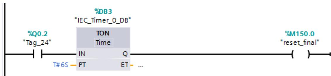
Figura 59 Reset de final de proceso. Cuando la dosificación termine, se espera un tiempo y luego se resetea los valores.
