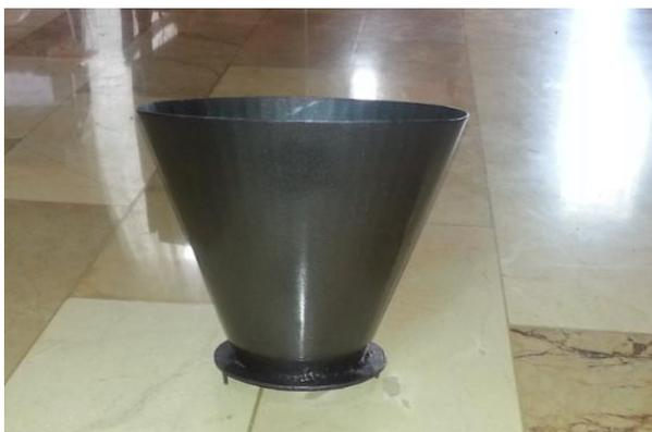
Figura 3. 26 Tolva de dosificación. Tolva de dosificación en forma de cono truncado
