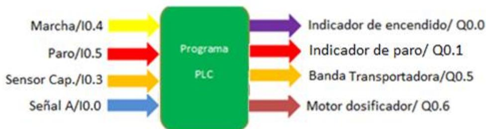
Figura 48 Entradas y salidas práctica 6. Se describe las entradas y salidas utilizadas.
