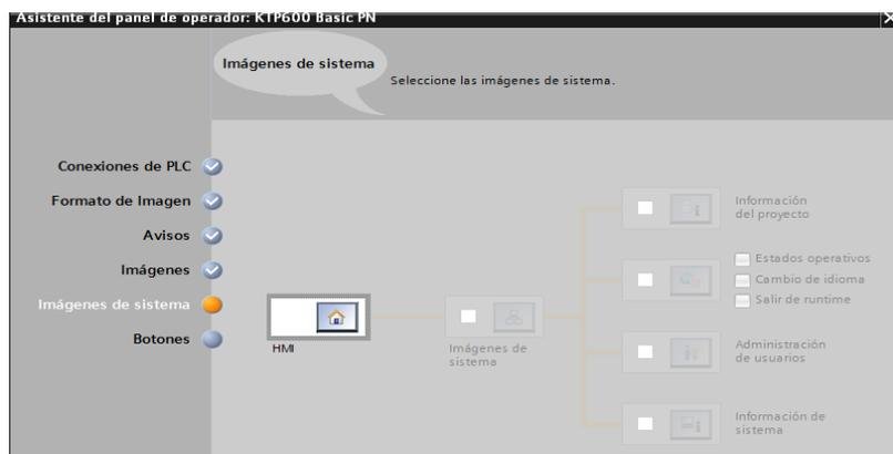
Figura 4. 43 Imágenes del sistema. Podemos seleccionar las imágenes que tendrá el HMI.
