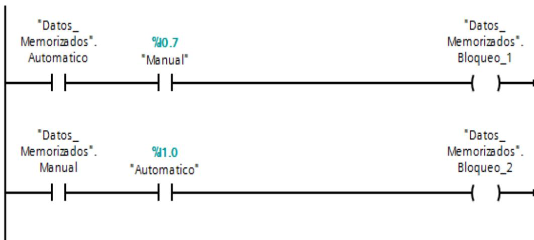
Figura 4. 16 Segmento condición de bloqueo. Segmento de bloqueo, cuando se active uno de los 2 relés el sistema se quedara en stop.
