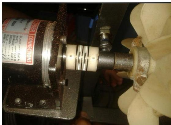
Figura 3. 32 Encoder incremental acoplado al motor. El codificador rotatorio nos indica el número de giros que se está realizando.
