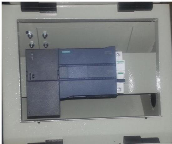
Figura 3. 11 Montaje de los equipos en el riel DIN. En el riel se ubica la fuente de 24v, el PLC, y el breaker.
