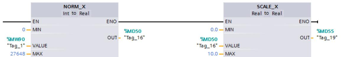
Figura 12 Escalar señal analógica. El valor de la señal analógica estará en un rango de 0 a 10.
