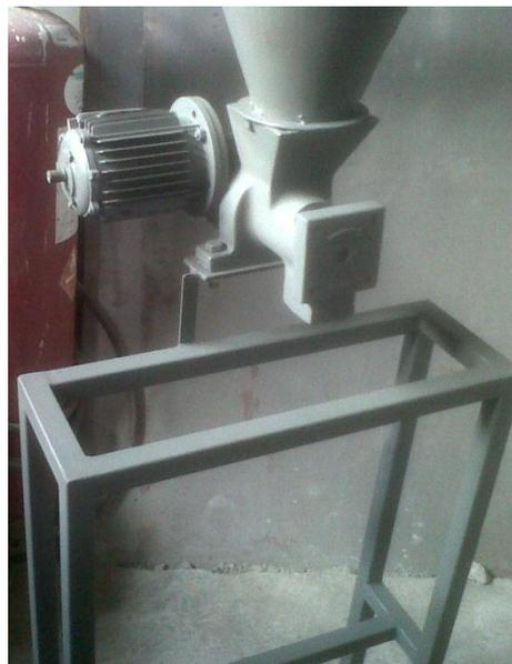
Figura 3. 19 Base de la estructura. La tolva de dosificación está soldada a la base de la estructura.
