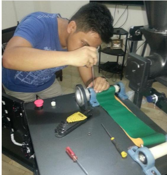
Figura 3. 27 Ajuste de los rodillos. Se ajusta con una llave allen los rodillos, para que queden fijos en la chumacera.
