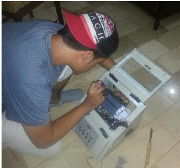
Figura 3. 15 Cableado del PLC. Para el cableado del PLC se usa un destornillador tipo bornera.
