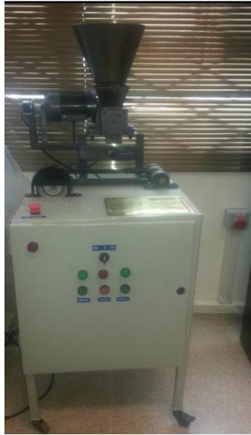
Figura 3.36 Módulo de dosificación. En este módulo los estudiantes podrán realizar prácticas de dosificación de granos.
