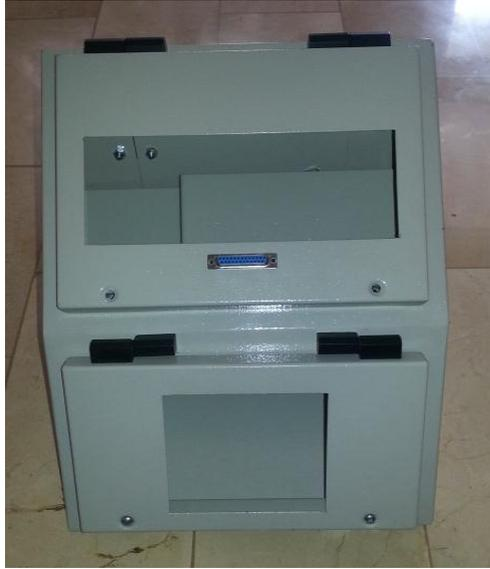
Figura 3. 4 Estructura del módulo vista frontal. Las puertas del módulo se encuentran atornilladas para que se evite su manipulación.
