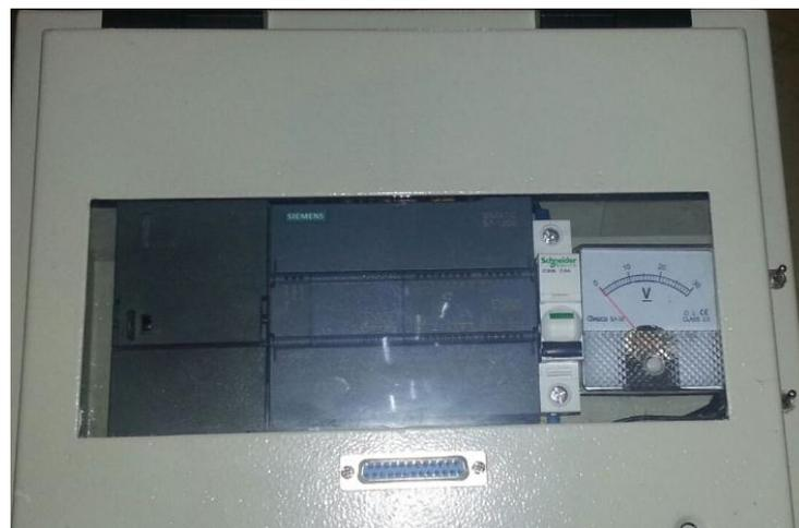
Figura 3. 13 Los elementos del módulo a través del visor. Se puede observar el galvanómetro a través del visor y también la activación de entradas y salidas del PLC.
