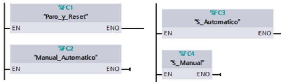
Figura 4. 24 Main principal. Se llaman a los bloques de funciones “paro y reset” y “manual-automático”, ”S\_Automatico”, ”S\_Manual”.
