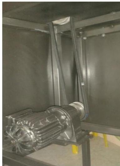
Figura 3. 34 Motor para la banda transportadora. Al igual que el motor de dosificación este va acoplado a un motor reductor para disminuir la velocidad de la banda transportadora.
