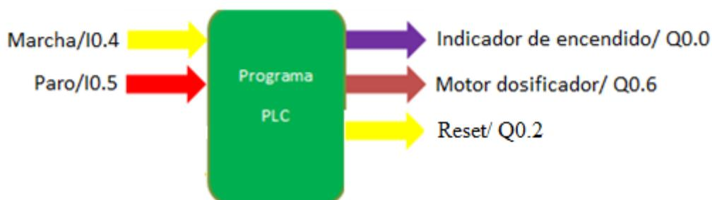
Figura 14 Entradas y salidas práctica 3. Se describe las entradas y salidas utilizadas.
