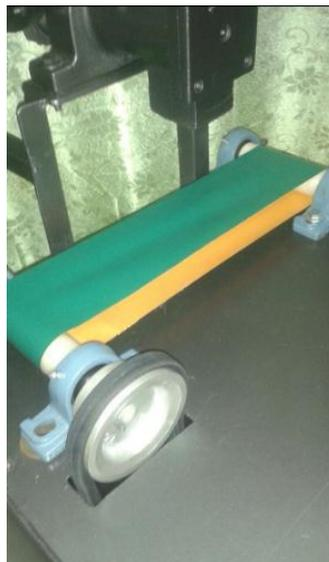
Figura 3. 28 Banda transportadora del módulo. Se deja la banda templada para que no existan rodamientos del recipiente.
