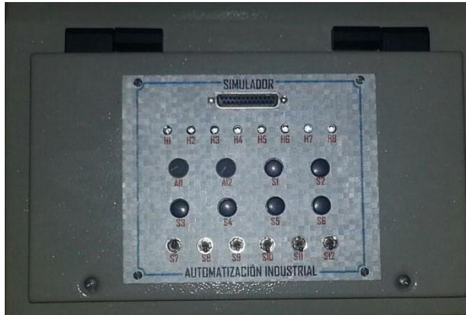
Figura 3. 12 Tarjeta de control. La tarjeta de control nos permite simular entradas y salidas.
