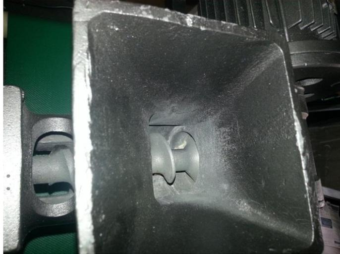
Figura 3. 29 Tornillo sin fin. Cuando el tornillo sin fin empiece a girar el producto que este dentro de la tolva empezará a salir.
