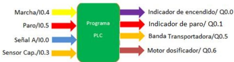
Figura 35 Entradas y salidas práctica 5. Se describe las entradas y salidas utilizadas.
