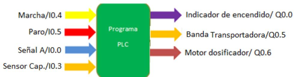
Figura 22 Entradas y salidas práctica 4. Se describe las entradas y salidas utilizadas.
