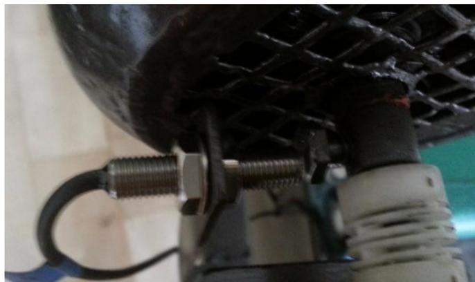
Figura 3. 30 Sensor inductivo. La función del sensor inductivo es el reseteo al codificador rotatorio.
