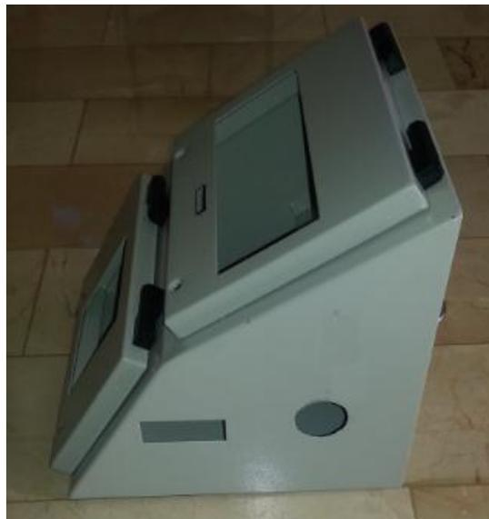
Figura 3. 5 Estructura del módulo vista lateral. Se muestra los espacios en donde se ubicara el puerto de conexión Ethernet y la salida analógica.
