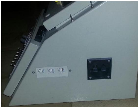
Figura 3. 14 Vista lateral derecha del módulo PLC. En la parte lateral se encuentra el puerto para la comunicación del módulo y la bornera para la salida analógica.
