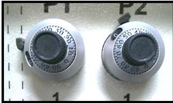
Figura 2.17: Potenciómetro de 5k - 10 vueltas
