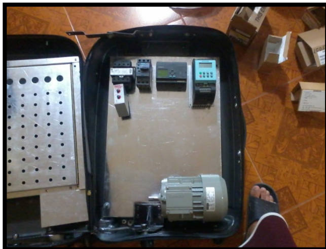
Figura 3.2: Módulo Didáctico, lámina de ubicación de equipos
