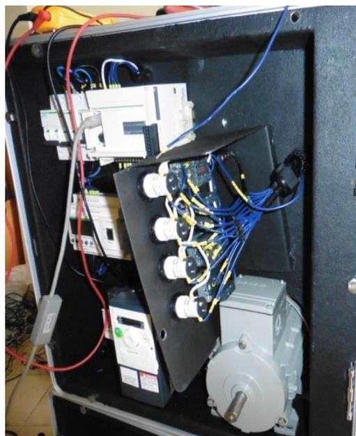
**Figura 3.18** Ensamblaje del soporte de pulsadores y luces.
