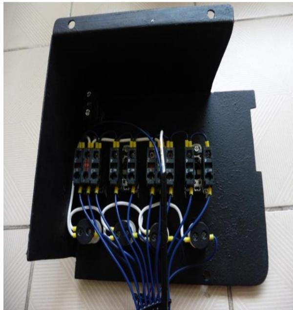
**Figura 3.15** Cableado de pulsadores y luces.
