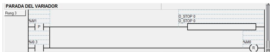
**Figura 4.27** Programación de parada del motor.
