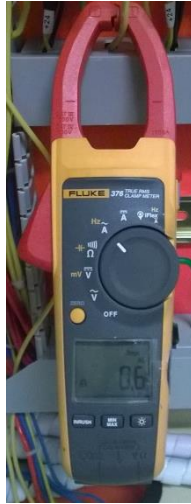
Figura 83: Amperímetro de Gancho DC y AC Fuente: Laboratorio de Motores y Generadores
