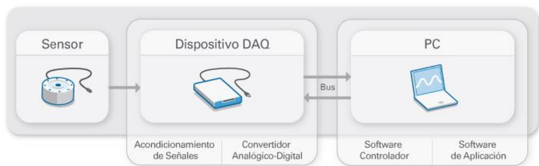
Figura 3: Estructura de Adquisición de Datos Electromecánicos.
