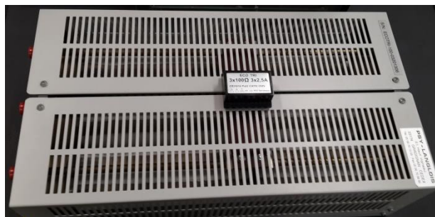
Figura 84: Carga Resistiva Variable Fuente: Laboratorio de Motores y Generadores
