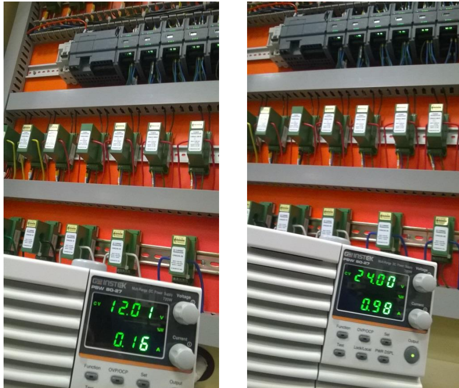
Figura 78: Prueba de Consumo de Corriente de los Transductores de 12VDC y 24VDC
