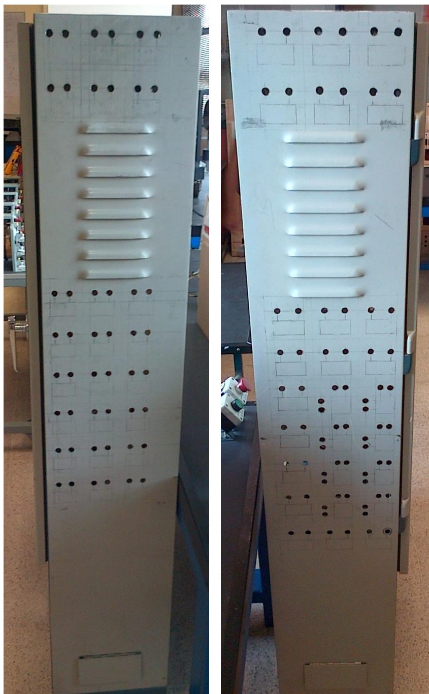
Figura 30: M.A.P.P.E. Perforación de los respectivos orificios para las borneras. Vista lateral derecha y Vista lateral izquierda, respectivamente.
