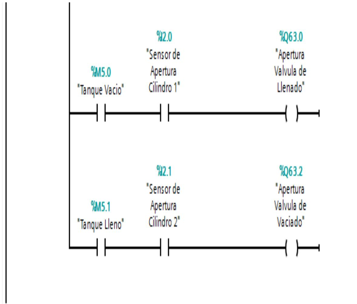
Figura 3. 44 Sensores y Salidas. Control de apertura de válvulas y accionamiento de salidas
