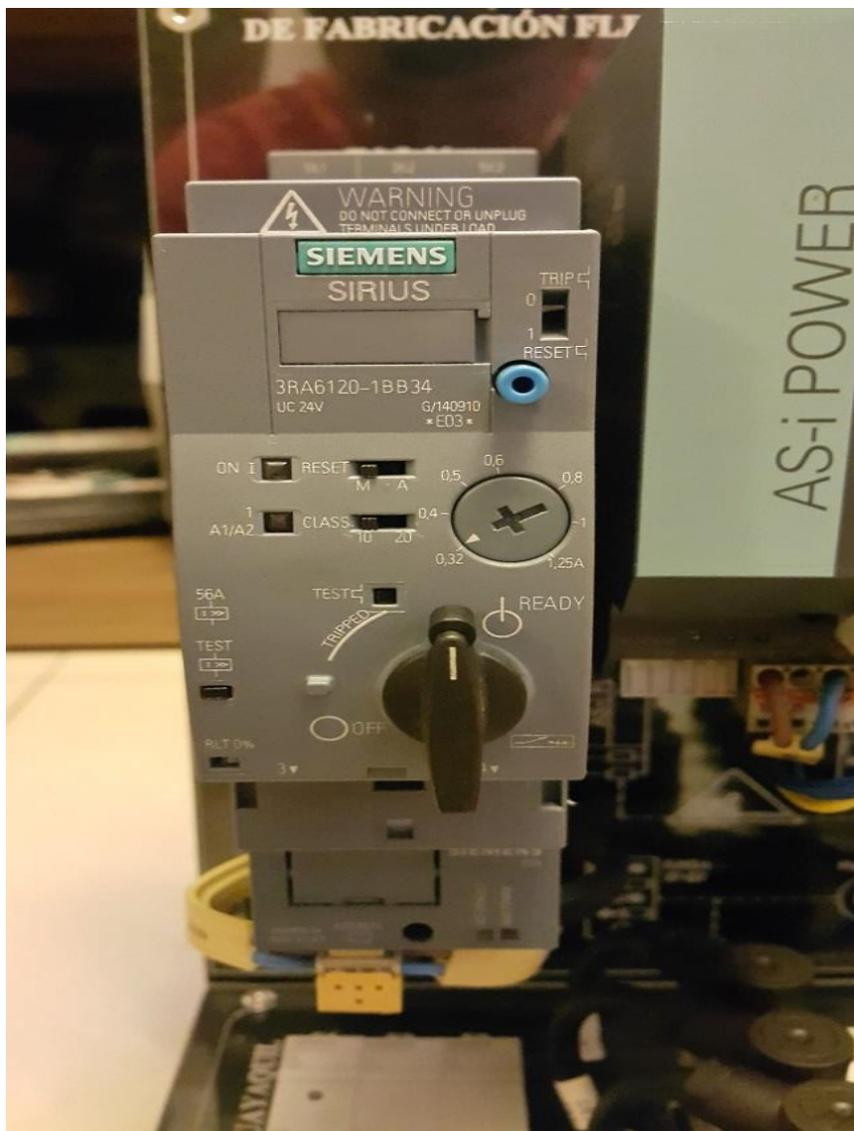
Figura 3. 10 Contactor AS-i. Contactor AS-i junto a la fuente de tipo AS-i
