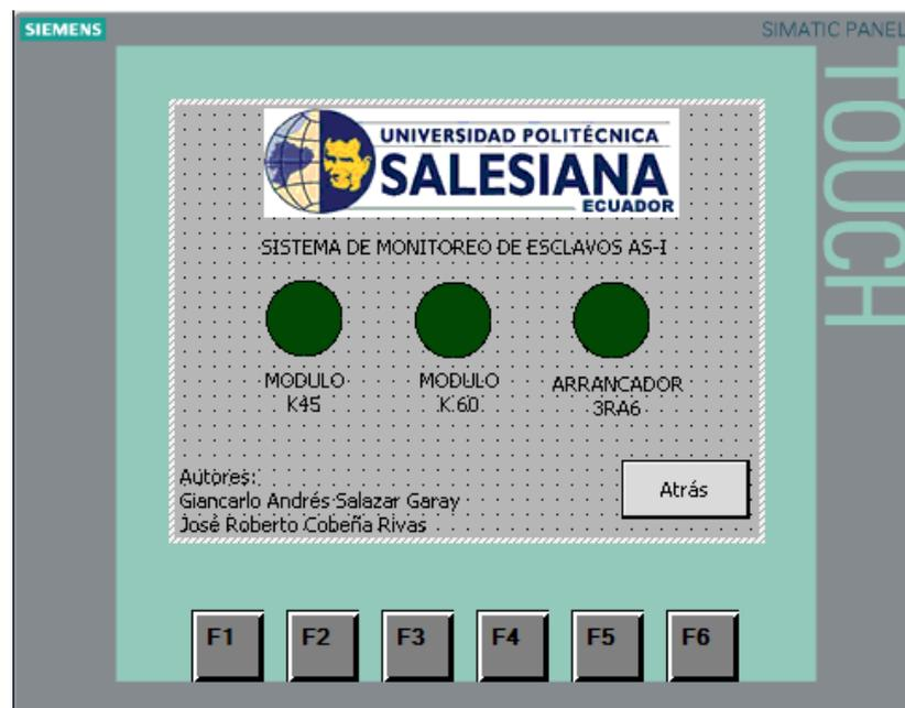
La ultima pantalla es la de Diagnostico en la cual podemos visualizar los 3 nombres de los 3 esclavos conectados a la red AS-i, y confirmar que su conexión es la adecuada, asi como tambien si se genera alguna desconexion en uno o varios de ellos pues el indicador empezara a parpadear señalando que ha sido o han sido desconectados los esclavos AS-I.
