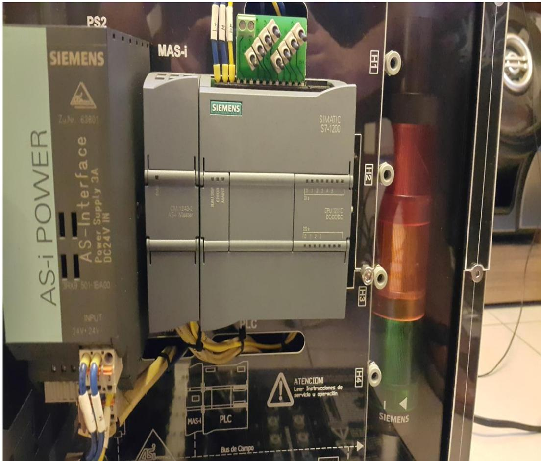
*Figura 3. 2 PLC S7-1200 PLC S7-1200 montado en el módulo de entrenamiento*
