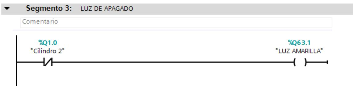
Figura 3. 48 Luz de Apagado. Indicador amarillo de apagado
