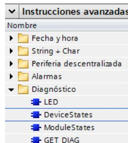
En este bloque podremos ingresar en el parametro **LADDR** la direccion de BUS AS-I que se genera cuando creamos la red (401), esta direccion la encontramos en la tabla de variables estandar del PLC en Constantes del Sistema.
