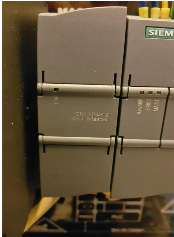
*Figura 3. 3 Módulo AS-i Master. Maestro AS-i junto al PLC S7-1200 en el módulo de entrenamiento.*
