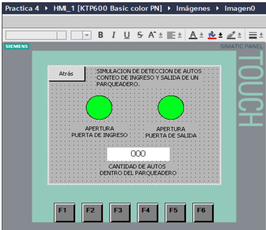
Figura 3. 56 Pantalla principal. Simulación de detección de autos, por conteo de ingreso y salida.
