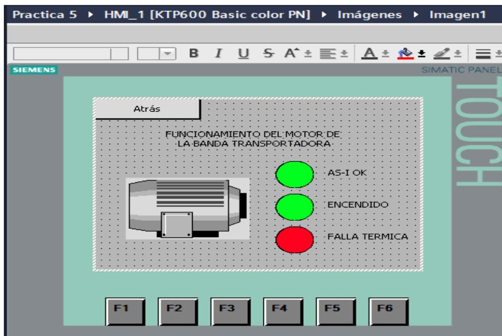
Si el motor está en funcionamiento estará el led verde encendido caso contrario se encontrará apagado o en un verde más oscuro, el tercer led permite saber si el motor sufre una sobre corriente y por esta razón el contactor AS-I detendría el funcionamiento total y mostraría una luz roja indicando que esta no está funcionando el motor porque se ha detenido.
