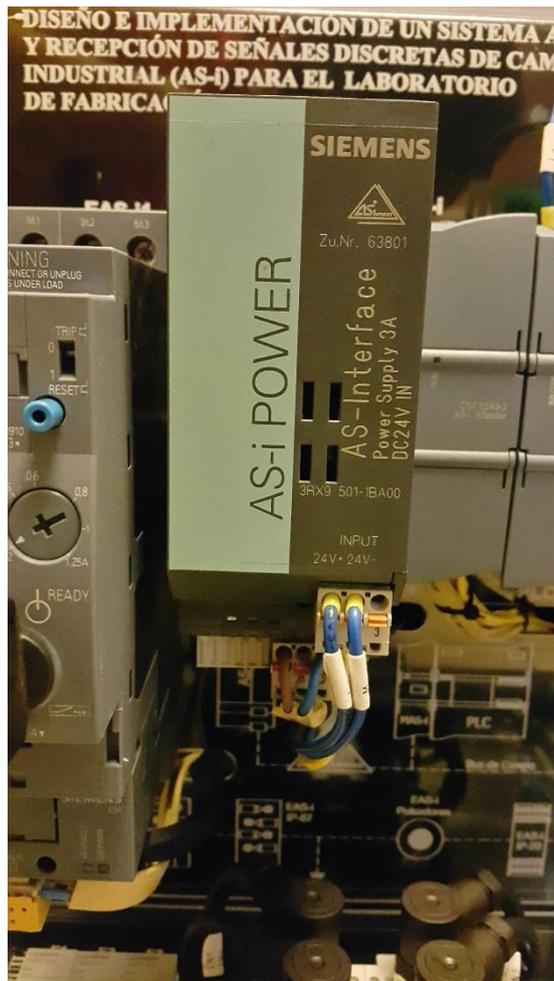
*Figura 3. 4 Fuente AS-i. Fuente AS-i montada en el módulo de entrenamiento.*
