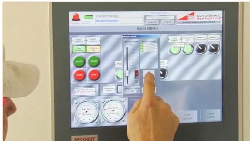
*Figura 2. 4 Sistema SCADA como nivel de supervisión. Sistema SCADA como controlador de gama alta involucrado en control de calidad en un sistema de horneado. (Auto-Bake, 2014)*
