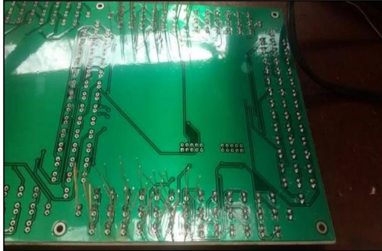
Figura 17. Placa para número con LEDS: parte posterior elementos soldados
