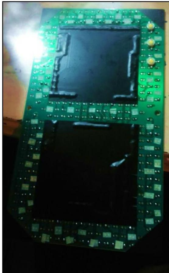
Figura 18. Placa para número con LEDS: Inicio de colocación de LEDS
