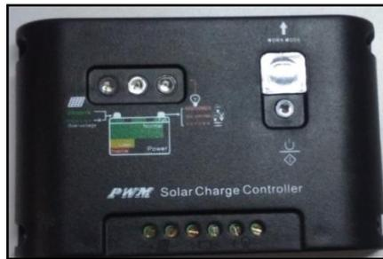
Figura 10. Regulador marca PWM: empleado para el sistema fotovoltaico
