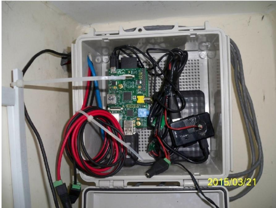
**Figura 3.40** : Vista del Proyecto Instalado. La imagen se observa las Raspberry dentro del armario ya instalado.
