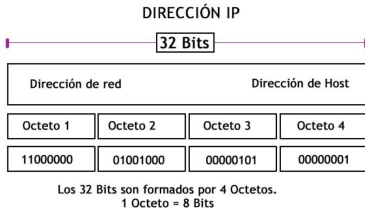
**Figura 2.18 :** Protocolo IP. Las direcciones ip tienen 32 bits, divididas en dos partes la dirección de red y la dirección de host, dividida en 4 octetos cada octeto representado por un grupo de 8 bits, son representados por un decimal que va del 0 al 255 separados por un punto (Boquera, 2003)
