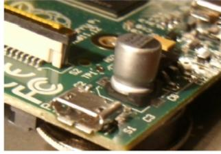
**Figura 2.10 :** Entrada Micro USB. Aquí se puede observar en conector de entrada para la alimentación micro-USB. (Gay, 2013)
