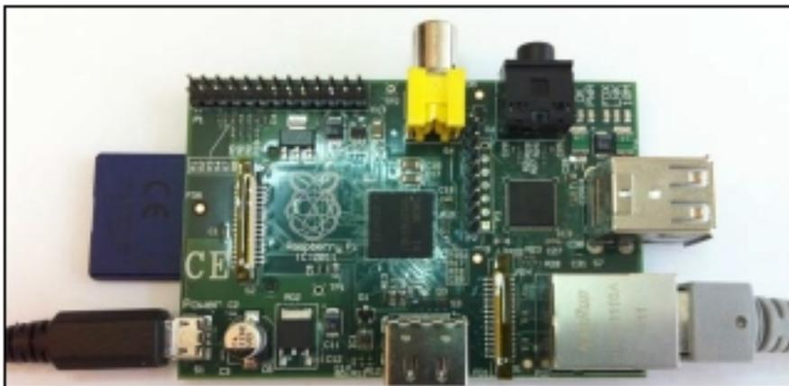
**Figura 2.5 :** Raspberry Pi. En esta figura se puede observar las Raspberry Pi, que es un dispositivo que trabaja con distribuciones Linux, donde el arranque de este sistema operativo es desde una tarjeta SD. (Golden, 2013)
