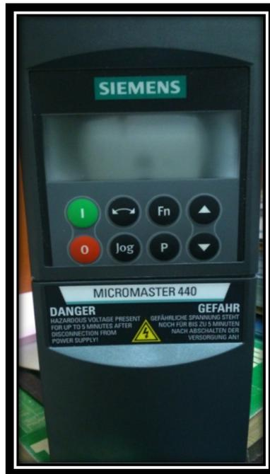
**Figura 2.1.3. Variador Micromaster 440 Siemens.**
