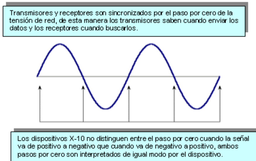
Figura 34: Transmisión de mensajes Insteon en el cruce por cero
