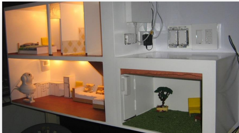
Figura 57: módulo Domótico con control de iluminación desde el keypadlinc
