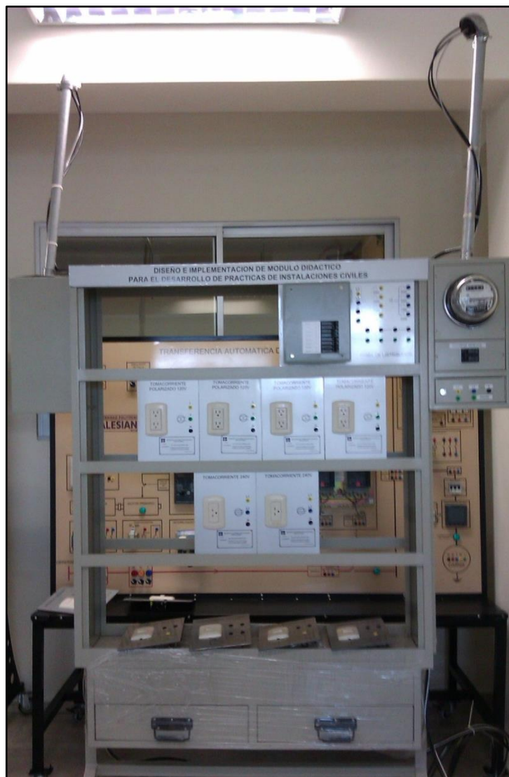
Figura 50: Imagen donde se muestra la colocación de las láminas didácticas en la estructura metálica. En la segunda repisa se ubican los tomacorrientes polarizados de 120VAC y en la tercera repisa (de arriba – abajo) los tomacorrientes 240VAC.
