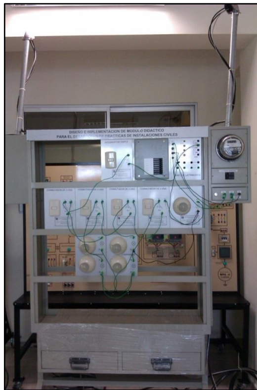
Figura 47: imagen donde se muestra la conexión del circuito de las cinco lámparas en cascada.
