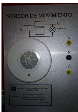
Figura 72: La imagen muestra la lámina de sensor de movimiento, con su diagrama de conexión y sus borneras (L, N, C).
