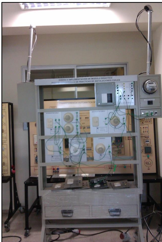
Figura 73: Imagen donde se muestra las conexiones de la práctica, antes de energizar el circuito.
