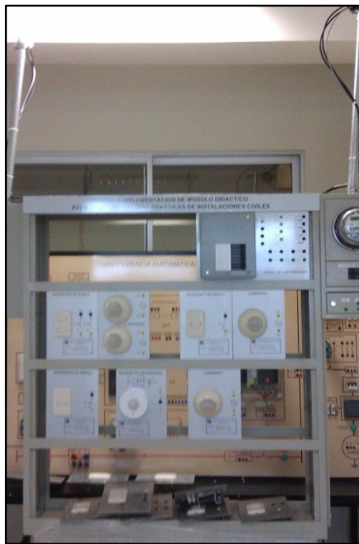
Figura 70: Imagen donde se muestra la forma de colocar las láminas didácticas, en la práctica, evitando el uso innecesario de cables de conexión.
