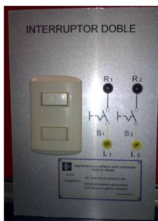
Figura 71: Imagen de la lámina de Interruptor Doble, se aprecia la instalación del dispositivo eléctrico, la identificación de cada uno de sus bornes y la respectiva simbología eléctrica.
