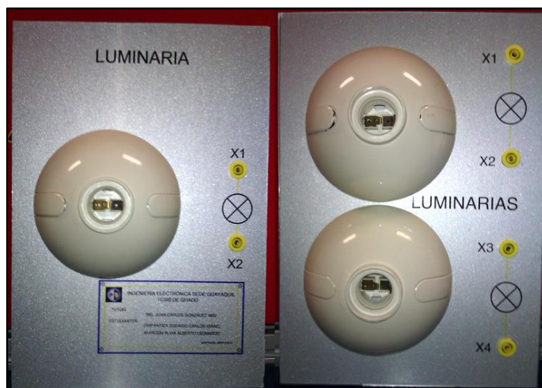
Figura 46: Imagen de las láminas Luminarias, conocidas como portalámparas o rosetones, se aprecia el elemento eléctrico y sus simbologías.
