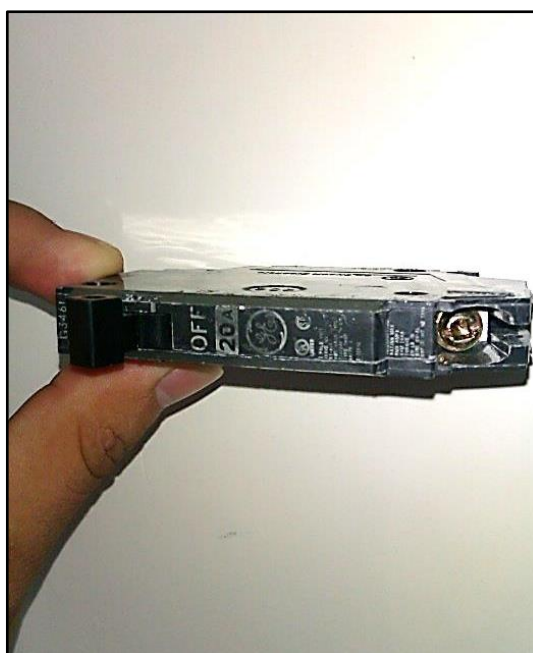
Figura 29: Disyuntor THQP General Electric empleado. Dispositivo de protección contra sobrecargas y cortocircuitos para los circuitos de prueba.
