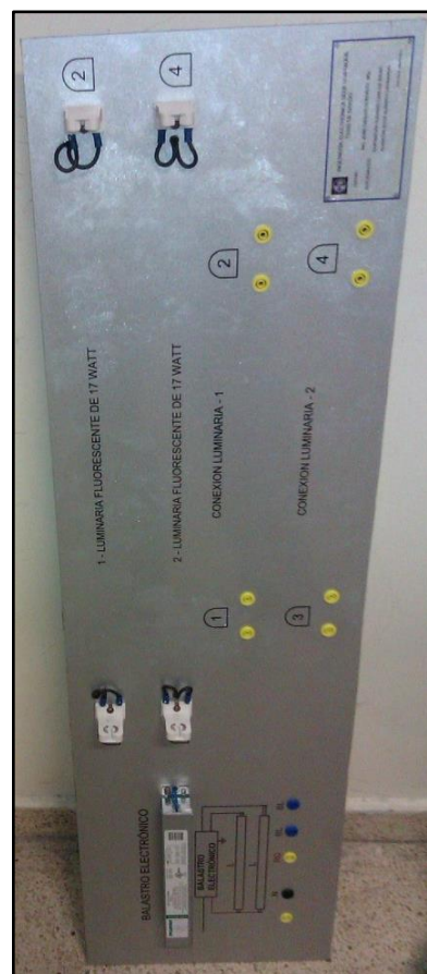
Figura 39: Imagen de una de las Láminas de Lámpara Fluorescente, donde se observa la instalación del dispositivo y los elementos eléctricos, la identificación de cada uno de sus bornes y su simbología eléctrica.
