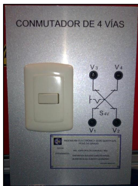
Figura 58: Conmutador de 4 vías, compuesto por cuatro bornes (V1, V2, V3, V4) llamados “viajeros”.
