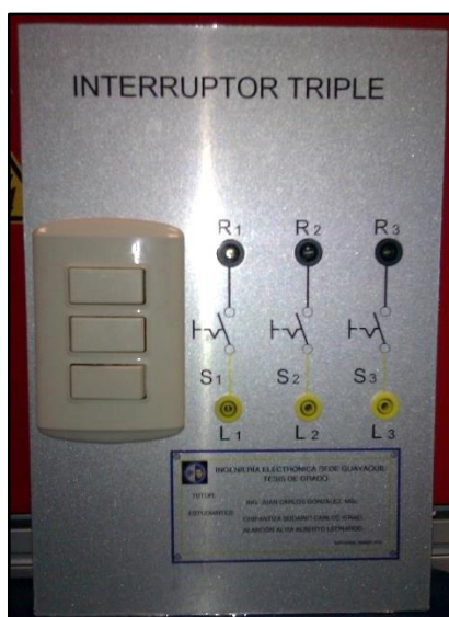
Figura 38: Imagen de la lámina de Interruptor Triple, donde se aprecia la instalación del dispositivo eléctrico, la identificación de cada uno de sus bornes y la respectiva simbología eléctrica.
