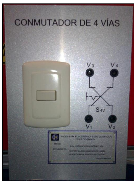
Figura 65: Conmutador de 4 vías, compuesto por cuatro bornes (V1, V2, V3, V4) llamados “viajeros”.
