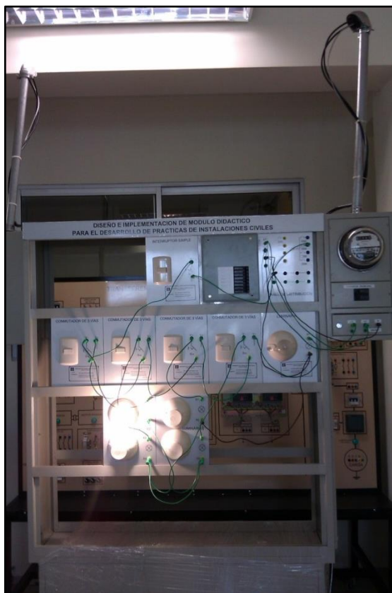
Figura 48: Imagen donde se muestra funcionamiento del circuito, encendido de la luminaria 1.
