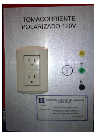
Figura 51: Imagen de lámina de Tomacorriente Polarizado 120VAC, Se aprecia su simbología eléctrica y sus bornes respectivos.
