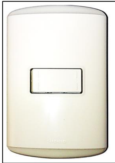
Figura 33: Interruptor Conmutador de 3 vías 10A, 127V / 250 ~. Interruptor utilizado para los circuitos de conmutación, en el control de encendido y apagado de luminarias en dos, tres y cuatro sitios distintos.
