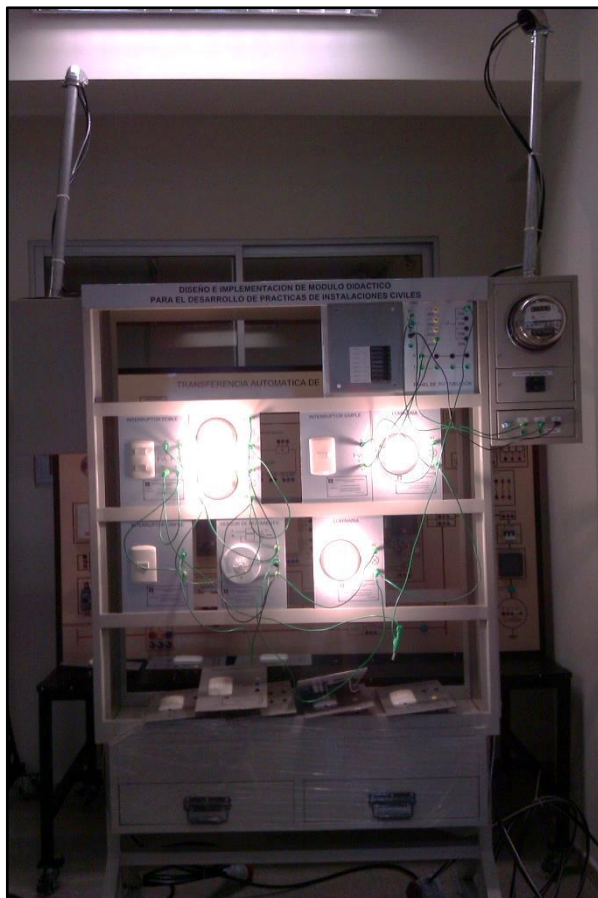
Figura 74: En la imagen se aprecia la activación de cada una de las luminarias que forman parte de los tres circuitos de la práctica 6.
