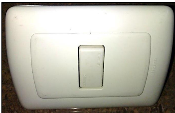
Figura 34: Interruptor Conmutador de 4 vías 16A, 60 Hz, 127V / 250 / 275 ~. Interruptor utilizado para los circuitos de conmutación, en el control de encendido y apagado de luminarias en dos, tres y cuatro sitios distintos.
