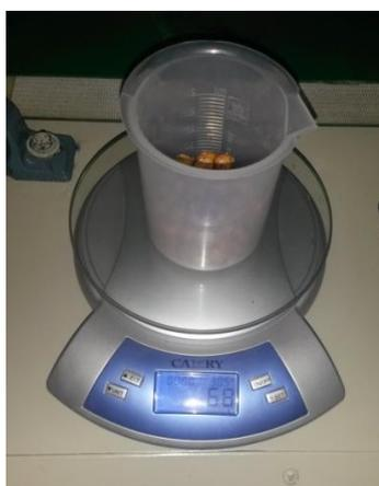
**Figura 132.-** Peso en gramos de muestra número 16. Toma de medida en gramos de una de las 25 muestras de la prueba del número de vueltas.
