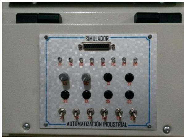
**Figura 44.-** Tarjeta electrónica de simulación. Tarjeta para la simulación de entradas y salidas con el PLC.
