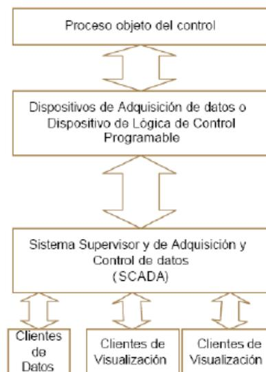
**Figura 14.-** Sistema estructural de un SCADA. Bloques en los que se detalla un sistema SCADA de un proceso automatizado.
