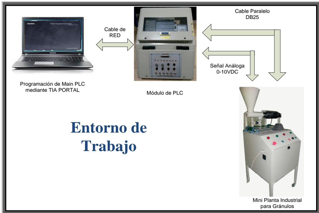
**Figura 57.-** Entorno de Trabajo. Entorno para trabajar con la mini planta industrial para gránulos.
