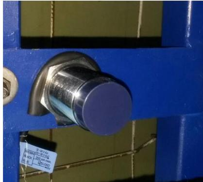
**Figura 55.-** Sensor capacitivo. Sensor capacitivo que detecta la presencia del recipiente para los gránulos.
