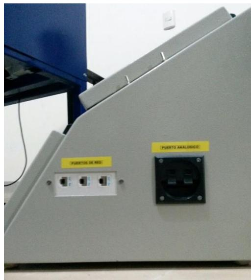
**Figura 46.-** Vista lateral del módulo de PLC. Puertos de red para la comunicación y borne de presión utilizados para la señal análoga del PLC.
