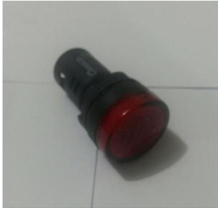
**Figura 36.-** Luz piloto rojo. Luz piloto marca Camsco.
