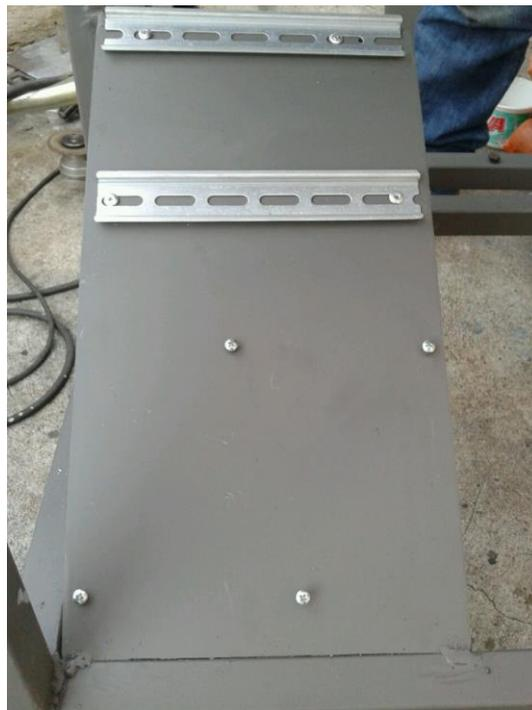
**Figura 26.-** Vista de plancha con rieles Din. Plancha con rieles para la instalación de elementos de fuerza de los motores trifásicos.
