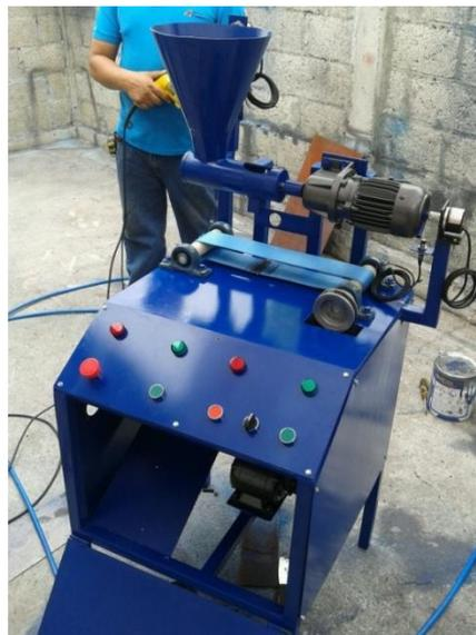
**Figura 28.-** Acabado de la estructura de mini planta para gránulos. Diseño final de la mini planta, se utilizó pintura sintética azul.
