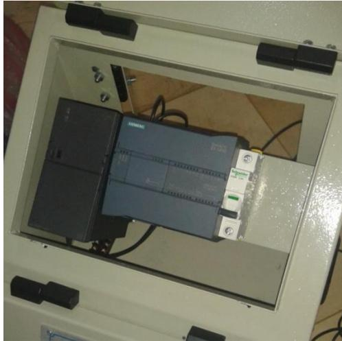
**Figura 43.-** Elementos instalados del módulo de PLC. Se instala fuente, PLC y breakers en la estructura.
