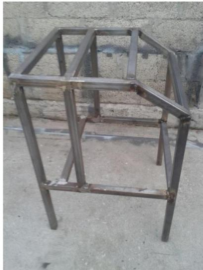
**Figura 24.-** Vista lateral del módulo de la mini planta industrial. Esqueleto armado con tubos cuadrados de 3x3 cm.
