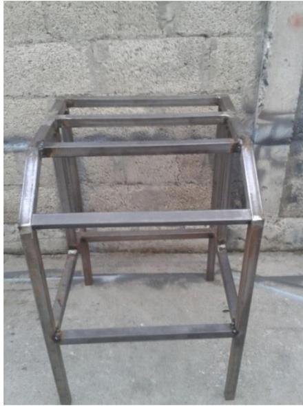
**Figura 23.-** Vista frontal del módulo de la mini planta industrial. Armado del esqueleto de la mini planta industrial.
