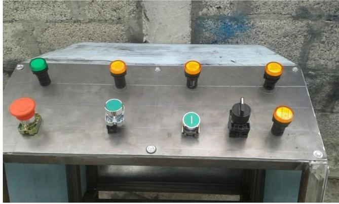
**Figura 25.-** Vista frontal de plancha para la mini planta industrial. Plancha para la instalación de las botoneras y luces piloto.
