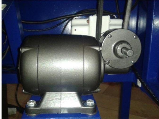
**Figura 50.-** Motor trifásico secundario. Motor para el movimiento de la banda transportadora.
