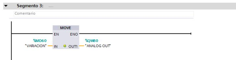
**Figura 89.-** Segmento 3-Main-Práctica#4.Programación de bloque MOVE para setear valores a la salida análoga QW80.
