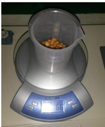
**Figura 131.-** Peso en gramos de muestra número 14. Toma de medida en gramos de una de las 25 muestras de la prueba del número de vueltas.
