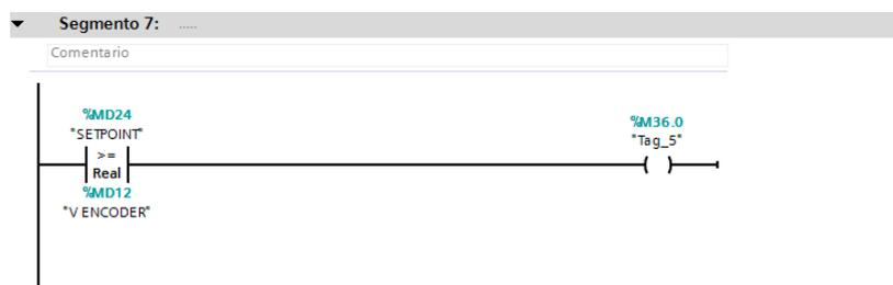
**Figura 124.-** Segmento 7-Main-Práctica#6. Comparación del setpoint y el valor de linealización del encoder.
