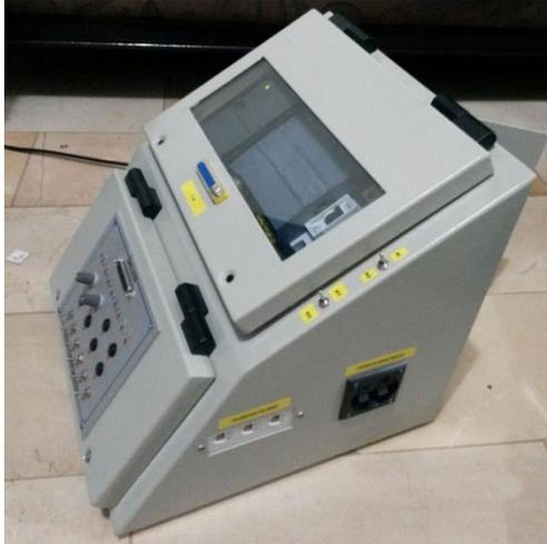
**Figura 47.-** Módulo de PLC. Módulo de PLC con sus diferentes elementos ya instalados.
