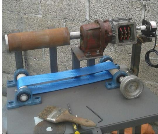
**Figura 27.-** Tornillo sin fin con acople del motor trifásico. Se visualiza la forma de instalación de tornillo sin fin junto con el motor trifásico y motoreductor. El encoder sensorará el número de revoluciones gracias al acople con el eje del motor trifásico.
