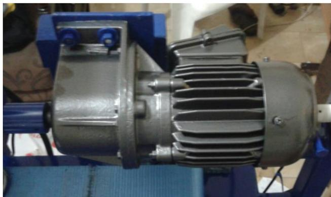
**Figura 49.-** Motor trifásico principal. Motor para el movimiento del tornillo sin fin.
