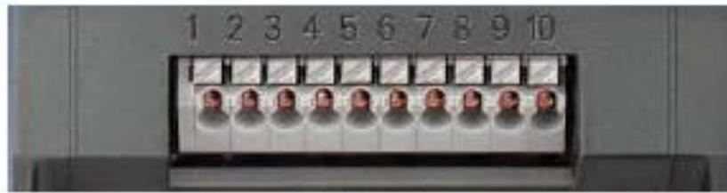
**Figura 53.-** Bornes del variador de frecuencia. Bornes físicos enumerados del 1 al 10 del variador de frecuencia Sinamics G110.
