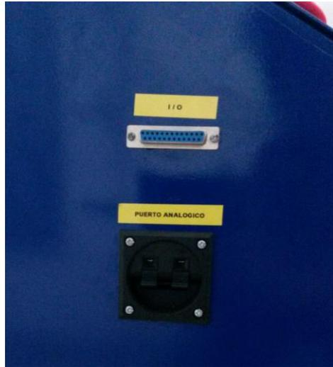
**Figura 39.-** Puerto DB25 y borne de presión de la mini planta. Estos conectores llevarán las señales digitales y la señal análoga del PLC para el funcionamiento del proceso.
