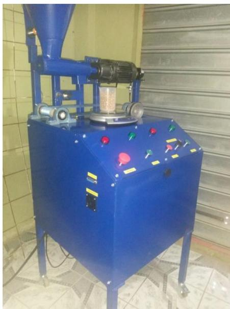
**Figura 40.-** Módulo de mini planta industrial. Imagen de módulo una vez realizada las conexiones de todos sus elementos.
