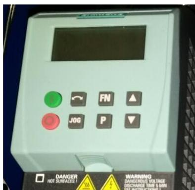
**Figura 51.-** B.O.P. Panel para la programación del variador de frecuencia.
