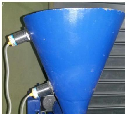
**Figura 56.-** Sensores capacitivos. Sensores capacitivos que detectan el nivel (alto y bajo) de los gránulos.
