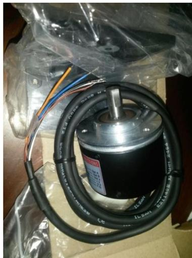
**Figura 54.-** Encoder Incremental. Encoder incremental marca Hanyoung Mux.
