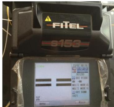
**Figura 7: Inicio de proceso de fusión de hilos de fibra.**
