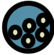
**Figura 19: Capacidad máxima final de un ducto**
