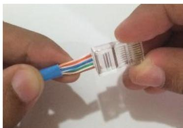
**Figura 6: Ingreso de cable UTP al RJ45.**
