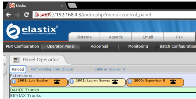
**Figura 5: Teléfono supervisor activo en central IP. (print screen)**
