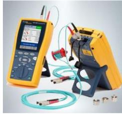
**Figura 11: Certificación de hilos de fibra.**
