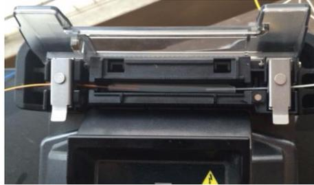
**Figura 9: Encogimiento de calor de hilos de fibra.**
