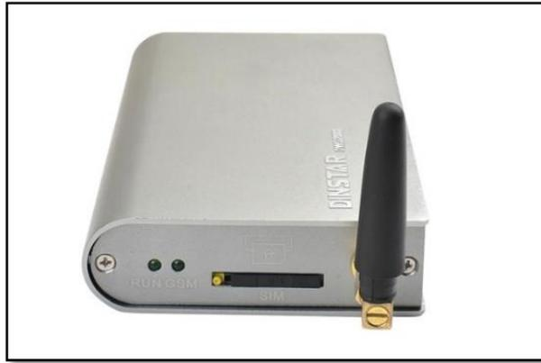
**Figura 2.25. Slot GSM e Indicadores**
