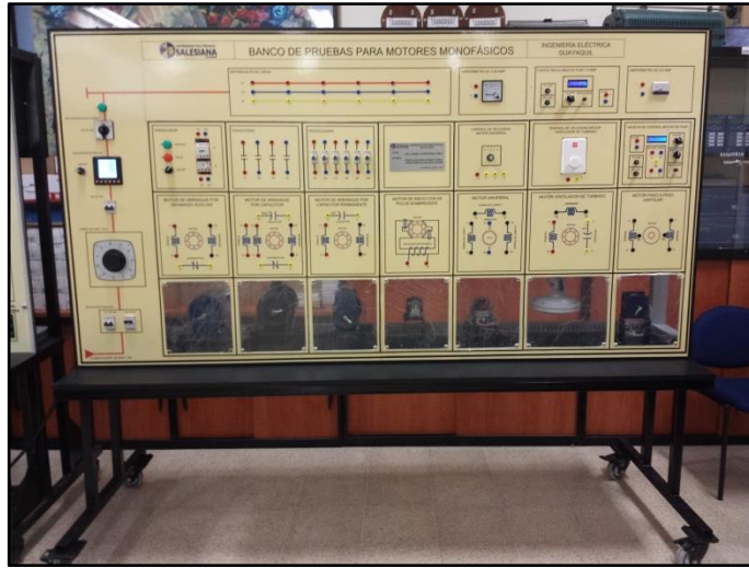
Figura 81: Banco de pruebas para motores monofásicos.
