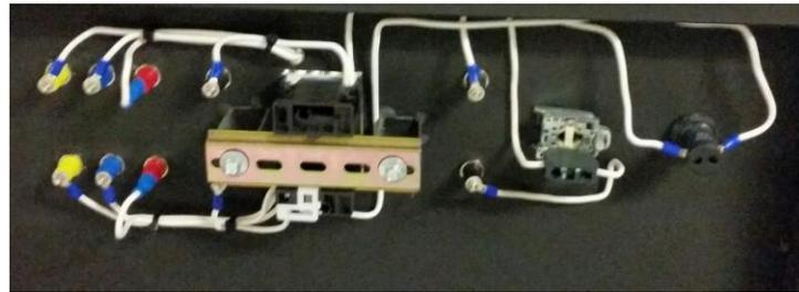
Fotografía 11. Cableado del contactor.
