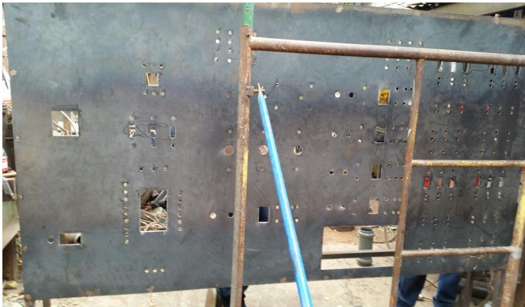
Fotografía 1. Lámina de acero perforada para la adecuación de los elementos.
