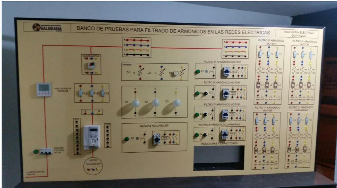
Fotografía 23. Banco de pruebas para filtrado de armónico en las redes eléctricas
