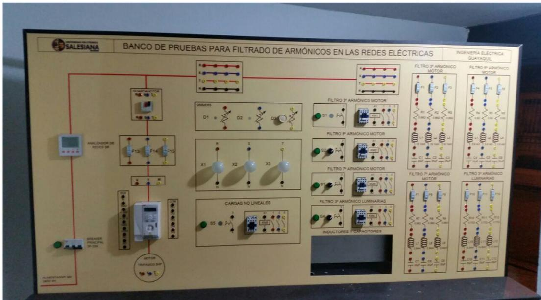
Fotografía 19. Banco de pruebas para filtrado de armónico en las redes eléctricas
