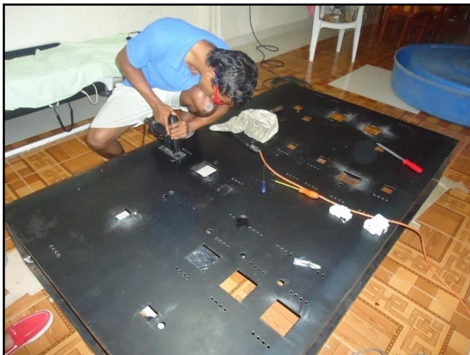
Figura 47. Calado en tablero
