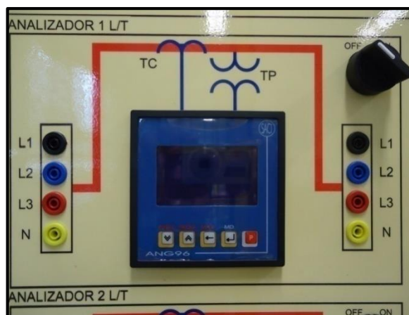
Figura 60. Medidor de energía.
