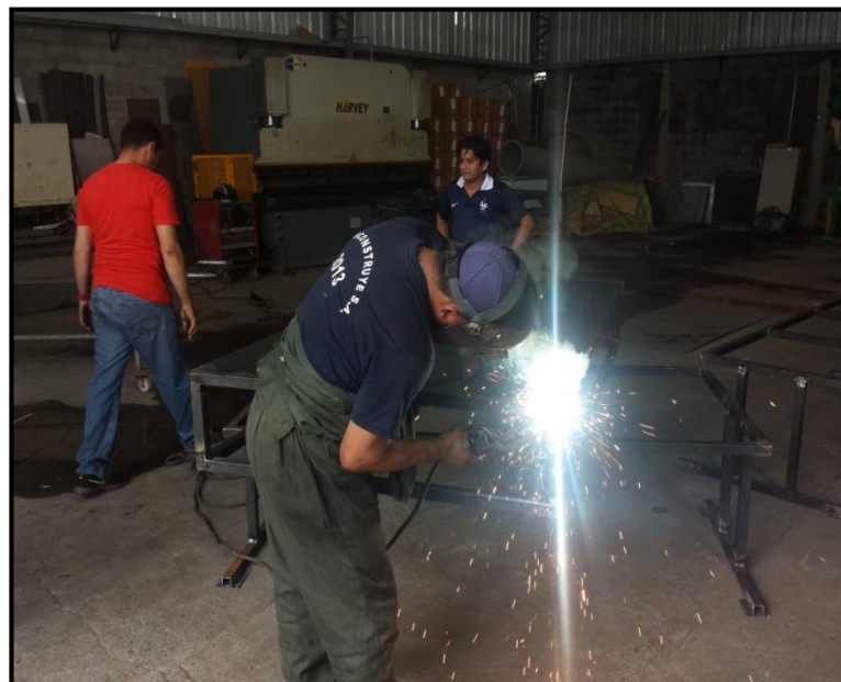
Figura 43. Construcción del tablero
